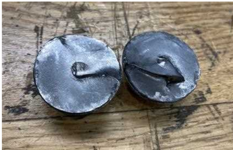
Figur 7: Kulor i kullagret har blivit utsatta för så pass stora lagerströmmar att de gått itu. Bilden är tagen på en av anläggningens maskiner.
