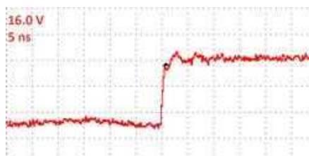
Figur 24: Vågform på detekterad skadlig urladdning på växellåda 2.
