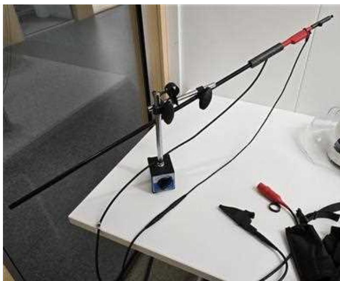
Figur 13: Spänningsprob med stativ, magnetbas och kolborste.
