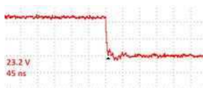
Figur 20: Vågform på detekterad skadlig urladdning på maskin 1.
