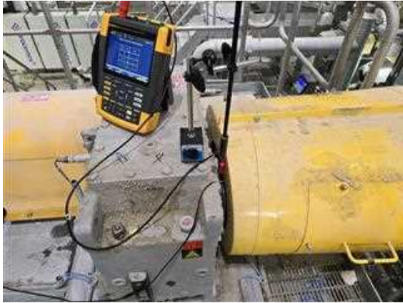
Figur 14: Mätupställning med MDA-550, där mätning utförs på en växellåda.
