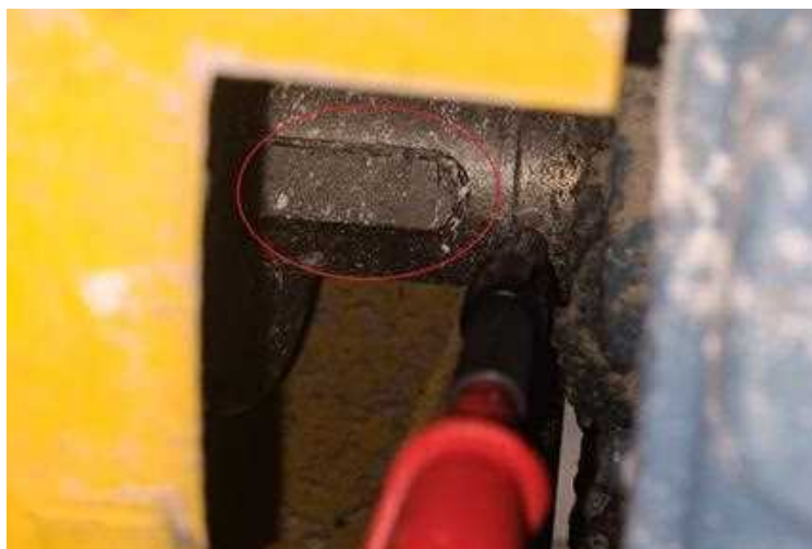
Figur 12: Kila inringad i rött som sitter på motoraxeln. Bredvid kilen är spänningsproben som används under mätningar.
