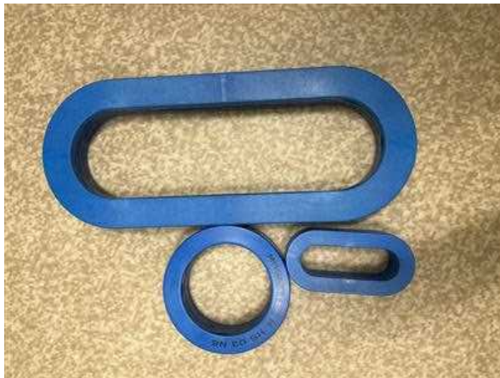
Figur 11: Bild på ferritringar som används i anläggningen.
