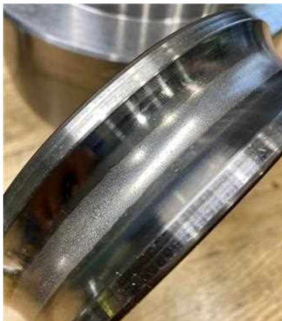
Figur 5: Exempel på lagerskada av typen frosting . Bilden är tagen från en av anläggningens maskiner.
