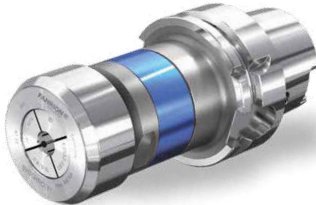
Das Gewindeschneidfutter SYNCHRO|T dient zum Ausgleich von Steigungsdifferenzen des Gewindeschneidwerkzeugs und der Synchronspindel sowie zum Ausgleich von Steigungstoleranzen des Gewindeschneidwerkzeugs. Es wirkt als Dämpfungsglied zwischen Werkzeug und Spindel beim synchronisierten Gewindeschneiden (Rigid Tapping) auf Bearbeitungszentren mit Synchronspindeln.
