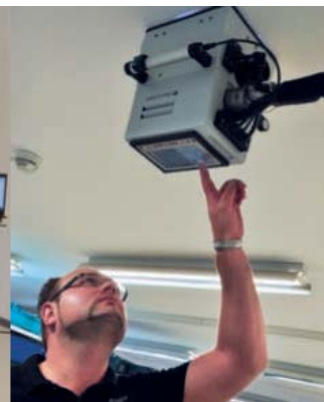
safeBOX-skyddshuven suger sig fast på komponentytan
