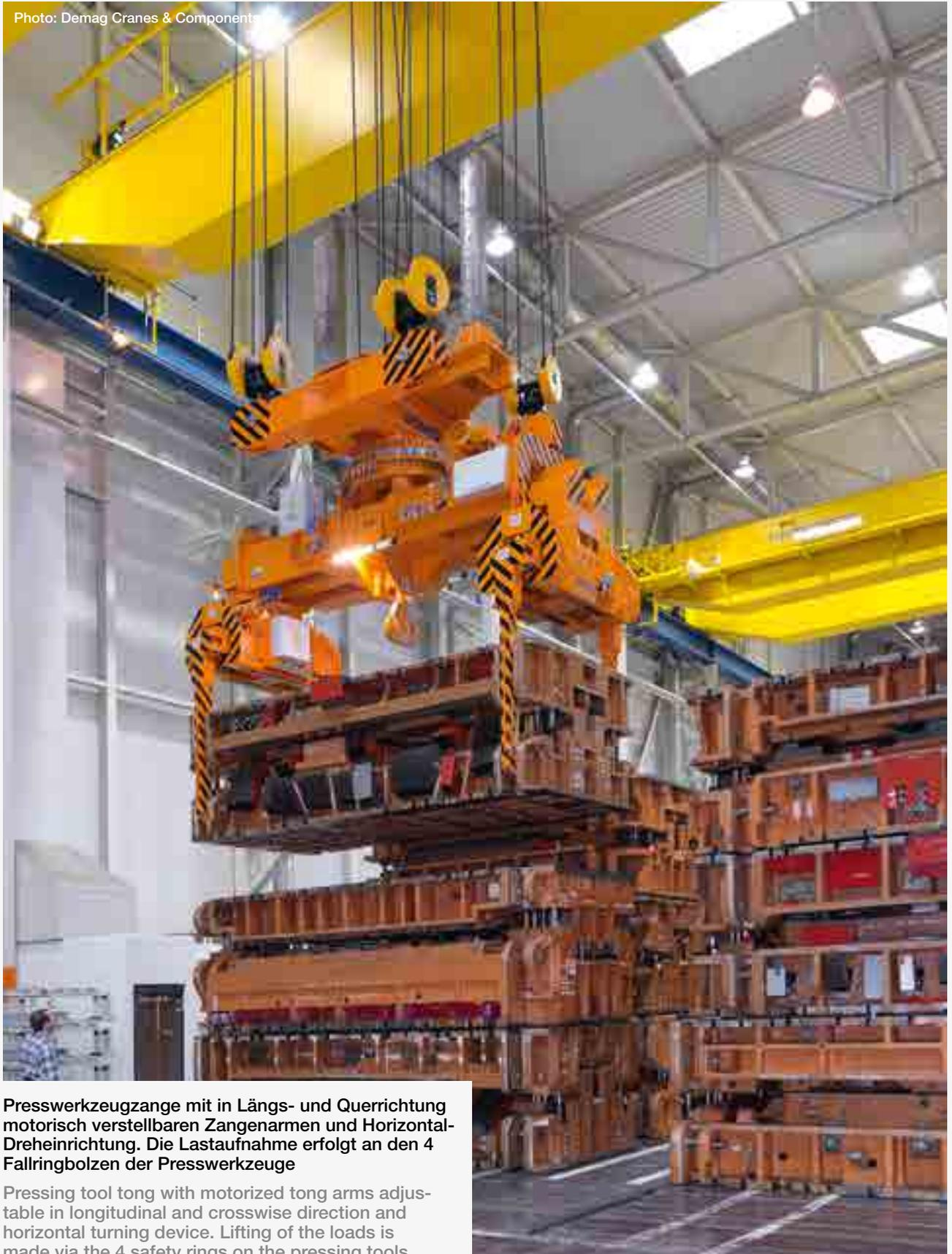
Presswerkzeugzange mit in Längs- und Querrichtung motorisch verstellbaren Zangenarmen und Horizontal-Dreheinrichtung. Die Lastaufnahme erfolgt an den 4 Fallringbolzen der Presswerkzeuge
