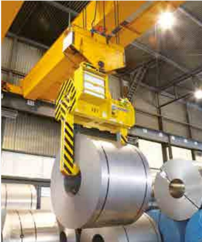
Teleskop-Coilzange mit Spindeltrieb für sicheren und rationellen Materialfluss. Selbsthemmende Trapezgewindespindeln verhindern auch bei Fehlbedienung (z.B. bei Schrägstellung der Zange durch einseitiges Aufsetzen) ein Öffnen der Zangenarme unter Last. Robuster Spindeltrieb aufgrund spezieller Lagerung
