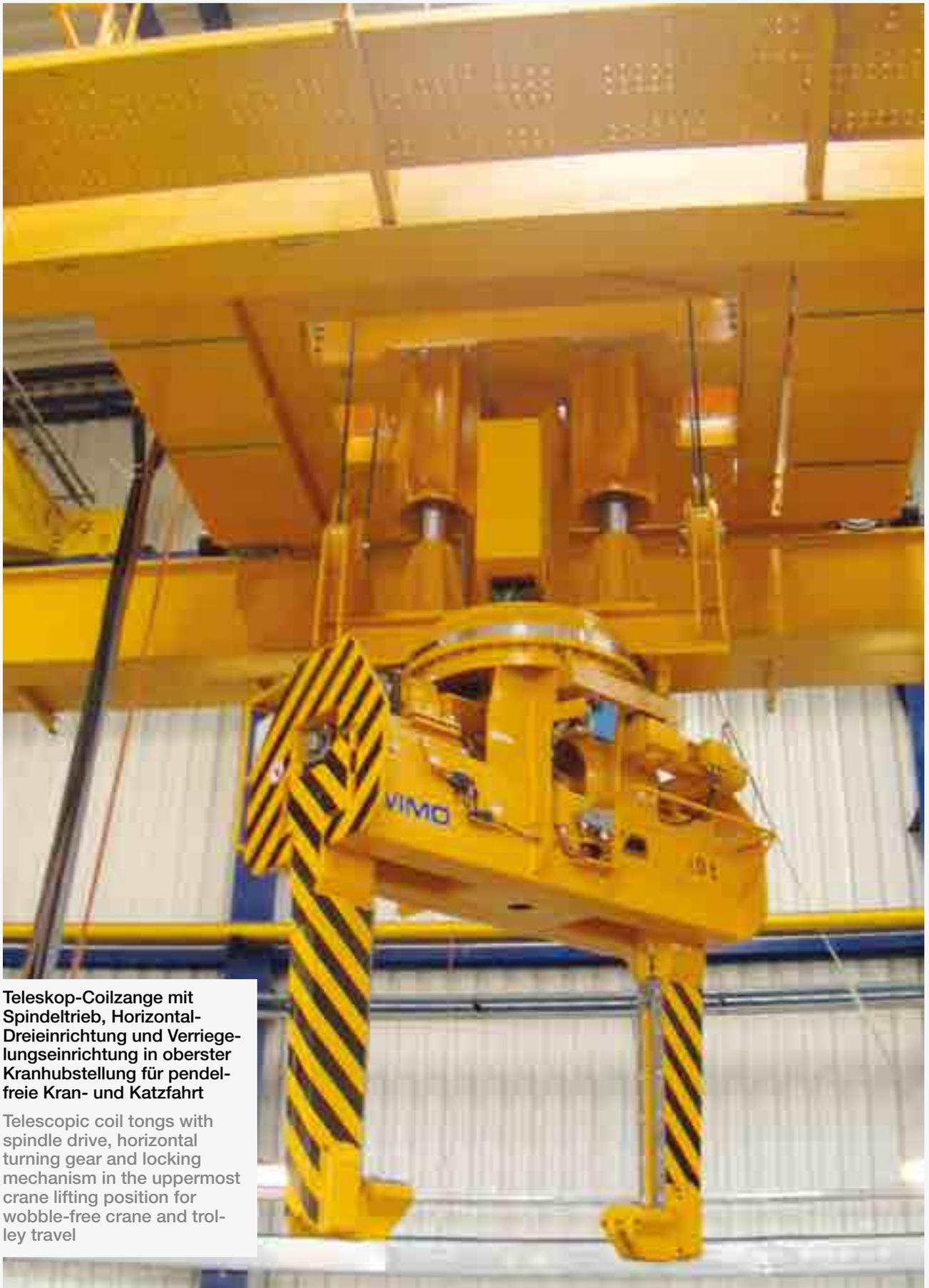
**Teleskop-Coilzange mit Spindeltrieb, Horizontal-Dreieinrichtung und Verriegelungseinrichtung in oberster Kranhubstellung für pendelfreie Kran- und Katzfahrt**
