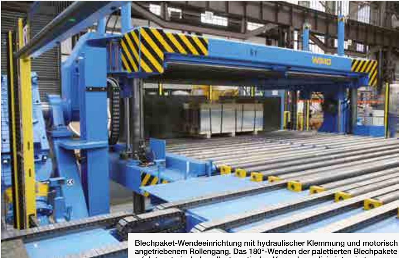
Blechpaket-Wendeinrichtung mit hydraulischer Klemmung und motorischem angetriebenem Rollengang. Das 180°-Wenden der palettierten Blechpakete erfolgt motorisch. In vollautomatischer Verpackungslinie integriert
