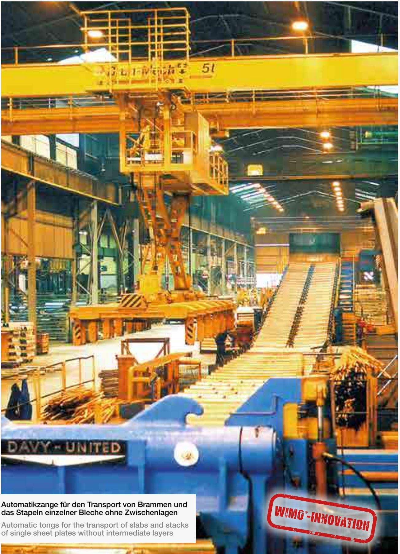
Automatikzange für den Transport von Brammen und das Stapeln einzelner Bleche ohne Zwischenlagen
