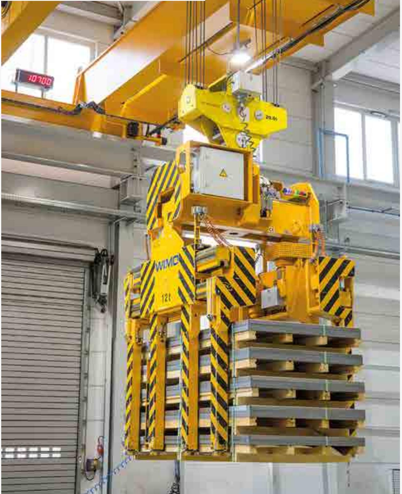
**Blechpaketzange motorisch angetrieben, mit insgesamt 8 von Hand längsseitig verstellbaren Aufnahmepratzen. Die 4 äußeren Aufnahmepratzen werden teleskopartig verschoben.**
