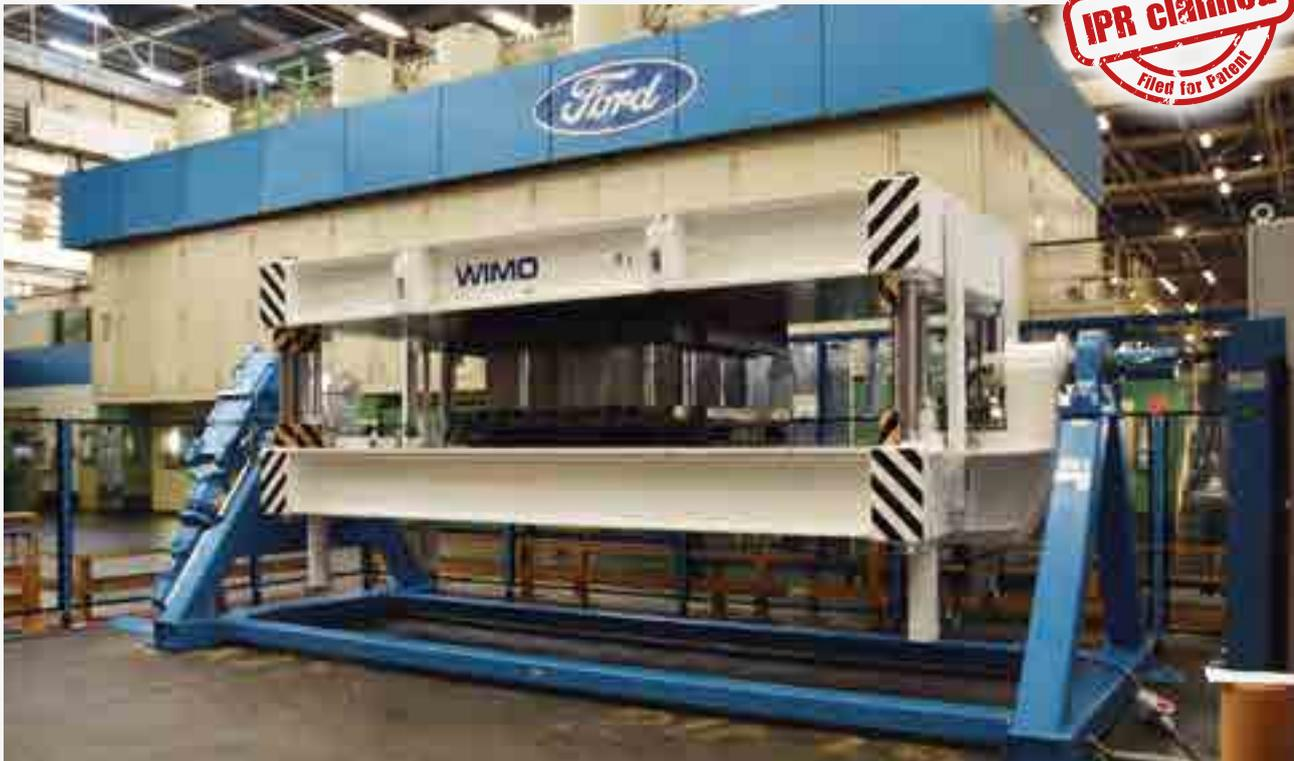
Wendeeinrichtung für automatisches 180°-Wenden palettierter, nicht abgebundener Platinenstapel. Mittels zum Patent angemeldeter WIMO®-Spezialrungen können auch mehrere Platinenstapel gleichzeitig gewendet werden. Einfache Bedienung durch automatische Kontrollen und Einstellungen. Beladung mittels Stapler. Die Beschickung und Entladung des Wenders wird jeweils an seiner Vorderseite durchgeführt. Die Klemmung der palettierten Platinenstapel erfolgt hydraulisch, das Wenden motorisch
