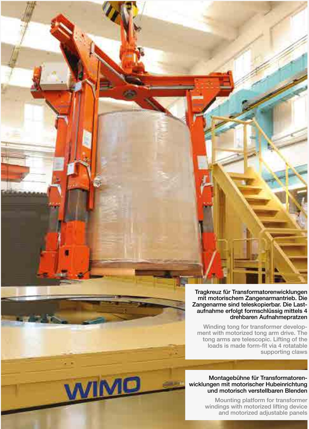
**Tragkreuz für Transformatorenwicklungen mit motorischem Zangenarmantrieb. Die Zangenarme sind teleskopierbar. Die Lastaufnahme erfolgt formschlüssig mittels 4 drehbaren Aufnahmepratzen**
