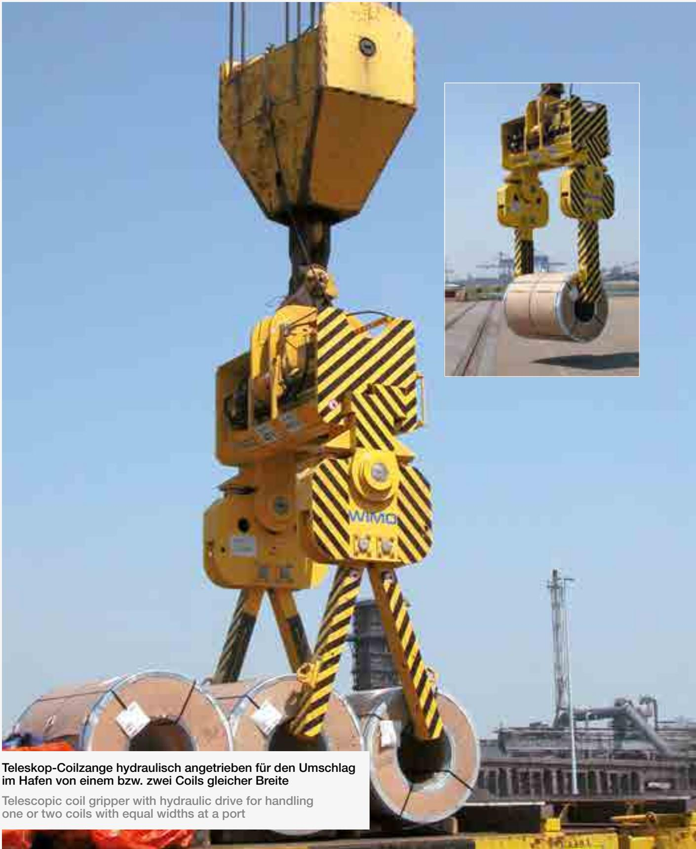
**Teleskop-Coilzange hydraulisch angetrieben für den Umschlag im Hafen von einem bzw. zwei Coils gleicher Breite**
