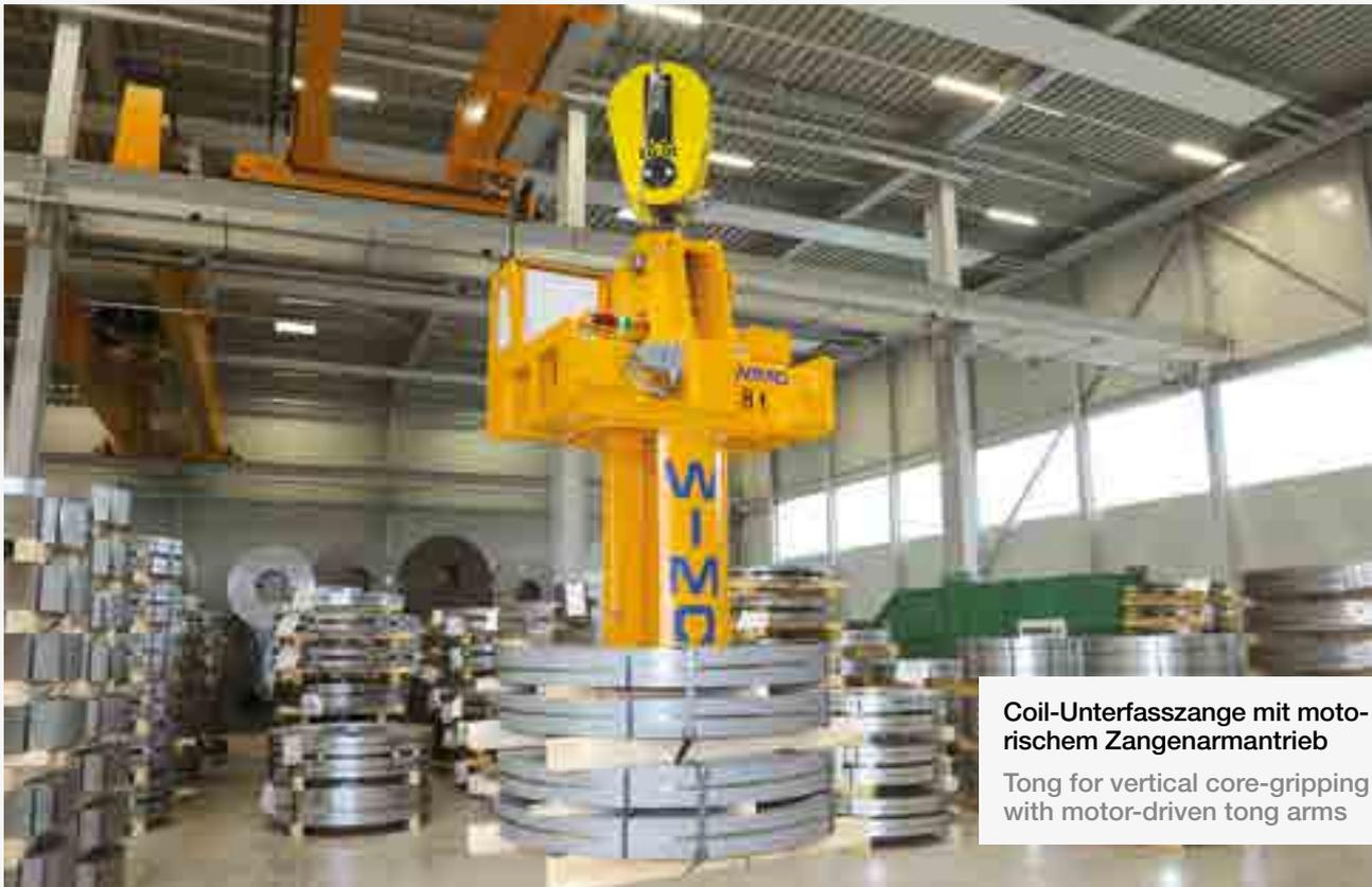
Coil-Unterfasszange mit motorischem Zangenantrieb
