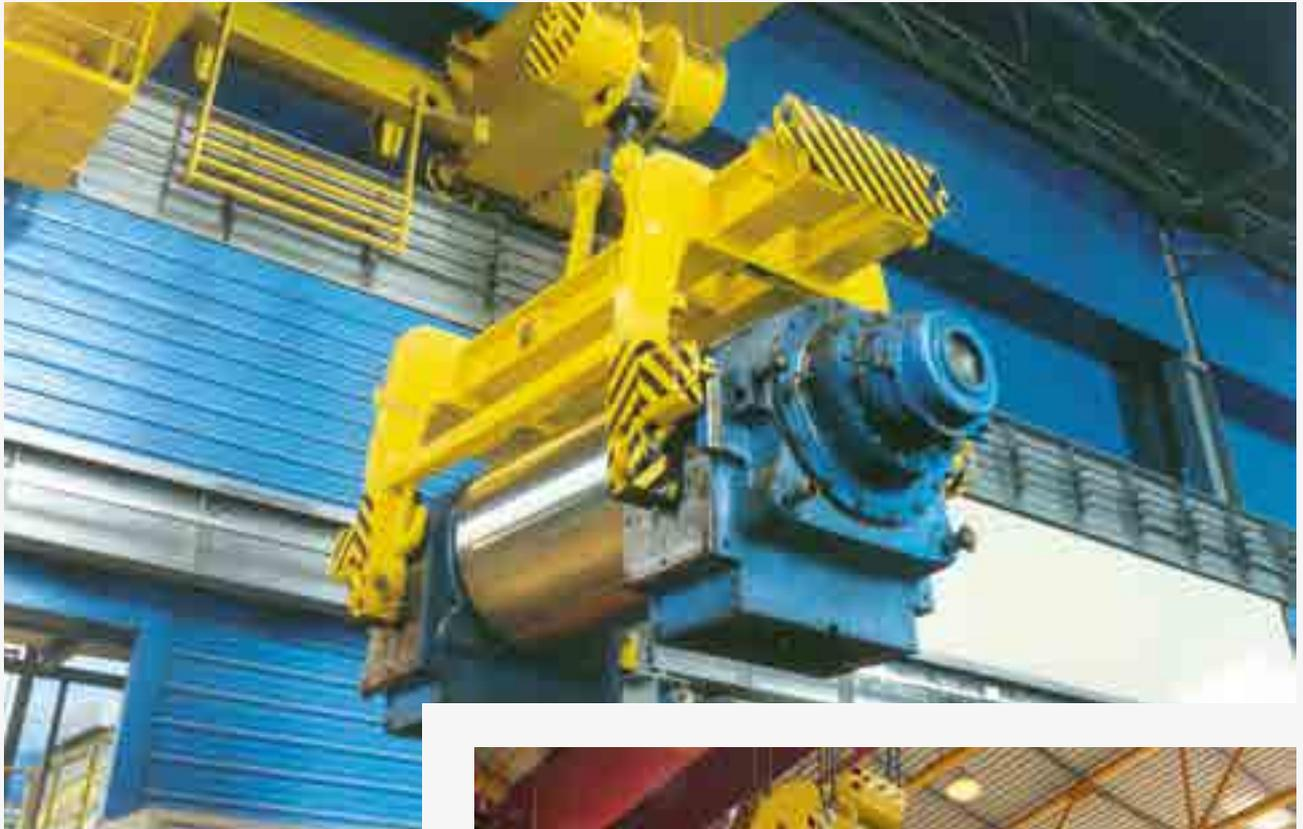
Traverse für den Transport von Stützwalzen. Das Ein- und Ausklappen der vier Aufnahmepratzen erfolgt jeweils selbsttätig ohne manuelle Hilfe
