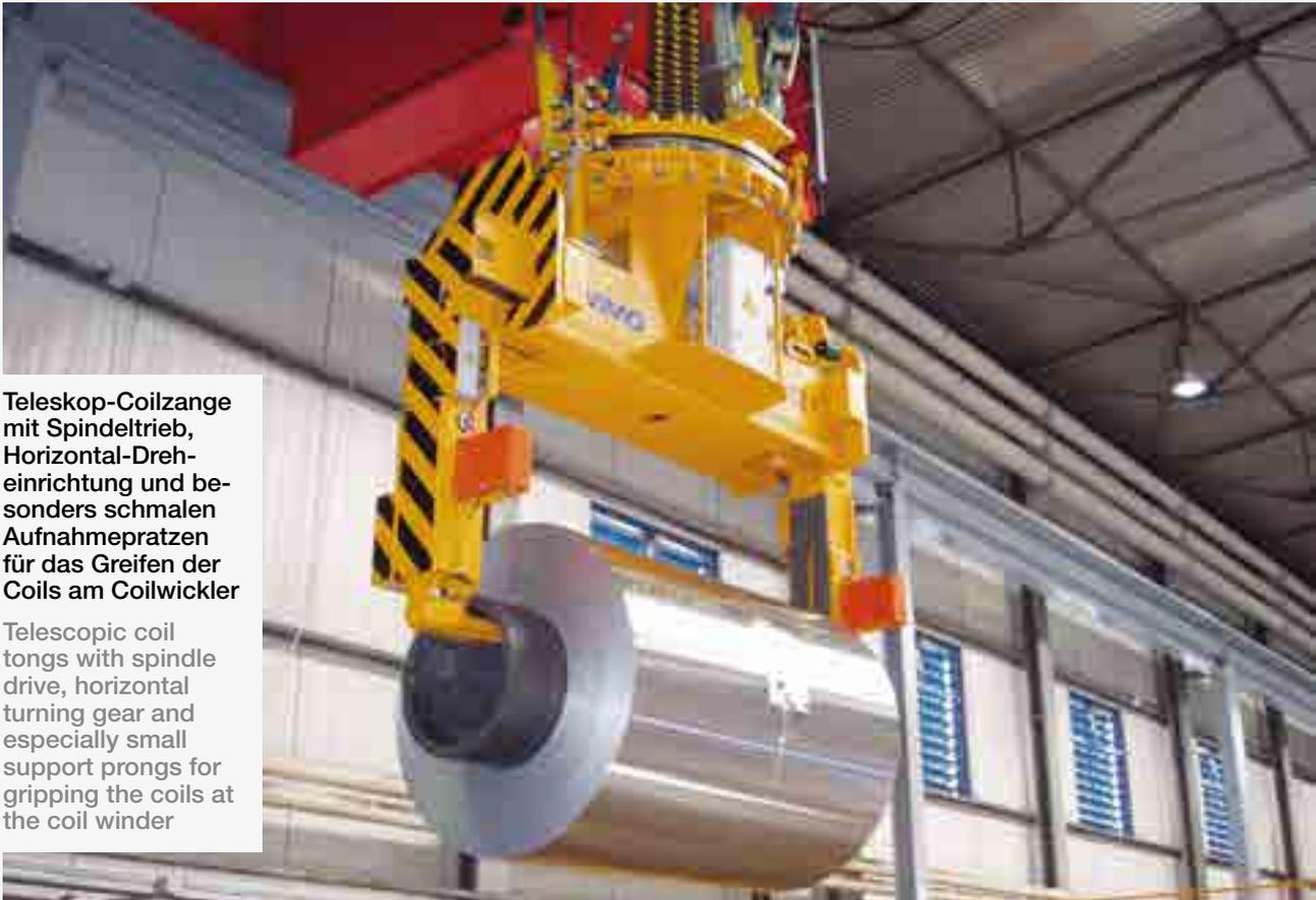
**Teleskop-Coilzange mit Spindeltrieb, Horizontal-Dreh-einrichtung und besonders schmalen Aufnahmepratzen für das Greifen der Coils am Coilwickler**
