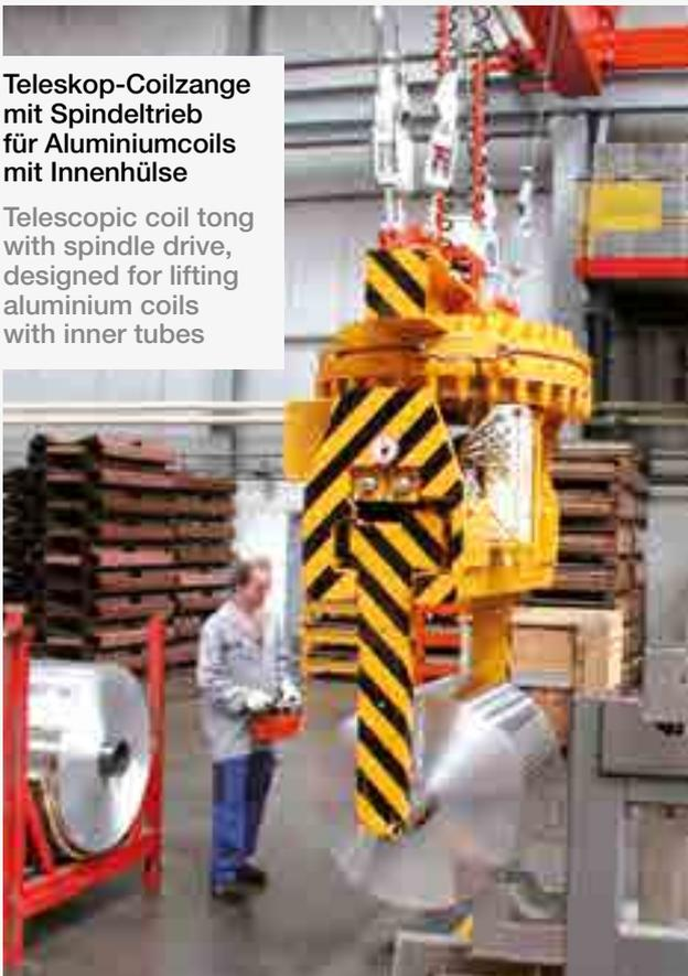
**Teleskop-Coilzange mit Spindeltrieb für Aluminiumcoils mit Innenhülse**
