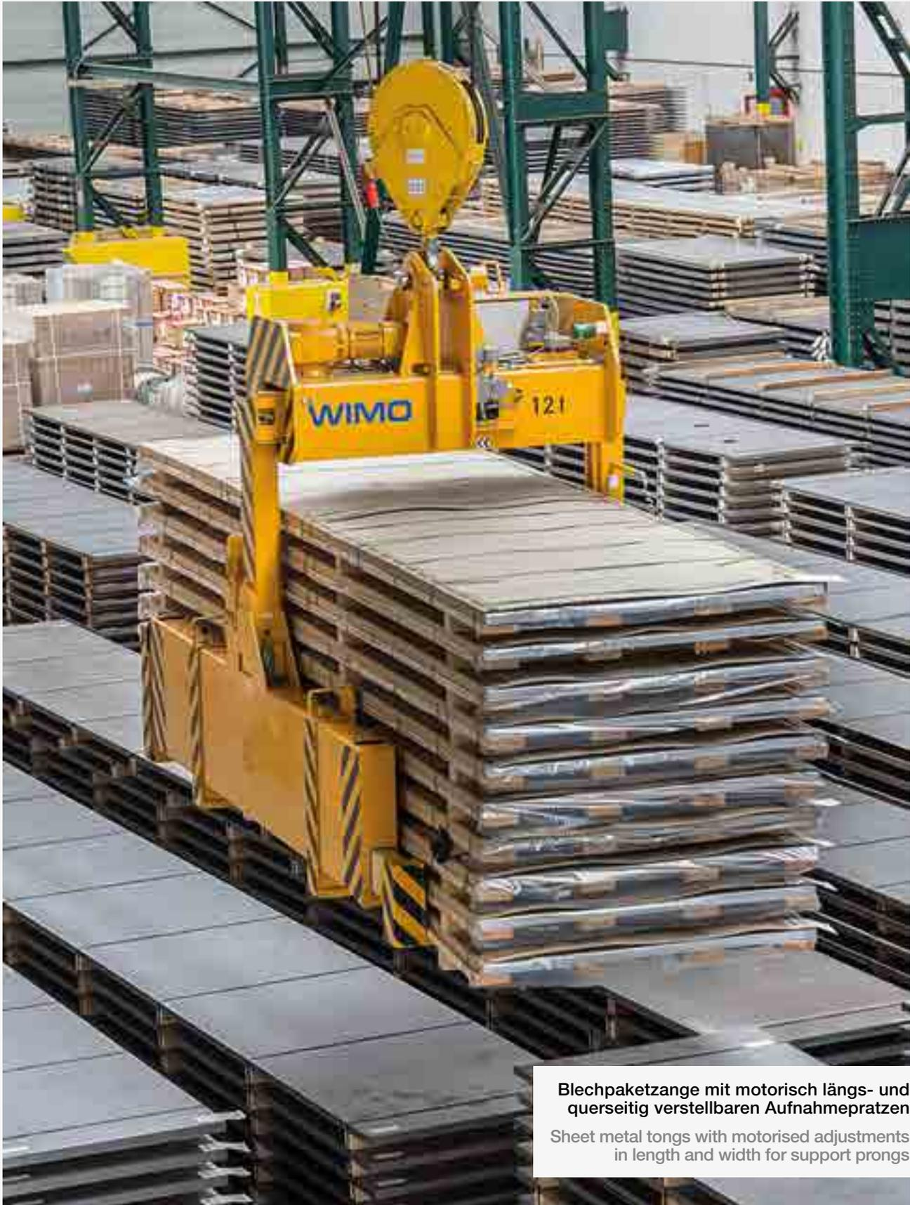
**Blechpaketzange mit motorisch längs- und querseitig verstellbaren Aufnahmepratzen**
