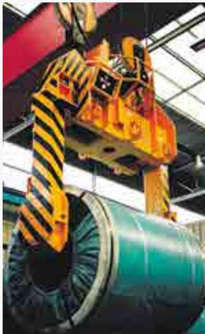
**Teleskop-Coilzange mit Hydraulikantrieb und klappbaren Aufnahmepratzen**
