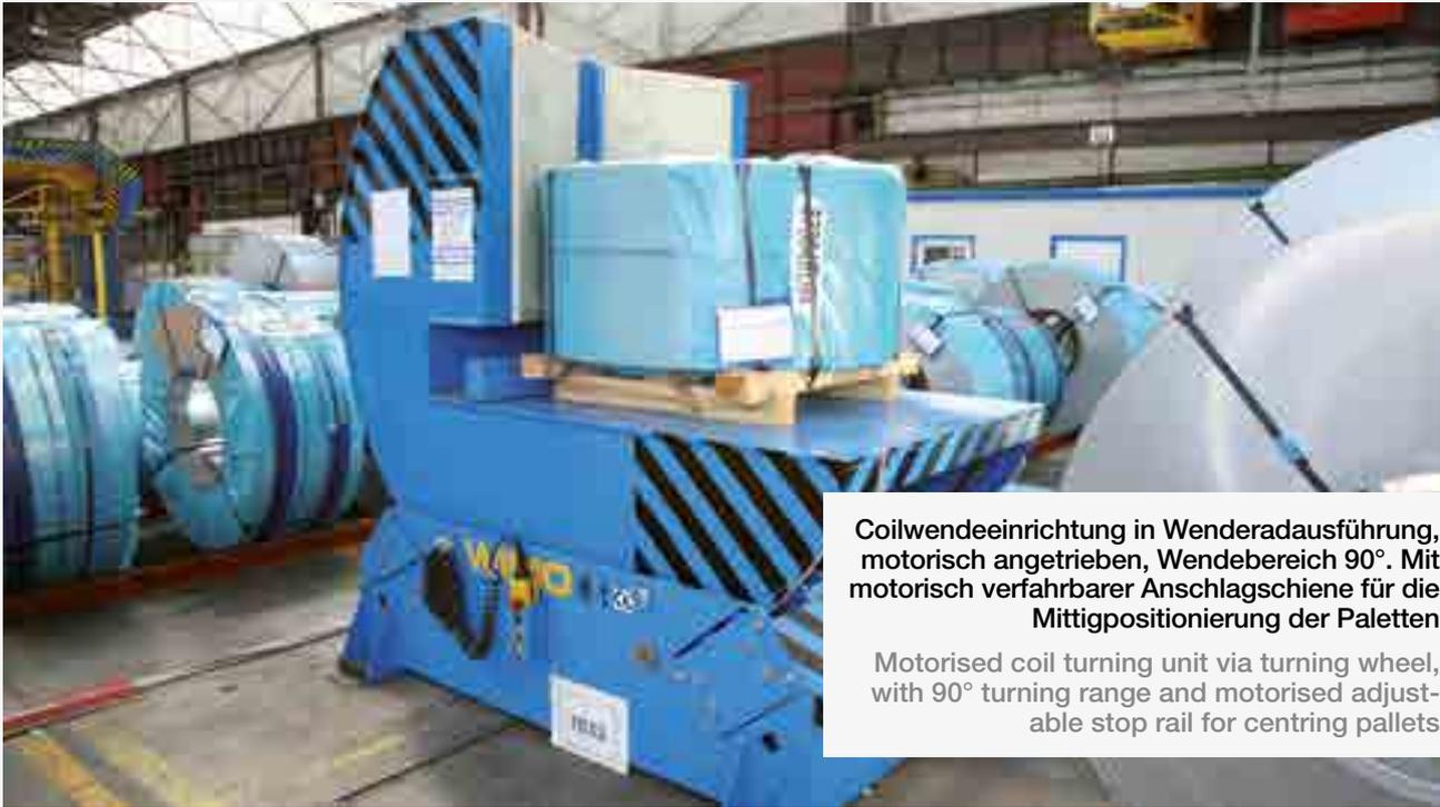
Coilwendeeinrichtung in Wenderadausführung, motorisch angetrieben, Wendebereich 90°. Mit motorisch verfahrbarer Anschlagsschiene für die Mittigpositionierung der Paletten
