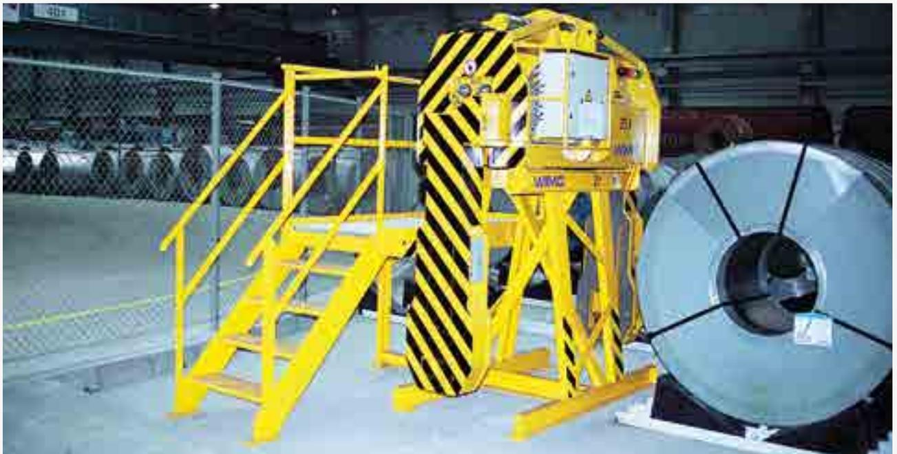
Abstellbock mit Treppe und Wartungsbühne. Geeignet für sicheres und bequemes Erreichen der mechanischen und elektrischen Schnittstellen beim Zangenwechsel. Wesentliche Erleichterung bei Wartungsarbeiten
