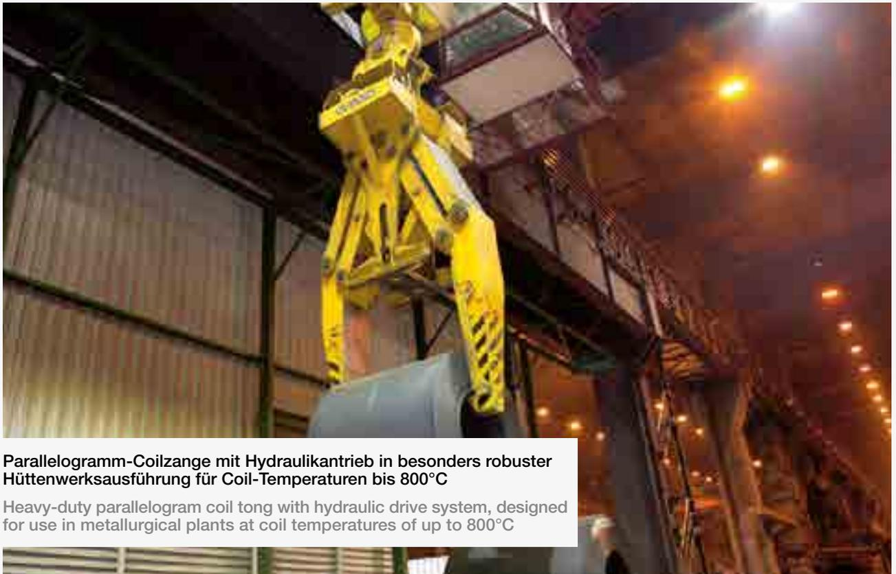
**Parallelogramm-Coilzange mit Hydraulikantrieb in besonders robuster Hüttenwerksausführung für Coil-Temperaturen bis 800°C**
