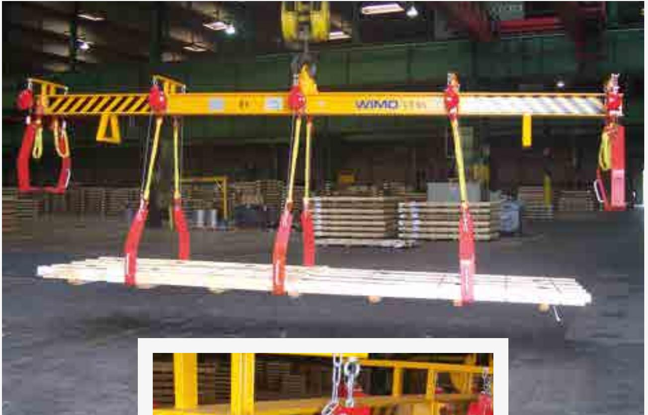
Traverse mit an Federzügen aufgehängten Plattenhaken, die mittels Handgriffen mühelos an das Blechpaket angelegt werden und haften bleiben
