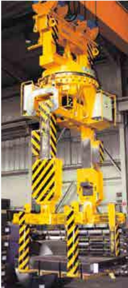
Anbaugerät für den Transport palettierter Coils und Blechpakete. Ideal bei gelegentlichem Wechsel der Transportaufgabe. Ausgelegt für schnelles und sicheres Anschlagen, kein zeitraubender Wechsel des Lastaufnahme-mittels
