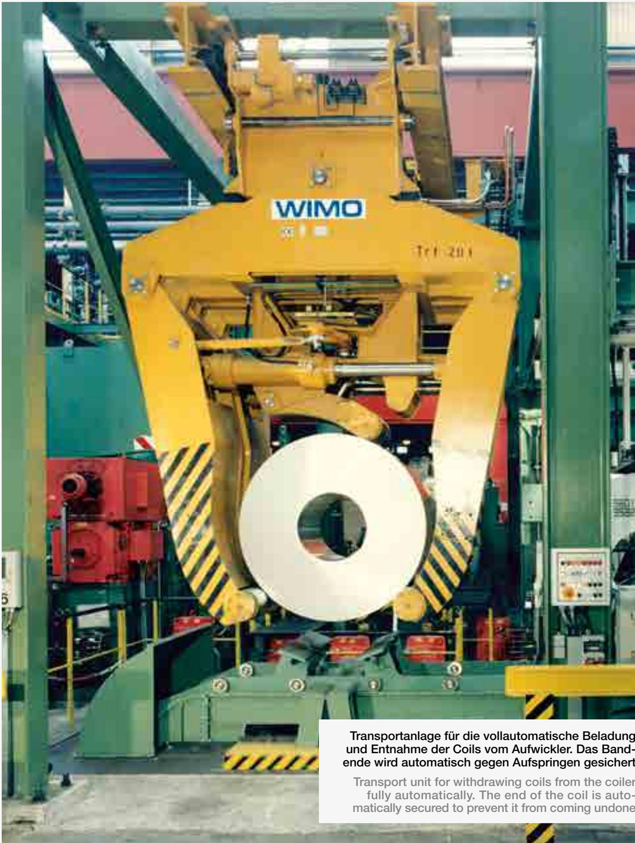
Transportanlage für die vollautomatische Beladung und Entnahme der Coils vom Aufwickler. Das Bandende wird automatisch gegen Aufspringen gesichert
