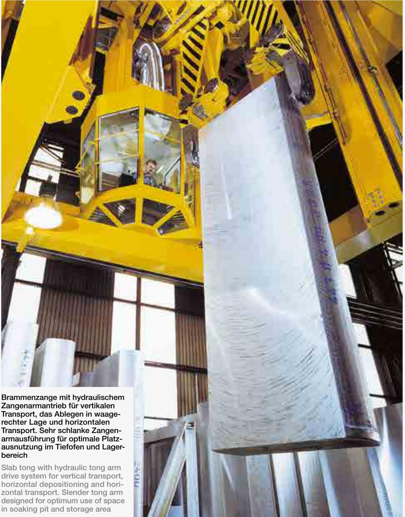
Brammenzange mit hydraulischem Zangenantrieb für vertikalen Transport, das Ablegen in waagerechter Lage und horizontalen Transport. Sehr schlanke Zangenarmausführung für optimale Platzausnutzung im Tiefofen und Lagerbereich
