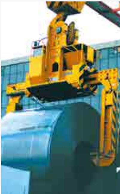
**Teleskop-Coilzange mit Zahnstangeantrieb**
