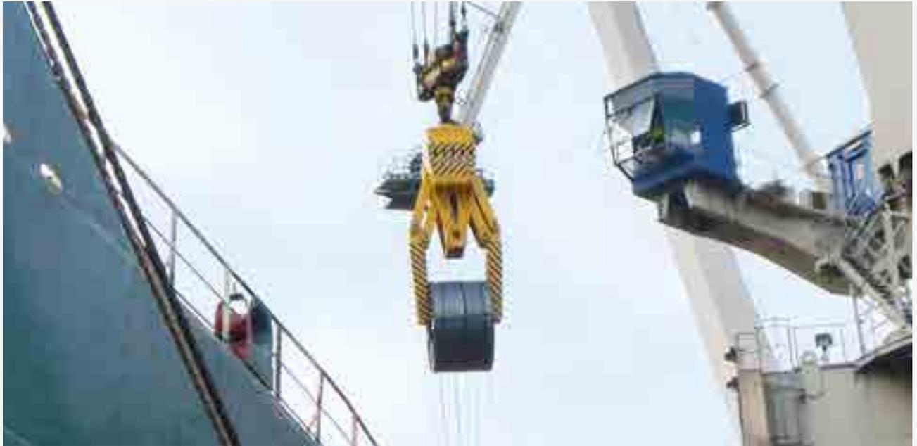
**Parallelogramm-Coilzange, hydraulisch angetrieben, mit Zusatzeinrichtungen für schonenden Materialumschlag im Hafenbetrieb**
