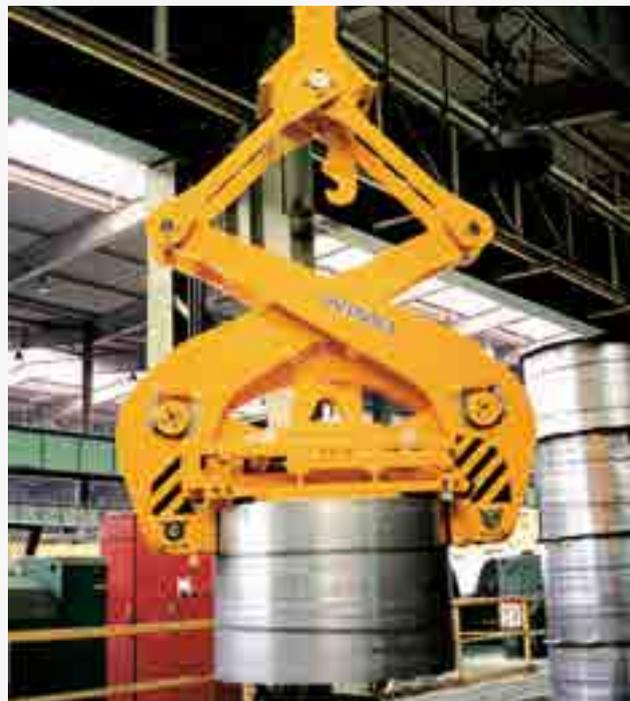
Vertikal-Coilzange in mechanischer Ausführung mit doppelseitiger Lastaufnahme
