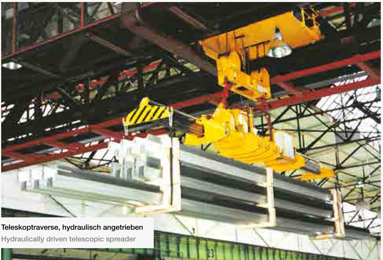
**Teleskoptraverse, hydraulisch angetrieben**
