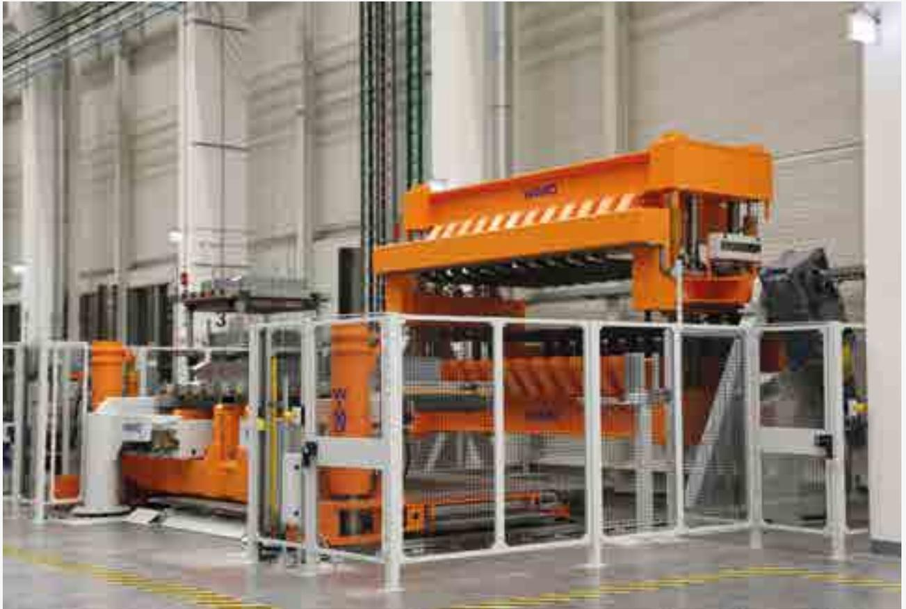
Wendeeinrichtung mit Beladewagen für automatisches 180°-Wenden von Platinenstapel ohne Palette (geliefert an Audi Hungaria Motor Kft.).
