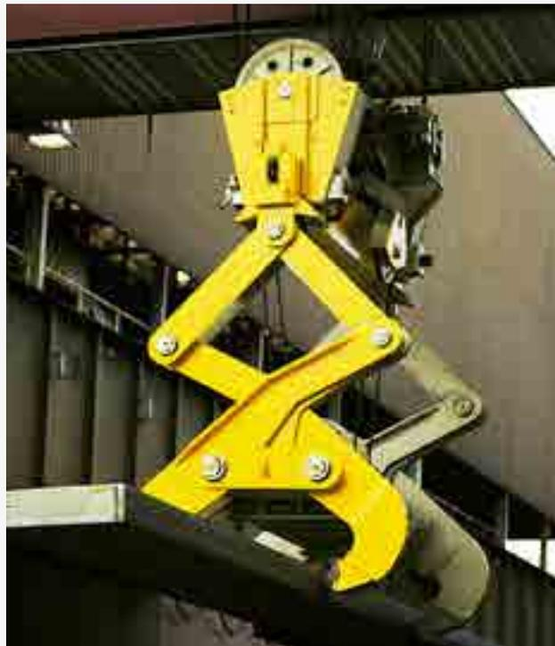
**Doppelbrammenzange in mechanischer Scherenbauweise mit motorischer Greifweitereinstellung**
