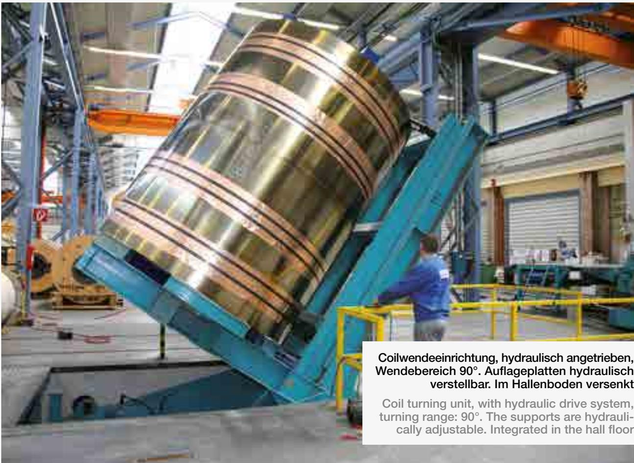
Coilwendeeinrichtung, hydraulisch angetrieben, Wendebereich 90°. Auflageplatten hydraulisch verstellbar. Im Hallenboden versenkt
