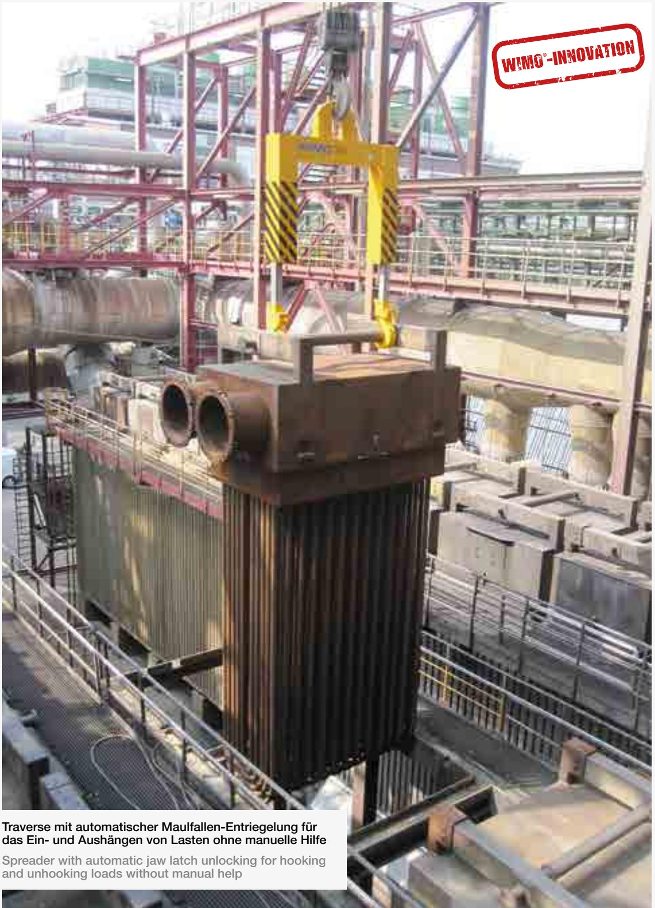
Traverse mit automatischer Maulfallen-Entriegelung für das Ein- und Aushängen von Lasten ohne manuelle Hilfe
