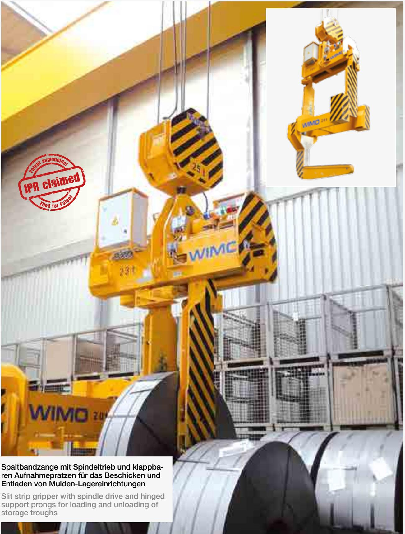
Spaltbandzange mit Spindeltrieb und klappbaren Aufnahmepatrzen für das Beschicken und Entladen von Mulden-Lagereinrichtungen
