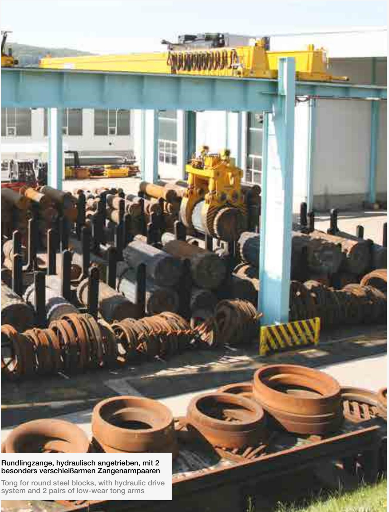
**Rundlingzange, hydraulisch angetrieben, mit 2 besonders verschleißarmen Zangenarmpaaren**
