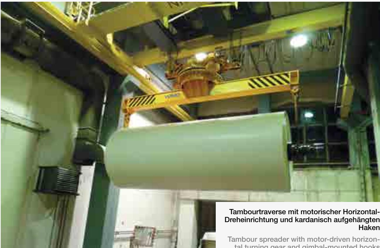
Tambourtraverse mit motorischer Horizontal-Dreheinrichtung und kardanisch aufgehängten Haken
