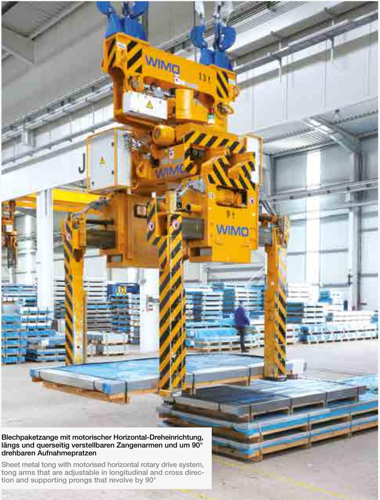
**Blechpaketzange mit motorischer Horizontal-Dreheinrichtung, längs und querseitig verstellbaren Zangenarmen und um 90° drehbaren Aufnahmepratzen**
