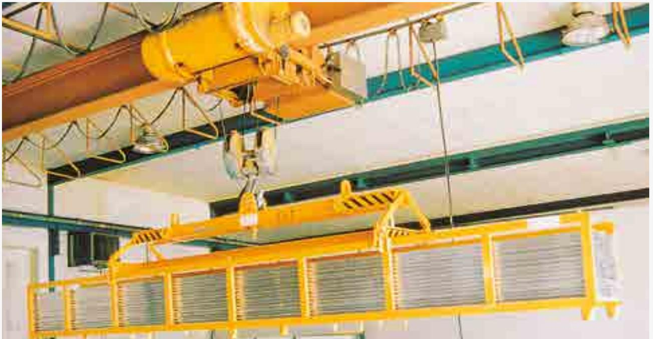
**Langgutzange in mechanischer Ausführung
