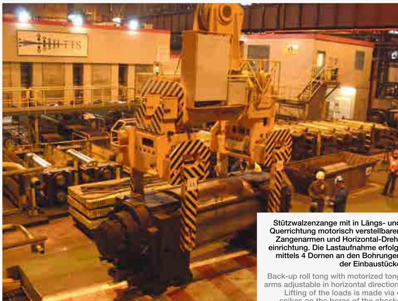
Stützwalzenzange mit in Längs- und Querrichtung motorisch verstellbaren Zangenarmen und Horizontal-Dreh-einrichtung. Die Lastaufnahme erfolgt mittels 4 Dornen an den Bohrungen der Einbaustücke
