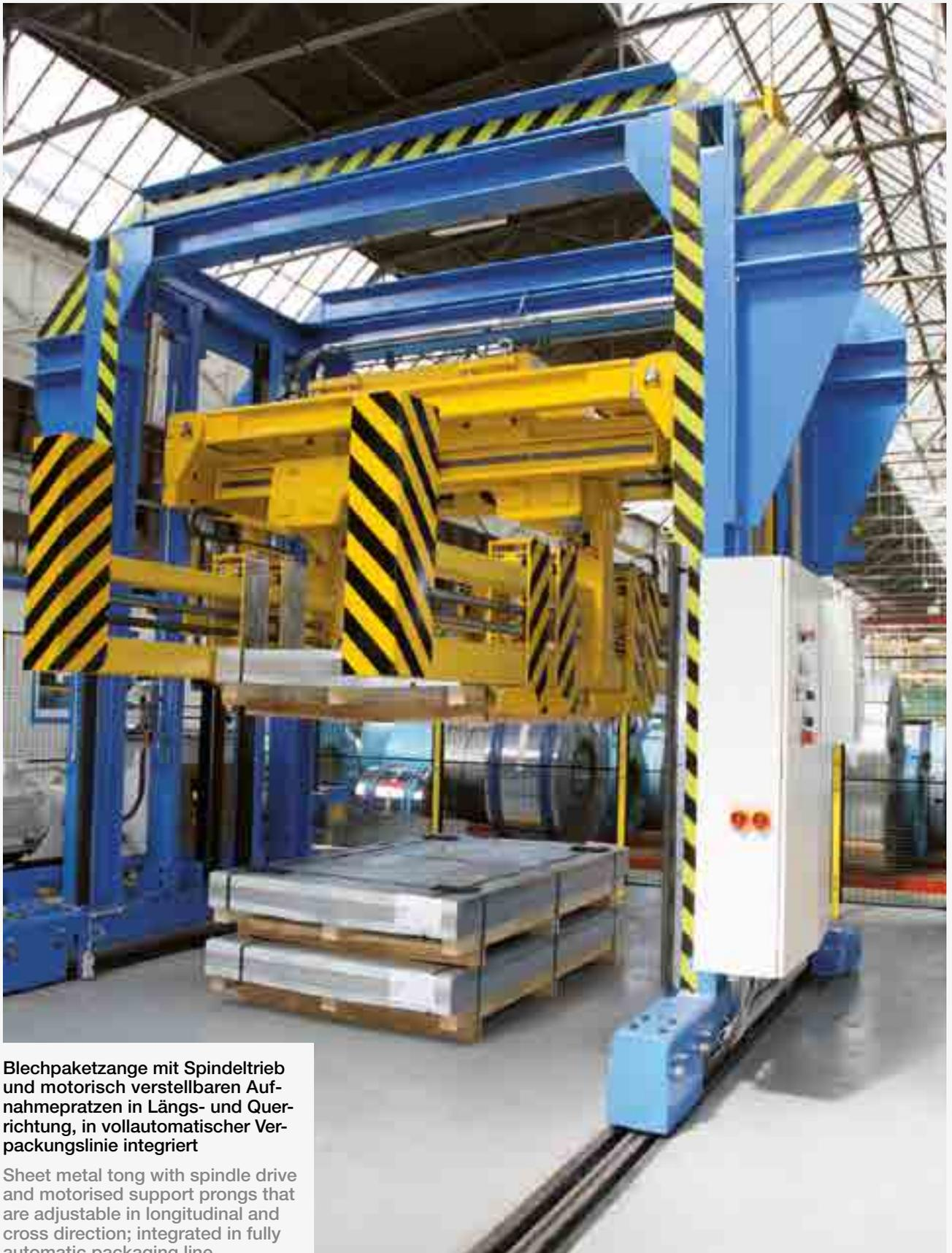
**Blechpaketzange mit Spindeltrieb und motorisch verstellbaren Aufnahmepratzen in Längs- und Querichtung, in vollautomatischer Verpackungslinie integriert**
