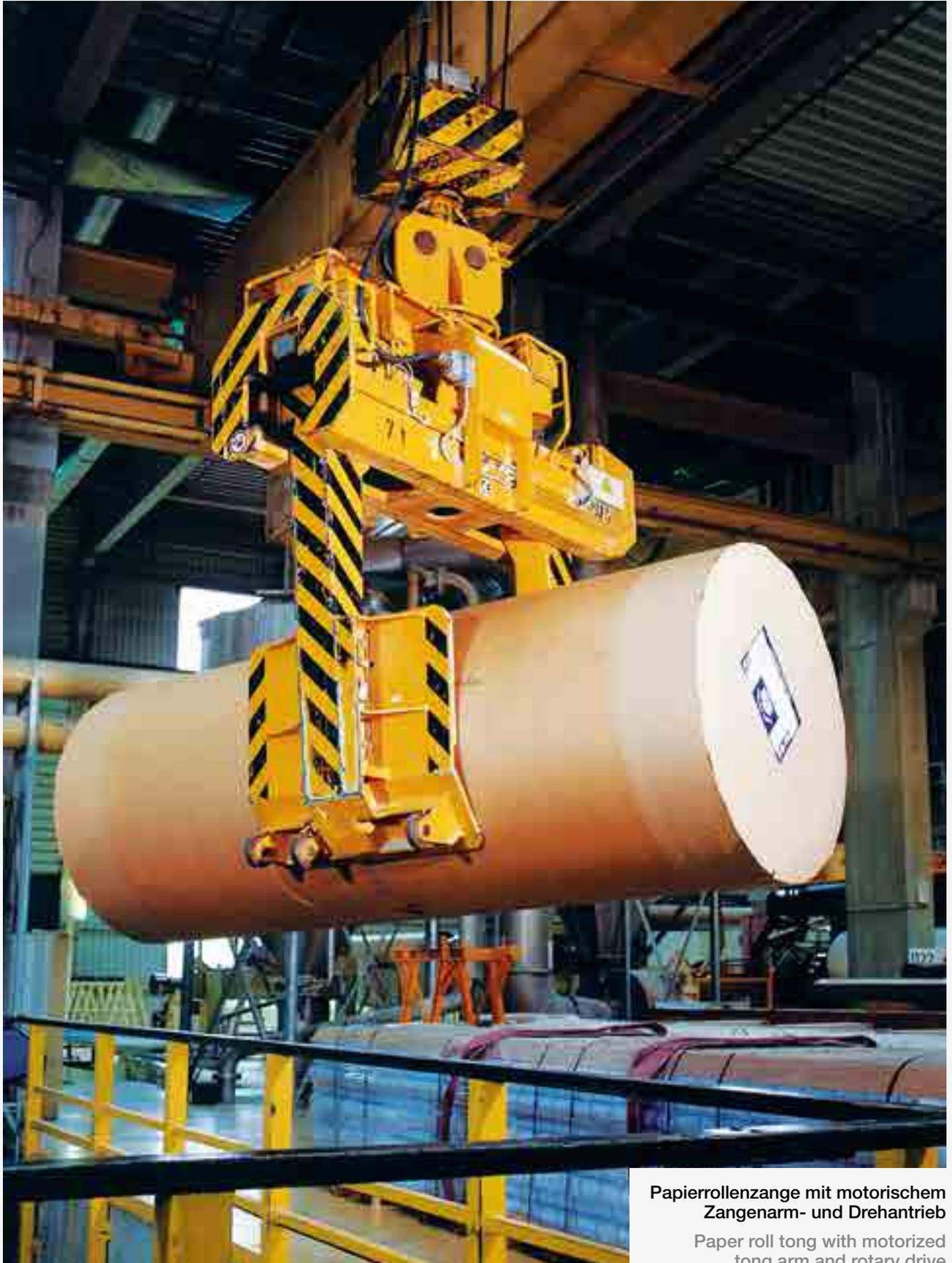
Papierrollenzange mit motorischem Zangenarm- und Drehantrieb
