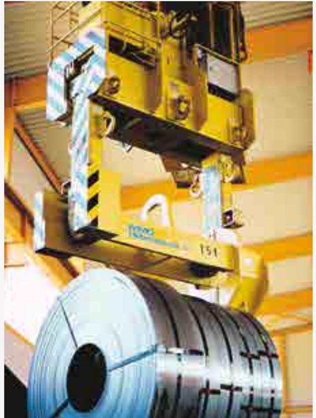
Coilhook mit Aufhängeadapter zur Aufnahme mit einer Coiltzange
