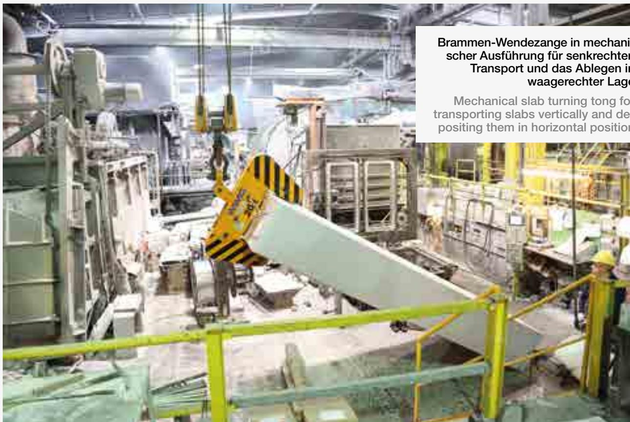
**Brammen-Wendezange in mechanischer Ausführung für senkrechten Transport und das Ablegen in waagerechter Lage**
