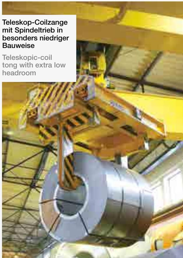
**Teleskop-Coilzange mit Spindeltrieb in besonders niedriger Bauweise**
