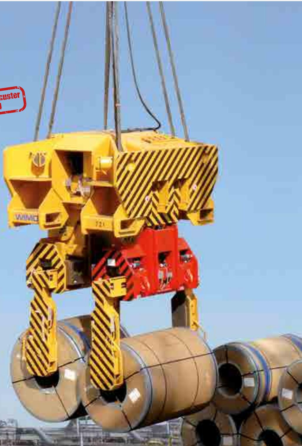
Teleskop-Coilzange mit Spindeltrieb für den Umschlag im Hafen von einem bzw. zwei Coils gleicher oder unterschiedlicher Breite
