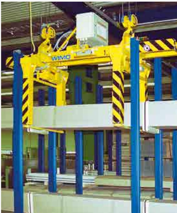
Traverse für den unfallsicheren und rationellen Umschlag von Langgütern mit Seilen oder Hebebändern. Die Anschlagmittel werden nach dem Ablegen der Last mittels motorischer Ausklinkeinrichtung einseitig (an der linken oder rechten Traversenseite) oder beidseitig ausgehängt. Somit können LKW's und Waggon's beladen werden, ohne dass sich eine Person auf der Ladefläche befindet
