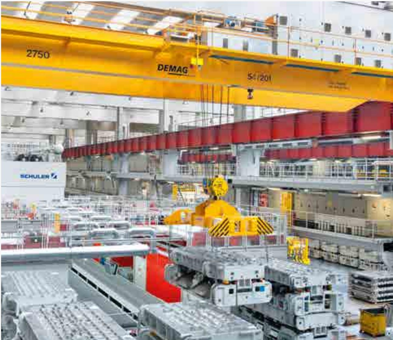
Teleskoptraverse in hydraulischer Ausführung für den Transport von Presswerkzeugen
