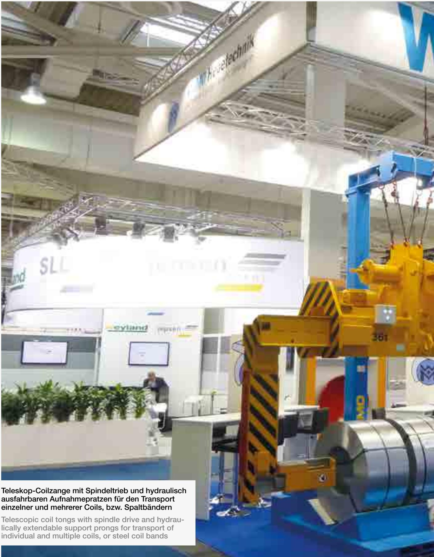
**Teleskop-Coilzange mit Spindeltrieb und hydraulisch ausfahbaren Aufnahmepratzen für den Transport einzelner und mehrerer Coils, bzw. Spaltbändern**
