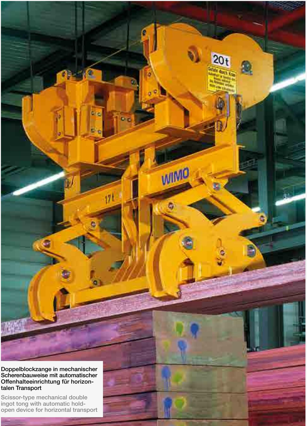
**Doppelblockzange in mechanischer Scherenbauweise mit automatischer Offenhalteeinrichtung für horizontalen Transport**
