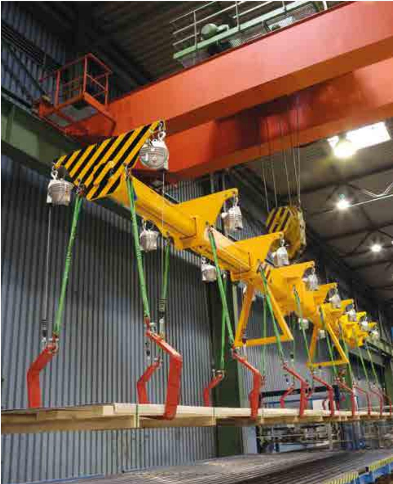
Hakentraverse mit beidseitig zweifach teleskopierbaren Auslegern. Mit an Federzügen aufgehängten Plattenhaken, die mittels Handgriff mühelos an das Blechpaket angelegt werden und haften bleiben
