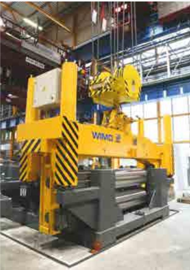
Arbeitswalzenzange an den Zapfen greifend, mit hydraulischer Zangenarmverstellung und vier Aufsetsäulen. Für das Einbringen und Entnehmen von ein oder zwei Arbeitswalzen aus Gestellen
