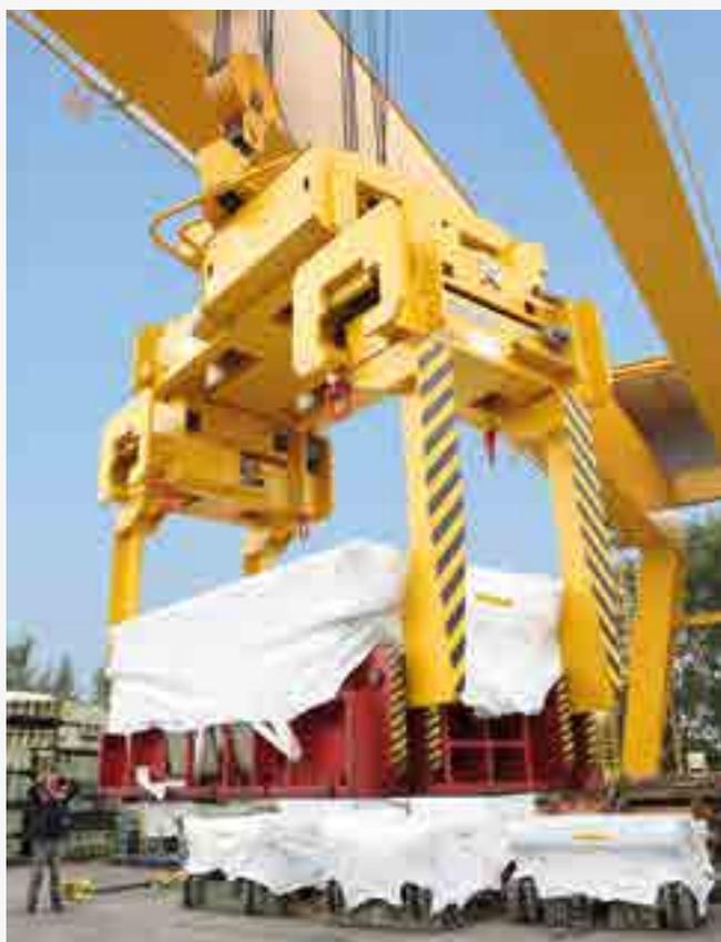
Presswerkzeugzange motorisch angetrieben mit Horizontal-Dreheinrichtung, in Längs- und Quer- richtung verstellbaren und um 90° drehbaren Auf- nahmepratzen. Für das Greifen von Presswerk- zeugen an ihrer Längs oder Stirnseite
