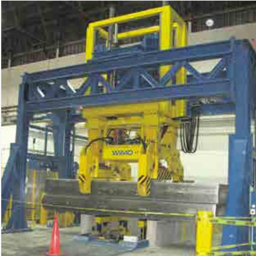
**Brammenzange mit zwei hydraulisch angetriebenen Greifeinheiten für Automatikbetrieb**
