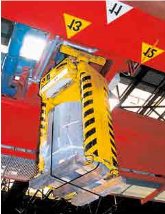
Teleskop-Palettenzange mit Spindeltrieb, motorischem Horizontal-Drehantrieb und vier um 90° motorisch drehbaren Aufnahmepratzen. Besonders schlanke Bauweise aller Komponenten zum platzsparenden Beladen von LKWs
