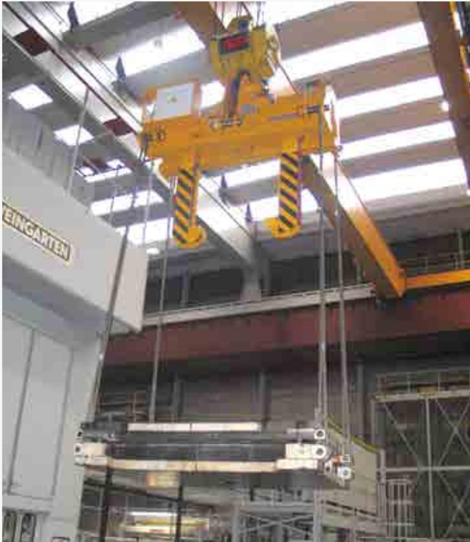
Teleskop-Coilzange mit Spindeltrieb für den Transport von Coils und Presswerkzeugen
