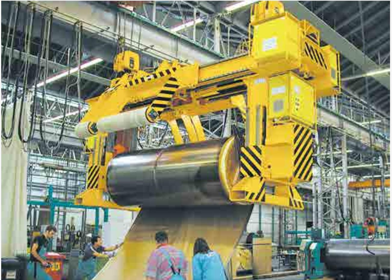
Coil Hängehaspel zum Auf- und Abwickeln von Dünblechen bei der Oberflächenbearbeitung. Ausführung mit Spreizbacken zur Coilaufnahme, verstellbaren Schlitten zur Anpassung an die Coilbreiten, Andrückrollen und höhenverstellbaren Absetzfüßen. Die Steuerung ist mit einer sensiblen Regelung für die Bandgeschwindigkeit ausgestattet
