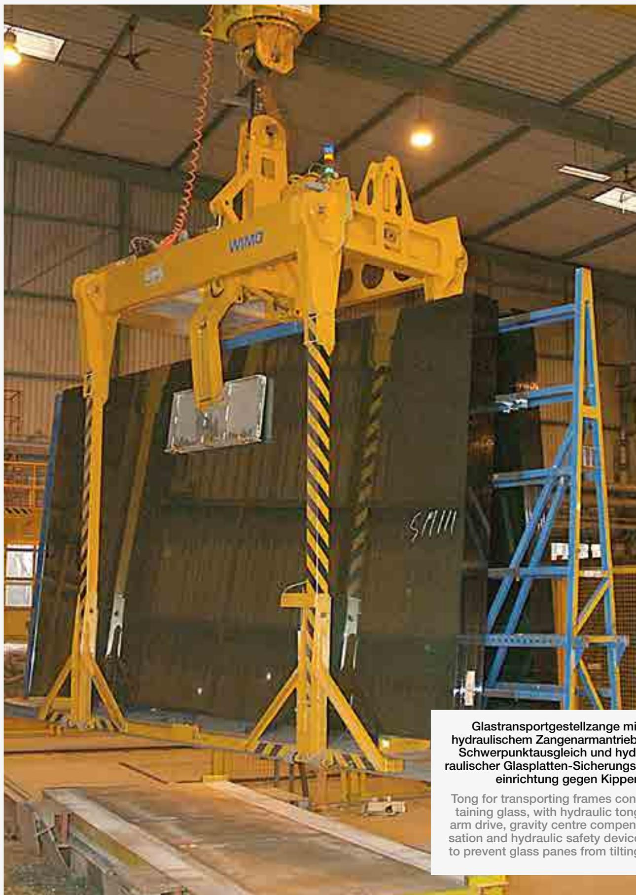
Glastransportgestellzange mit hydraulischem Zangenarmtrieb, Schwerpunktausgleich und hydraulischer Glasplatten-Sicherungseinrichtung gegen Kippen
