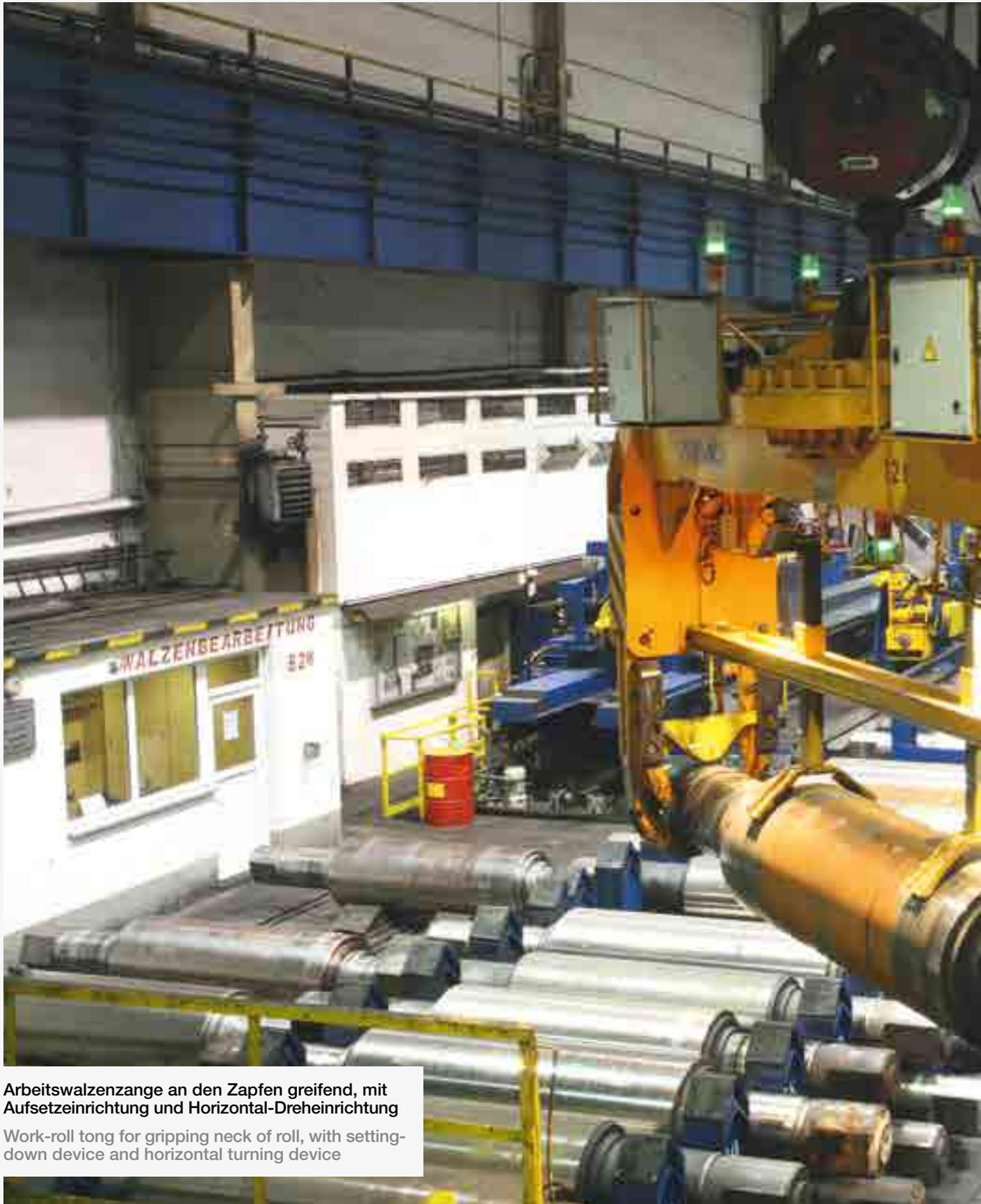
Arbeitswalzenzange an den Zapfen greifend, mit Aufsetzeinrichtung und Horizontal-Dreheinrichtung
