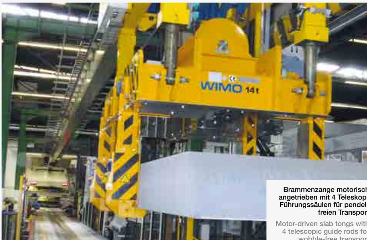
**Brammenzange motorisch angetrieben mit 4 Teleskop-Führungssäulen für pendel-freien Transport**
