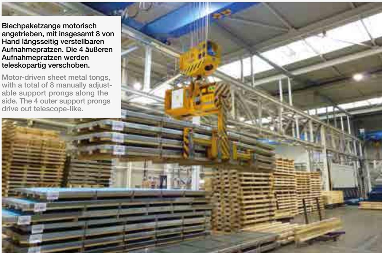
**Blechpaketzange mit motorisch längs- und querseitig verstellbaren Aufnahmepratzen**
