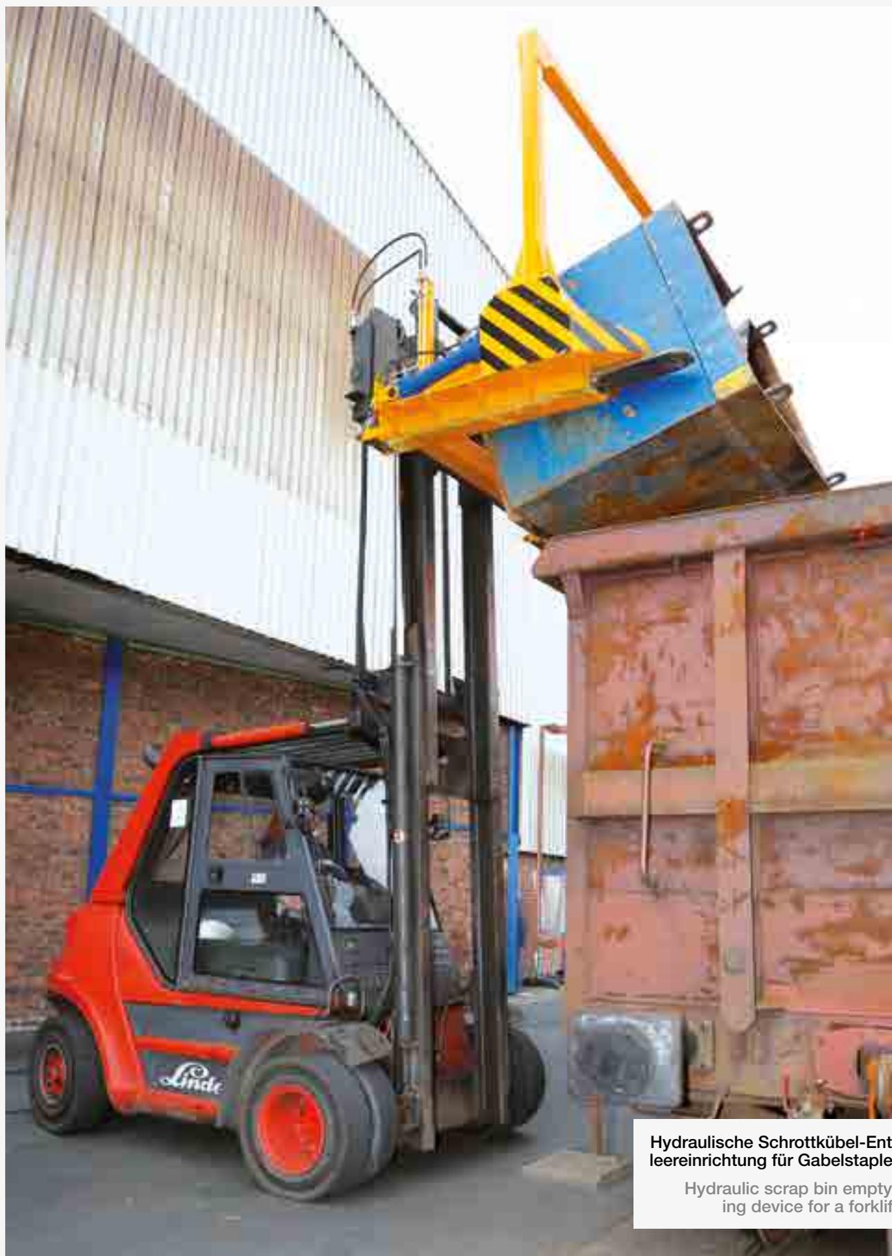
**Hydraulische Schrottkübel-Entleereinrichtung für Gabelstapler**
