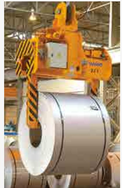
**Teleskop-Coilzange mit Kettenantrieb und motorischer Horizontal-Dreheinrichtung**
