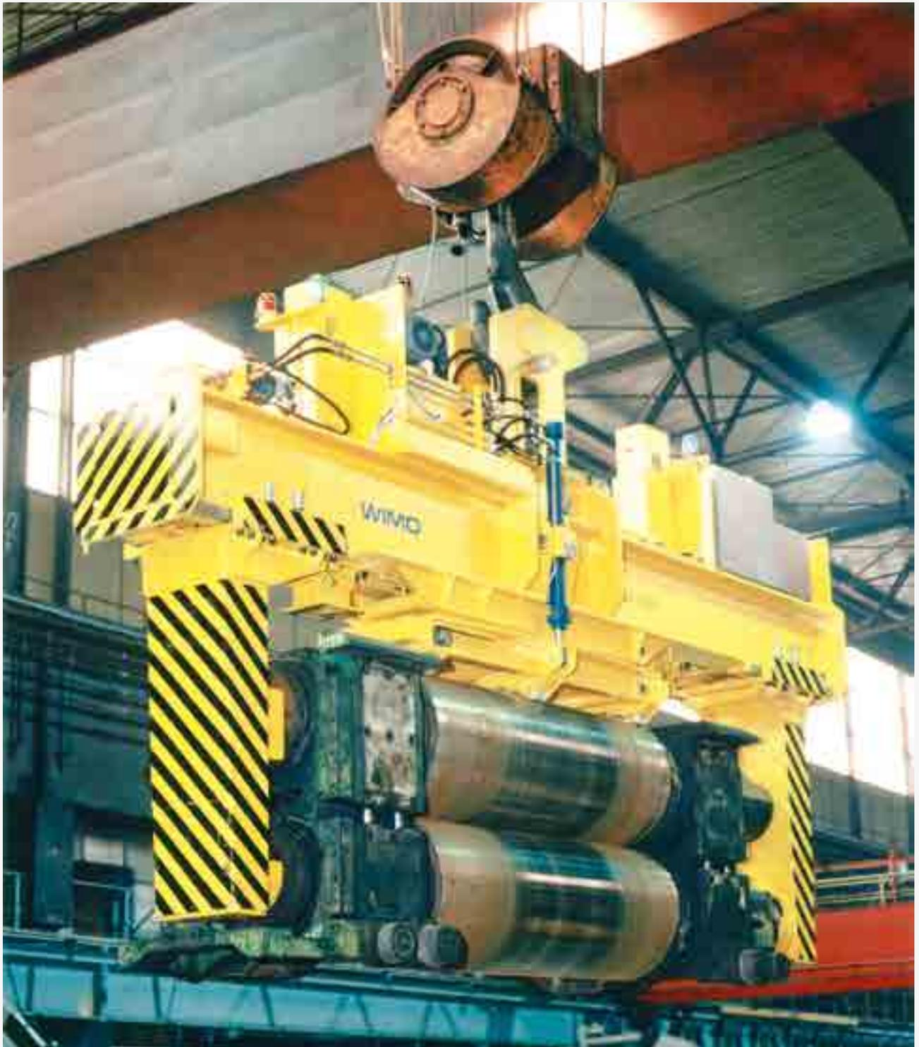
Arbeitswalzenzange an den Zapfen greifend, mit hydraulischer Zangenarmverstellung und Aufsetzeinrichtung. Für den wahlweisen Transport von ein oder zwei Arbeitswalzen mit Einbaustücken sowie von einer Arbeitswalze ohne Einbaustücke
