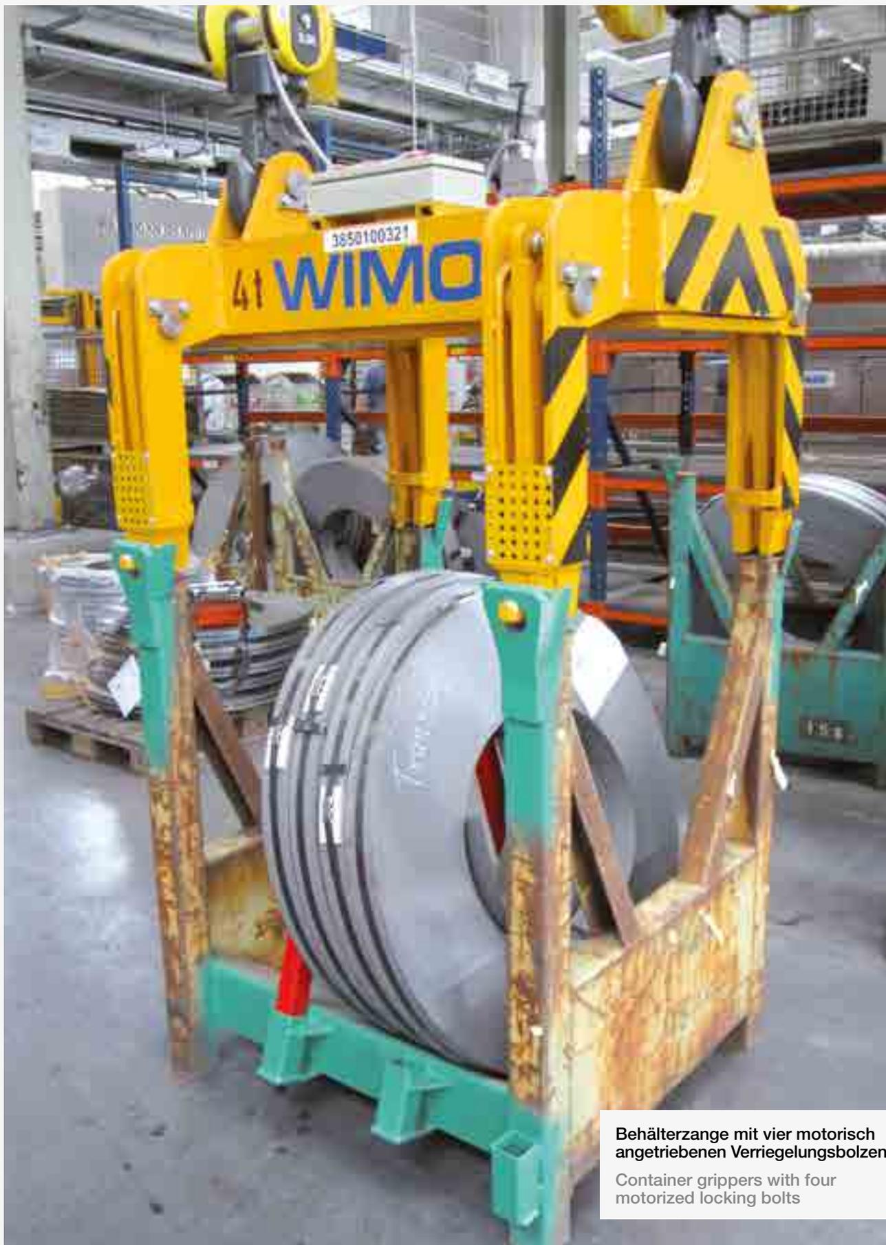
**Behälterzange mit vier motorisch angetriebenen Verriegelungsbolzen**
