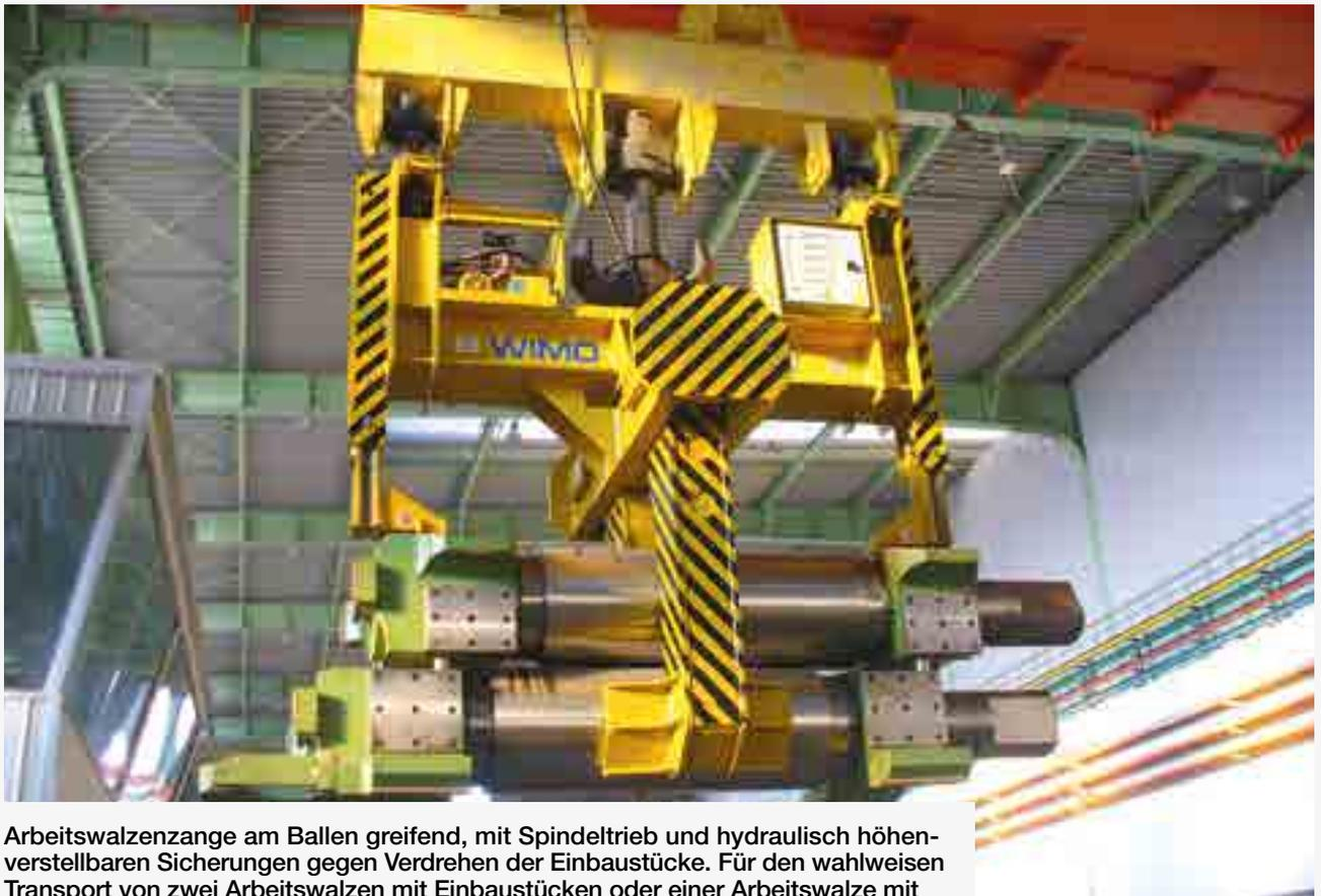
Arbeitswalzenzange am Ballen greifend, mit Spindeltrieb und hydraulisch höhenverstellbaren Sicherungen gegen Verdrehen der Einbaustücke. Für den wahlweisen Transport von zwei Arbeitswalzen mit Einbaustücken oder einer Arbeitswalze mit und ohne Einbaustücke
