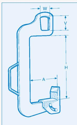
zum Wenden von Spaltbändern aus der vertikalen in die horizontale Achslage
