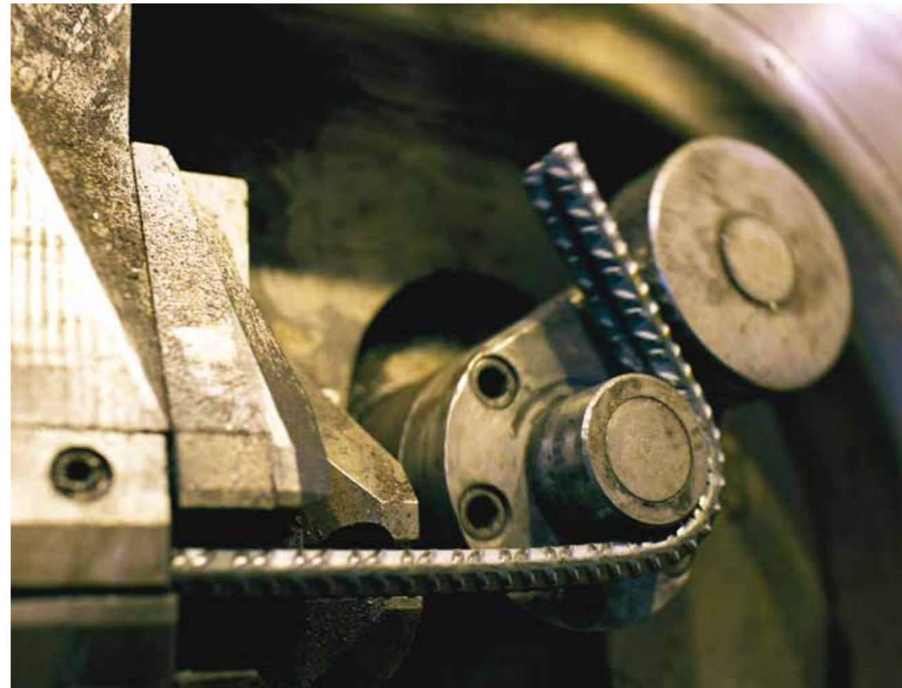
Byglar och krokar är bara två exempel på bockad armering.
