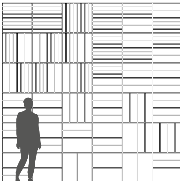
Troldtekt tiles monterat i slumpmässigt mönster
