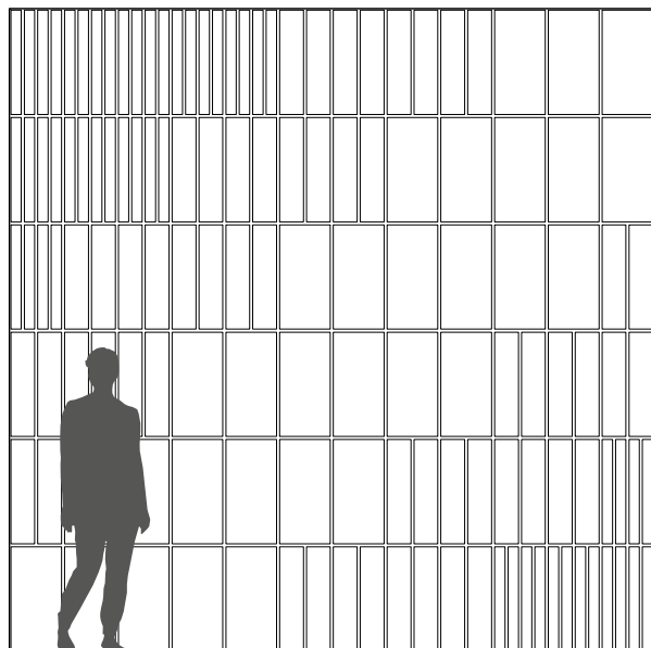
Troldtekt tiles monterat i alternativt mönster
