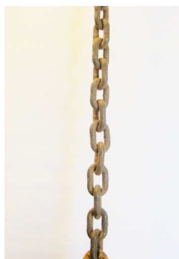
Kæde Transformation, over- belastning, deformation
