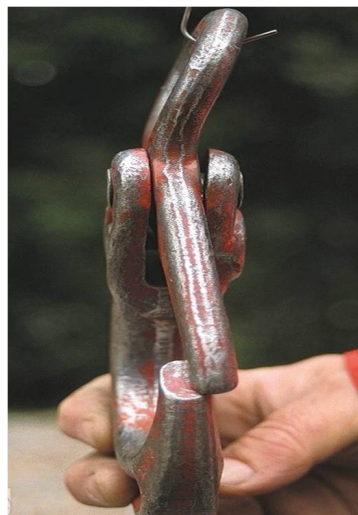
Krog Deformation, grundet forkert brug
