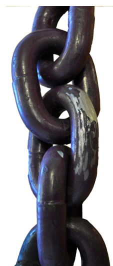
Kæde Slidt kædeled, uforsigtig håndtering
