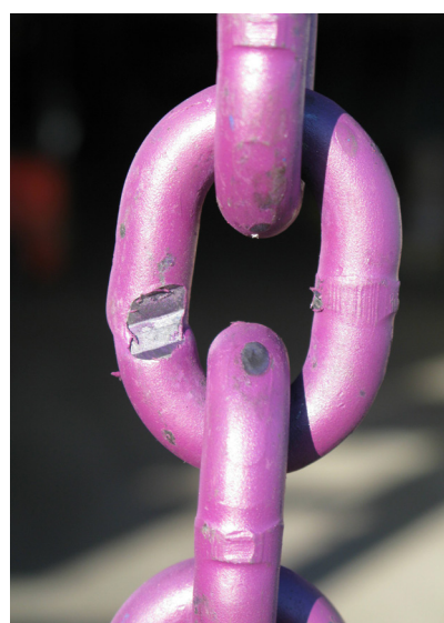
Kæde/komponent Snit, hakker, revner, sprækker
