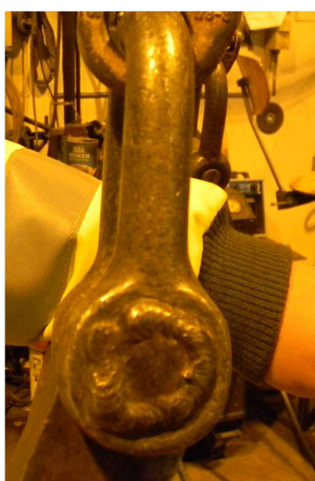
Komponent Svejsning af løfte- komponenter er forbudt
