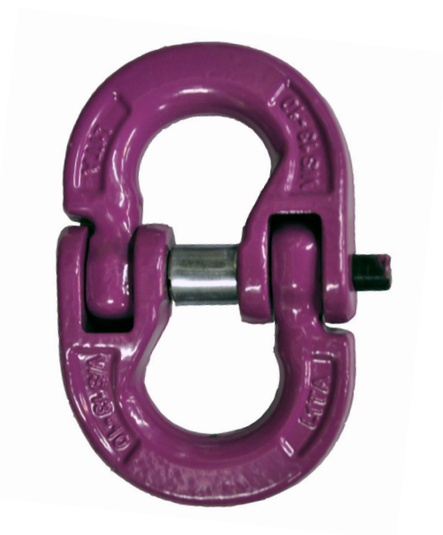
Samleled Defekt lås, stift bliver ikke på plads
