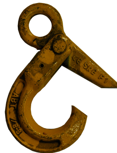
Krog pal Fjeder knækket, krogn kan ikke låses
