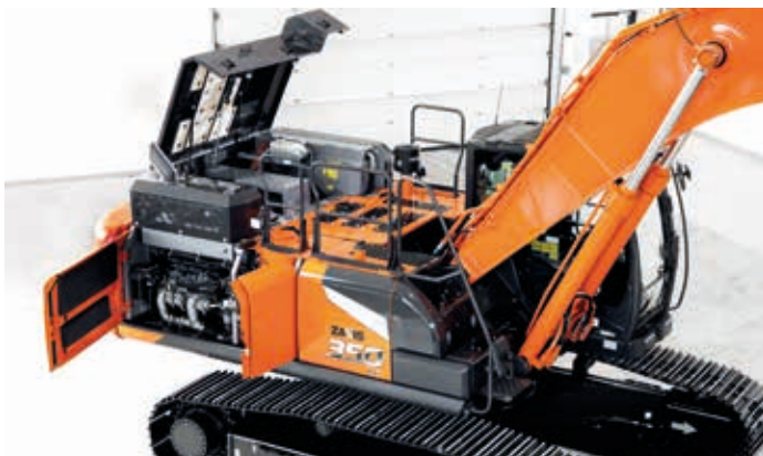
Motorhuv med gasdämpare (ZX300/ZX350) gör åtkomsten enkel.
