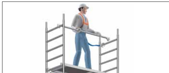
Fig. 1: Fastgørelse af faldsikringsudstyr under opstigning til det ikke-sikrede niveau Fig. 3: Sikker montage af rækværket ved brug af faldsikringsudstyr
