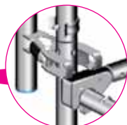
Fig. 4: Tilslutning af opskydeligt rækværk til stilladsgavlen
