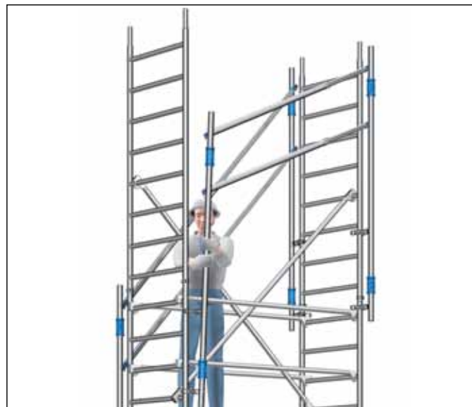
Fig. 5: Opadgående bevægelser i det opskydelige rækværk system
