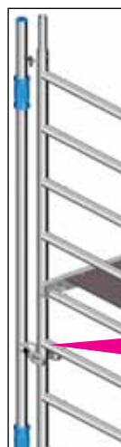
Fig. 4: Tilslutning af opskydeligt rækværk til stilladsgavlen
