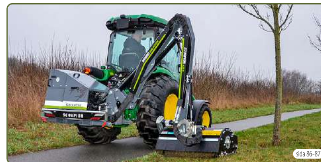
Släntklippare Scorpion 330/430 S och 330/430 BASIC Smidig armklippare för montering fram eller bak på traktor. Basic modell för montering på lastmaskin
