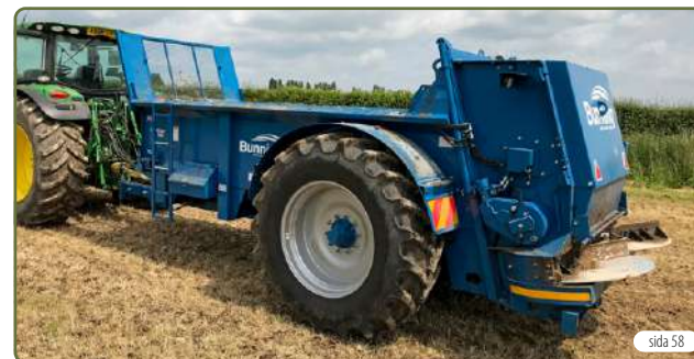
Stallgödselspridare GT Bunning ST-100 HBD Nytvecklad mindre spridare med liggande vals för spridning av flertalet typer gödsel och kalk.
