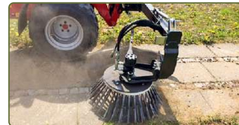
Ogräsbörste BR 70 för mekanisk ogräsbekämpning på hårdgjorda ytor.
