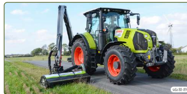
Släntklippare Scorpion 530/630 S och 530/630 PLUS Helt nytvecklad släntklippare med många fördelar. För montering bak med framåtgående räckvidd.
