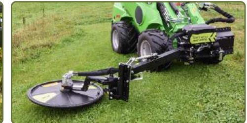
Kant-/Stolplippare RI 80 monterad.
