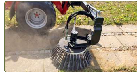
Ogräsborste BR 70 för mekanisk ogräsbekämpning på hårdgjorda ytor.
