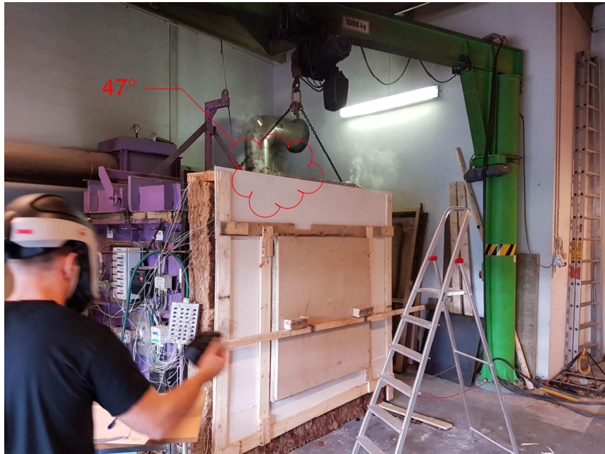
45 min. Røgudvikling fra brændende karmtræ fra vindue. Temp. under plade i top af test element 47°
