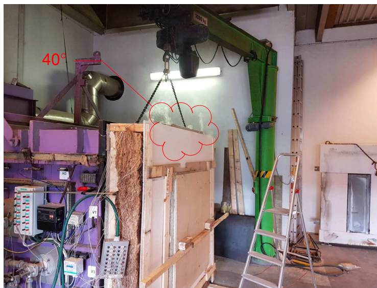
30 min. Røgudvikling fra brændende karmtræ fra vindue. Temp. under plade i top af test element 40°
