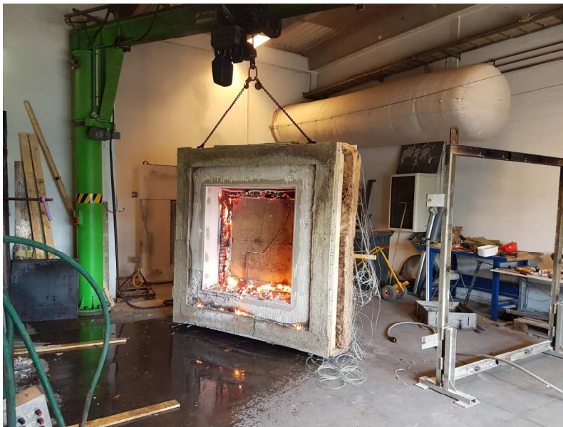
Test opstilling fjernet fra oven. BS Falsen sidder stadig hvor den skal.
