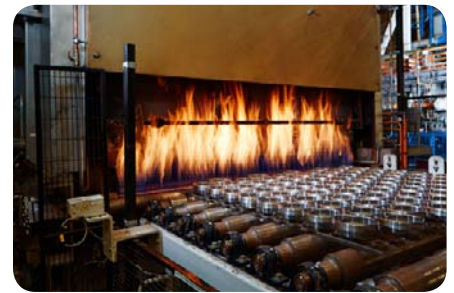
Varmebehandling af ringe til sfæriske rullelejer. Når ovnene fyldes og lugerne er åbne sikrer flammerne, at atmosfæren i varmebehandlingen holdes fri for oxygen
