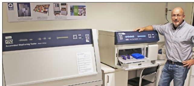
Pertti Steenari vid QUV-skåpet och Q-SUN Xe-1 xenonkammaren i Elastocons provningslaboratorium.
