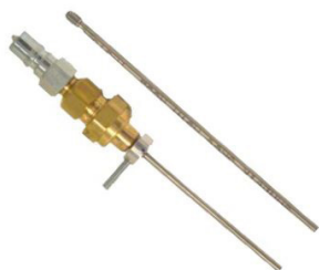
Dørlanse, metal 3,2 mm bøjeligt rør med 180° 4 mm dyse, indv. M2
