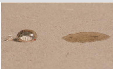
Alm. fugtimprægning. Vand afvises, men olie trænger igennem.
