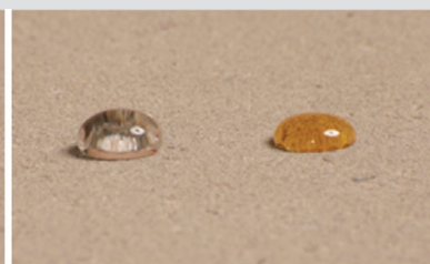
Faceal Oleo HD. Vand og olie afvises.
