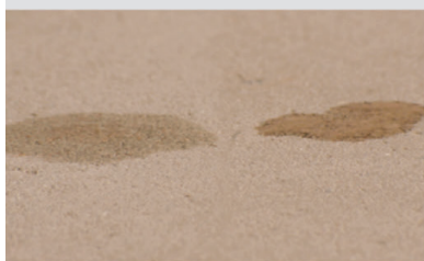
Ubehandlet overflade. Vand og olie trænger ned i overfladen.
