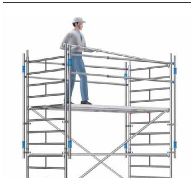
Fig. 6: Sikker montage af rækværk ved brug af det opskydelige rækværk system
