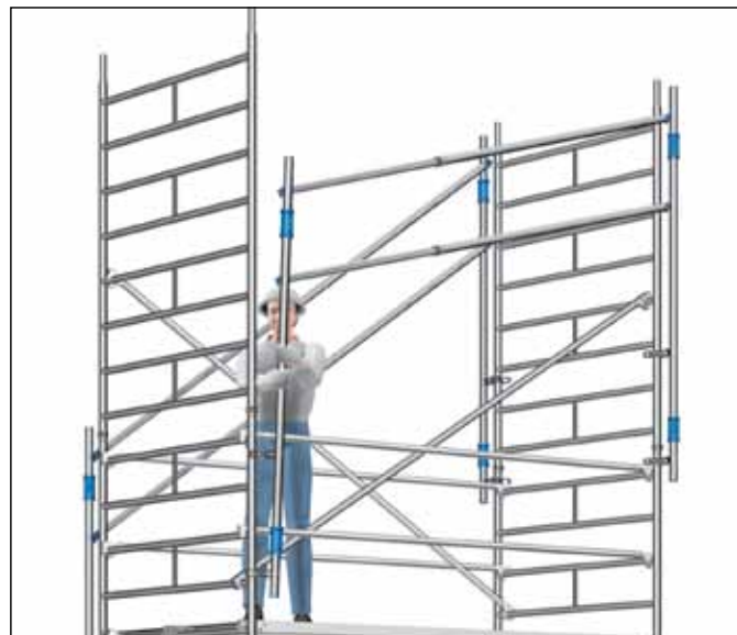
Fig. 5: Opadgående bevægelser i det opskydelige rækværk system
