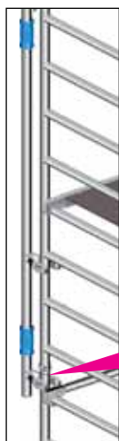
Fig. 4: Tilslutning af opskydeligt rækværk til stilladsgavlen
