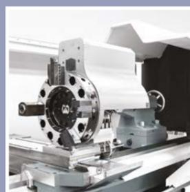
Revolver mit angetriebenen Werkzeugen
