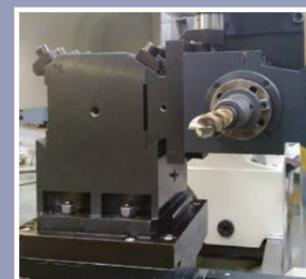
Werkzeugsystem auf dem Kreuzschlitten (T-Nuten)
