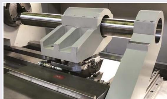
Bohrstangenhalter montiert auf Nullpunkt- Spannsystem
