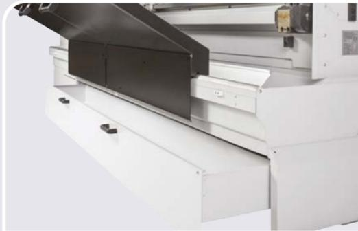
Spänewanne an der Vorderseite der Maschine
