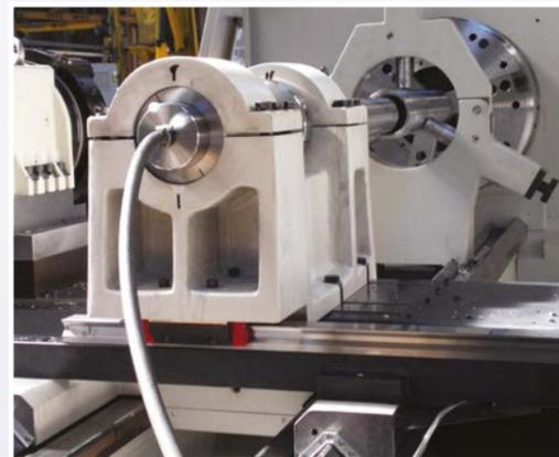
Halter auf T-Nuten montiert; für langen Bohrstangen
