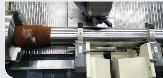
Hydraulische Lünetten mit unabhängiger Steuerung
