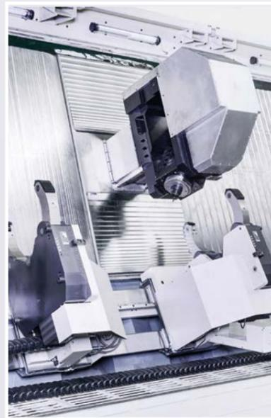
▲ Dreh-Fräskopf mit B-Achse
