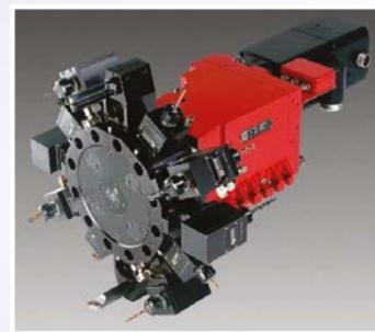
Revolver mit einer „Stern“-Werkzeugscheibe
