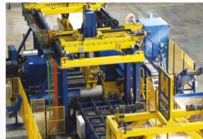
Eine Drehmaschine zur Bearbeitung von elektrischen Isolatoren. Die Papier-Epoxid-Masse, die die Kernisolation darstellt, wird bearbeitet. Der Spindelstock verfügt über einen eigenen Antrieb, wodurch er beliebig auf dem Bett positioniert werden kann. Die Maschine ist mit einem speziellen Absaugsystem ausgestattet, das die Ansammlung von Spänen und Staub in der Maschine verhindert.
