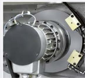
Spezielle Doppelabstreifer mit Sperrluft für zusätzlichen Schutz der Führungen vor Schleifstaub
