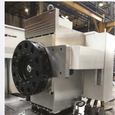
Revolver mit integrierter Y-Achse
