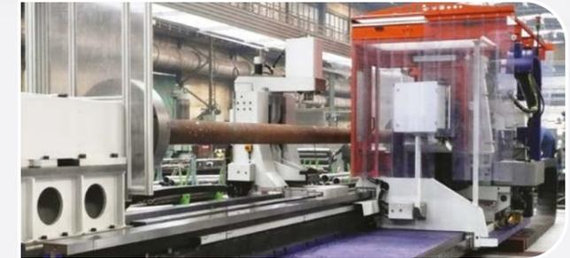
Produktionslinie zum Schleifen von Rohrschweißnähten.
