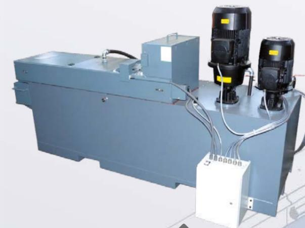
Zusätzlicher Kühlmittelbehälter mit Filter und Hochdruckpumpe
