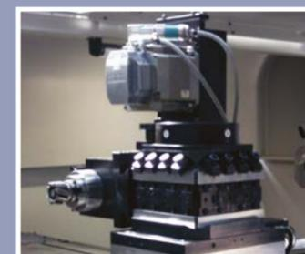
Bohr- Fräseinheit auf dem Kopfrevolver
