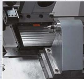
Hydraulischer Reitstock; Hub 15 mm
