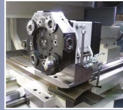
Revolverkopf mit Capto Werkzeugscheibe
