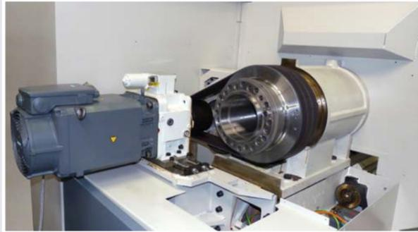
Direkter Spindeltrieb über 2-Stufen-Planetengetriebe.
