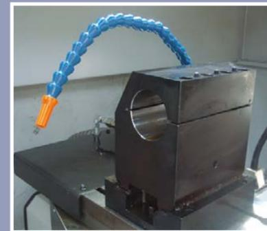
Bohrstangenhalter auf T-Nuten montiert
