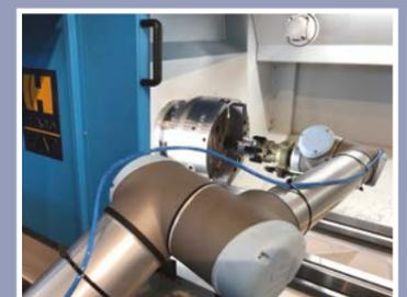
Hydraulisches Futter in Zusammenarbeit mit einem Roboter
