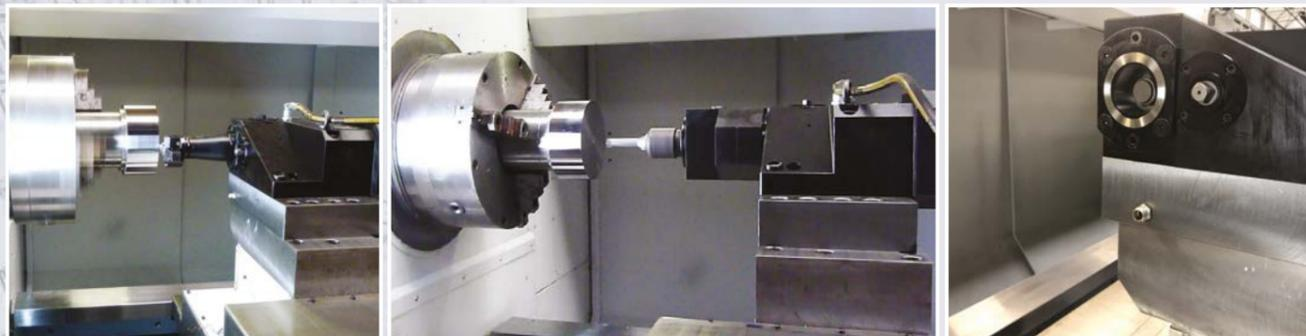
WTO-Werkzeugsystem zum Drehen, Fräsen und Bohren
