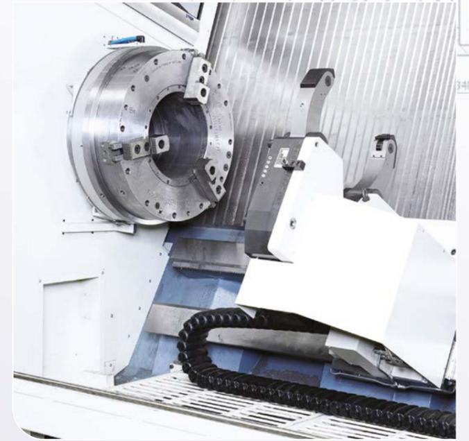
Pneumatisches Futter mit Durchgang 360mm
