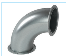
FLI Presset bøjning R = 1.5 x D FLI, inkl. 2 stk. løst monteret flanger Presset bøjning. 0,9 mm galvaniseret plade
