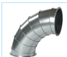
FLI Segmentbøjning R = 1.5 x D FLI, inkl. 2 stk. løst monteret flanger Segmentbøjning 0,9 mm galvaniseret plade
