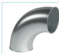
FB Presset bøjning R = 1.5 x D FB, med spændebåndskant Presset bøjning. 0,9 mm galvaniseret plade
