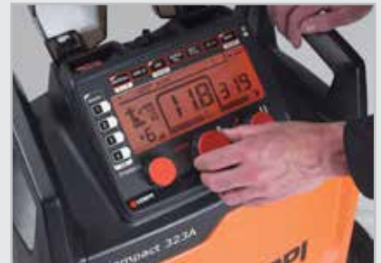
Det store og tydelige LCD-kontrollpanelet gjør det enkelt å stille inn og lese av parameterinnstillinger. Praktisk rom for oppbevaring av og tilgang til deler.
