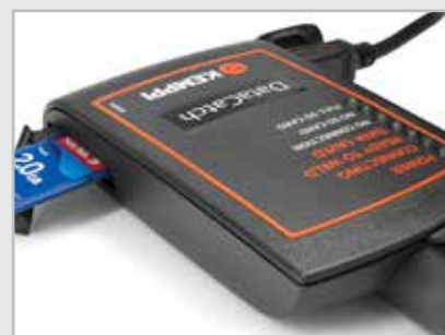
DataCatch-enhet tillater datainnsamling
