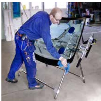
Verktyget är tiltbart och rutan kan förberedas för montering medan det vilar på det tillhörande stativet.
