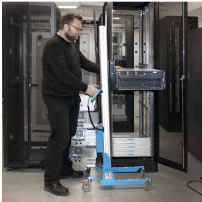
Hantering av servrar med Lift&Drive 90E. Underlättar lyft och transport av servrar som behöver service eller bytas ut.
