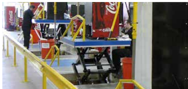
En grupp enkelsaxbord kan utgöra en komplett produktionslinje.
