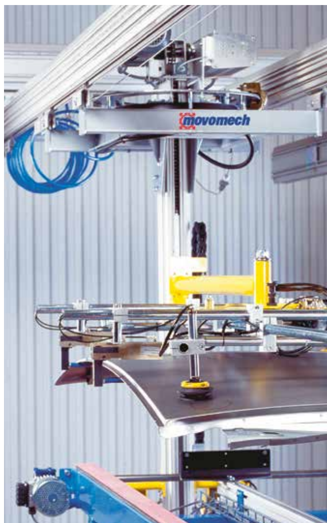
Plåthantering med Mechstick E och vakuumverktyg
