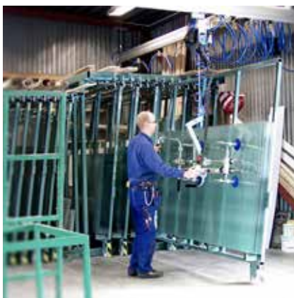
Även plåtar, motorhuvar och planglas kan hanteras med AGR-utrustningen.
