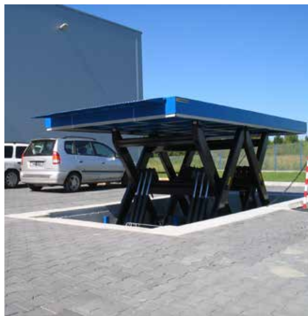
Styrningen av saxarna synkroniseras så att de arbetar parallellt och enhetligt.
