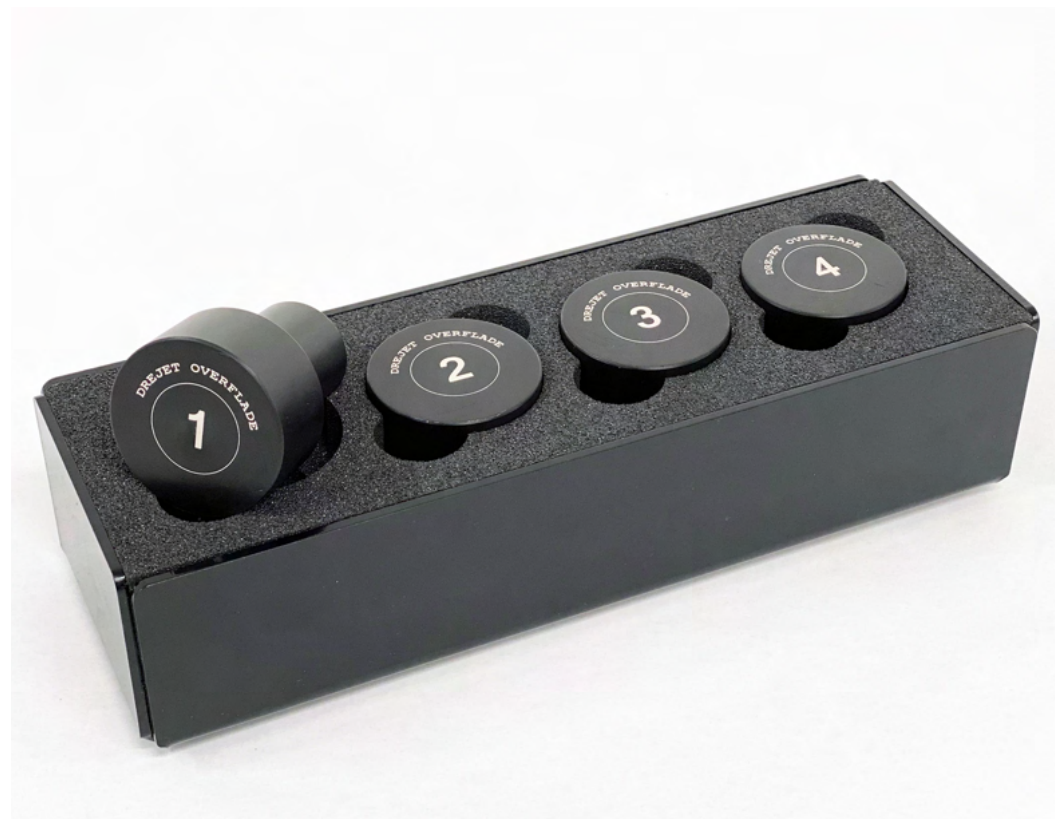
Eksempler på fire drejninger i POM-plast med forskellige overflader.
