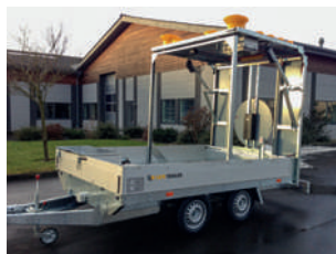
Tavlevogn med knæktavle giver ekstra plads i traileren
