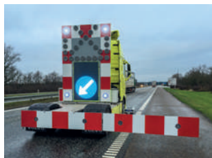
LED-skærm monteret på lastvogn med afspærring af nødspor
