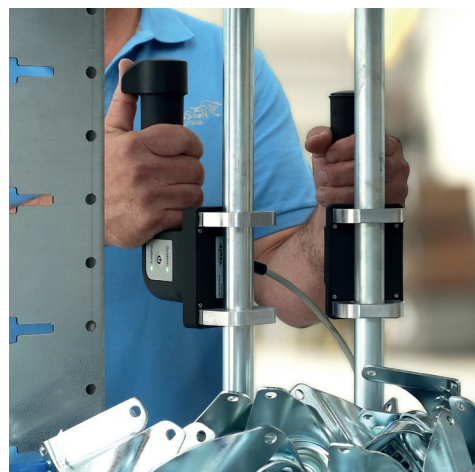
Anpassningsbara handtag (horisontella eller vertikala) för rör eller vanlig planmontering.
