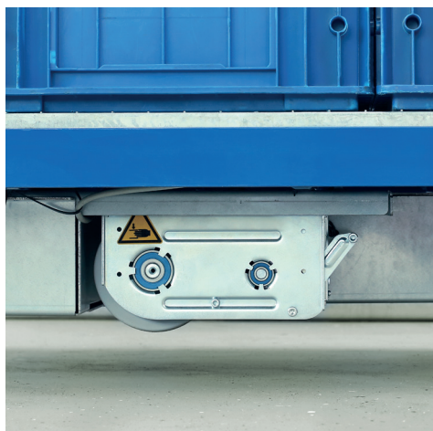
I stand by-läget är hjulet indraget så att det blir fritt under vagnen.
