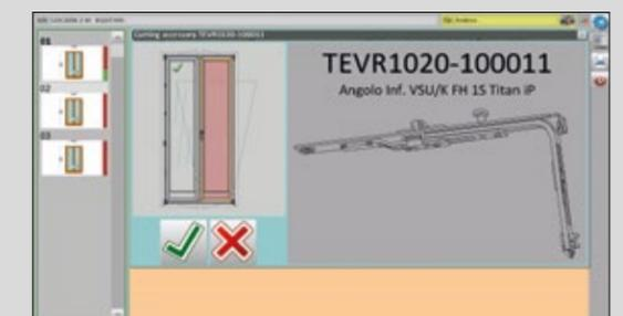
Fornisce informazioni in tempo reale direttamente all'operatore di produzione, durante le varie fasi di costruzione del serramento. Permette inoltre la stampa dell'etichetta CE da applicare al prodotto finito.
