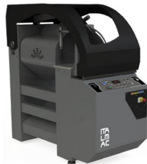
**M**acchina monotesta con lama a scomparsa realizzata per profili in alluminio. Posizioni fisse a -20°, -45°, 90°, +45°, +20° con possibilità di posizionamento a gradi intermedi. 3 versioni disponibili: AUTOMATICA, SEMI-AUTOMATICA ED ELETTRONICA. Specifiche tecniche: diametro disco 450/550 mm, giri lama 2800 giri/min, pressione di esercizio 7 bar, lubrificazione pneumatica, visualizzatore di quota gradi nella versione.
