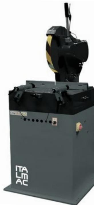
**T**roncatrice monotesta con movimento discendente manuale o automatico della lama. Piano girevole. Inclinazione della testa da 90° a 45° Sx (asse Y). Dispositivo di bloccaggio manuale a qualsiasi angolazione intermedia. Specifiche tecniche: lama diametro 400mm, lubrificazione pneumatica, discesa unità manuale, inclinazione testa (asse Y) manuale, rotazione testa manuale, gradi intermedi in manuale, morse pneumatiche.
