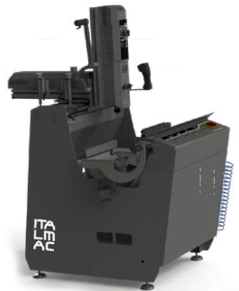
**P**antografo con unità di fresatura verticale e piana rotante di 180°. Basamento e piana di lavorazione in acciaio. Idoneo per lavorazioni di fresatura su profili in alluminio tramite dima o in battuta. Velocità mandrino regolabile, mediante inverter, elettronicamente a bordo macchina. Piana girevole regolabile anche per gradi intermedi.
