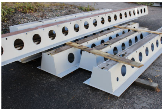
Figur 7. Opbevaring af DELTABEAM® Frame stålelementer i bunker.
