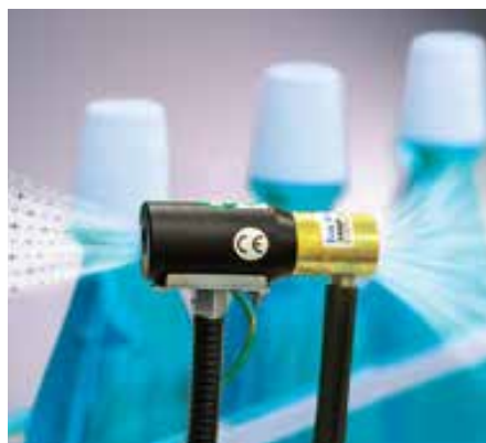
Ion dysen neutraliser og rengør mundskyldflasker inden påføring af den brudsikre forsegling.
