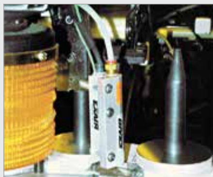
Standard ion luftkniv fjerner støv fra computerens harddiske før montering.
