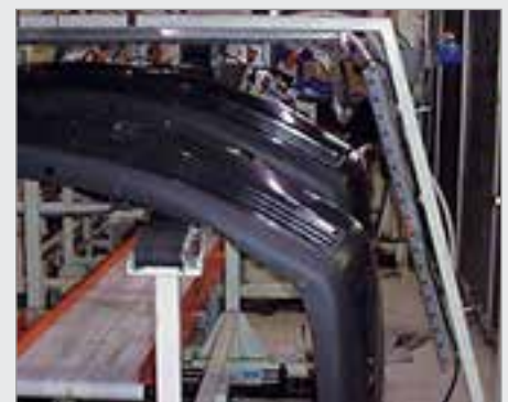
Karosserier renses for støv og fibre inden maling vha. en serie super ion luftknive.
