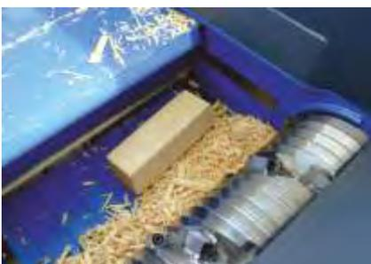
Rotor mit einer Messerreihe für geringe Leistungsaufnahme
