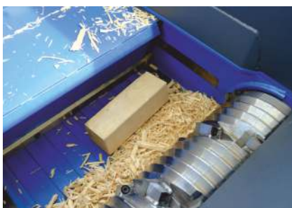
Rotor mit einer Messerreihe für geringe Leistungsaufnahme
