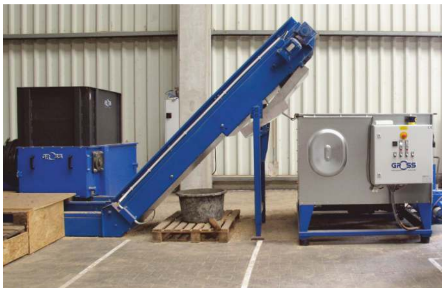
GAZ 82 S in Kombination mit Förderband und Brikettierpresse
