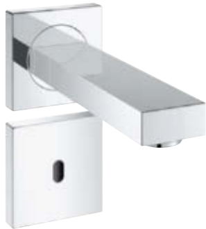
36 442 000 / 704188.504 Infrarødt håndvaskarmatur (230 V) uden blandeenhed fremspring 172 mm
