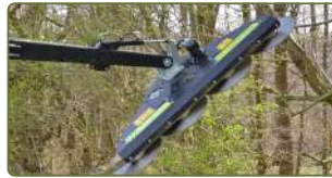
Grensåg LRS monterad. Hydraulisk klippvinkejustering 110° (extrautrustning HXF 3302). Kräver 1 st dubbelverkande hydrauluttag.
