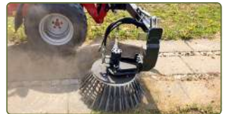
Ogräsborste BR för mekanisk ogräsbekämpning på hårdgjorda ytor.
