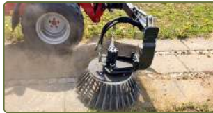
Ogräsborste BR för mekanisk ogräsbekämpning på hårdgjorda ytor.
