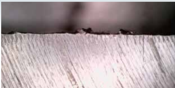
Fræset overflade (alu) med fræsespor og grattedannelse på kanterne.
