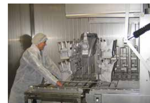
Holderen skubes direkte ind i grovopvaskeren uden anstrengende løft for operatøren.
