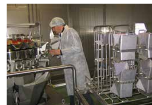
Vægtskålene afmonteres fra vejerens og monteres direkte på holderen.
