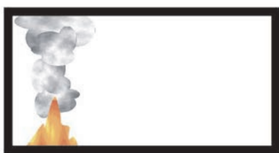
Bygning uden brandventilationssystem
