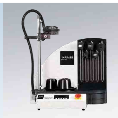
Power Clamp Profi Plus NG Hochleistungs-Schrumpfgerät – Schrumpfleistung 20 kW – Zum Schrumpfen von Werkzeugen mit Ø 3–50 mm – Für HSS- und HM-Werkzeuge – Große Spule für Ø 40–50 mm (Optional) – Inkl. Drehteller und Aufnahmehalter – Inkl. Werkzeugablage – Inkl. Schwenkfächer für Zubehör
