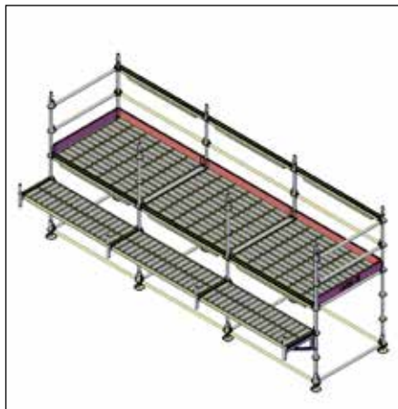
2. Dæk etableres nedefra, rækværk monteres og låseskinner isættes. Klar til brug.
