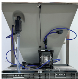
Det lukkede kompakte vandkredsløb gør kabinen enkel og nem at betjene.
