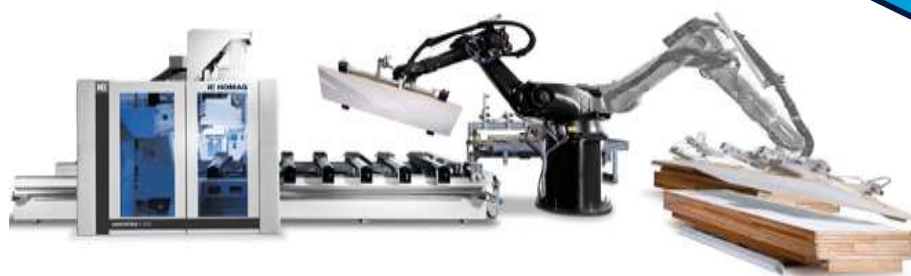
CENTATEQ P-200 med QRS-robotsystem med KUKA-robot
