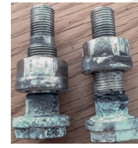
Alvorlig korrosion på ventil
