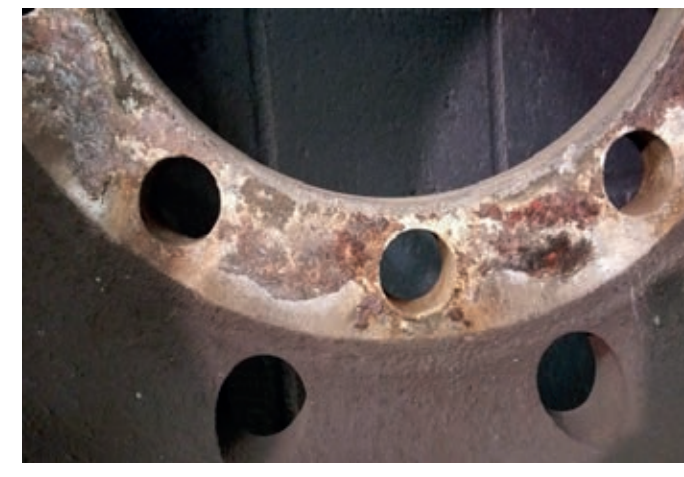
Korrosion på kontaktfladen af fælgen
