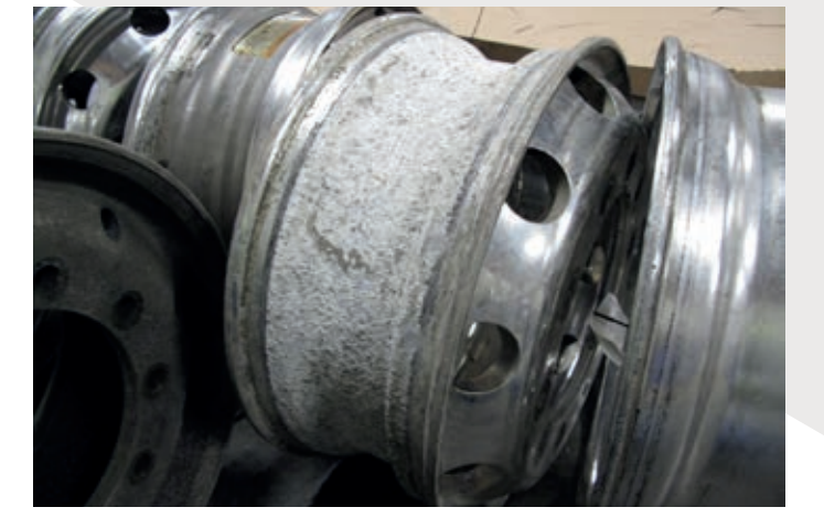
Korrosion forårsaget af flydende afbalancerings- og forsejlingsprodukter
