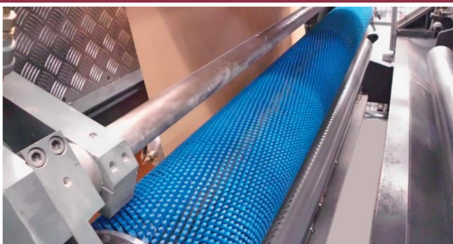
BSW215 beim automatischen Rollenwechsel im Klebe-/Schneidegestell
