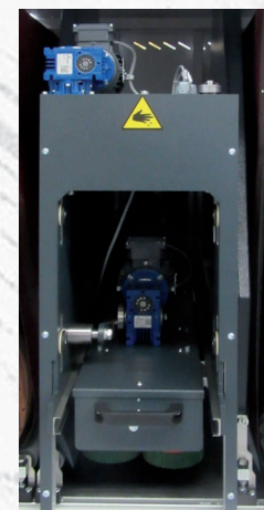
Gruppo spazzole tangenziali / sistema planetario Tangential brushes unit / planetary system Brosses tangentielles avec système planétaire
