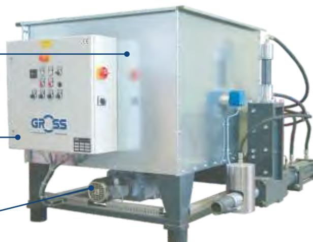
Hydraulisch gesteuertes Zangensystem für konstante Brikettfestigkeit
