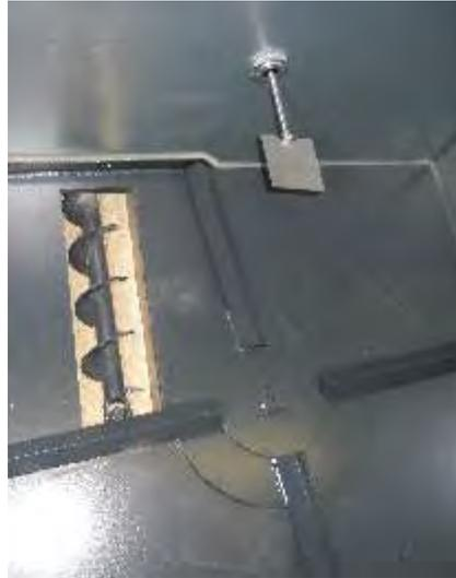
Rührwerk, Förderschneckenververdichter und Füllstandsmelder im Inneren
