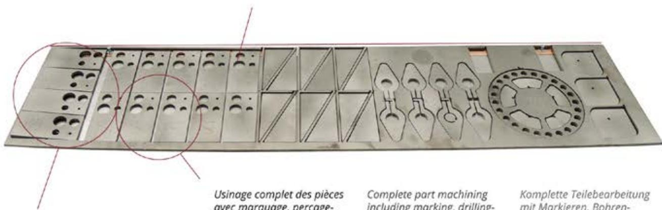
Mise en tôle avec coupe 3C
