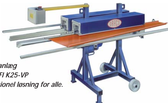
Profileringsanlæg PROFIMA K 25 - konstrueret til anvendelse i værkstedet eller på taget.
