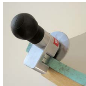
WUKO Mini Disc-O-Bender 4010 - bukker omslag op til 23 mm fra 90° til 180°.
