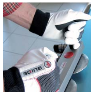
WUKO Disc-O-Bender 4000 - bukker omslag op til 40 mm fra 90° til 180°.
