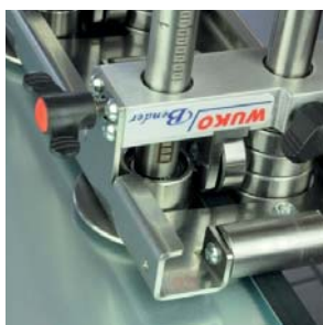
WUKO ombukker 8200. 6-200 mm og ned til 12 mm ombuk fra 0° til 160°.
