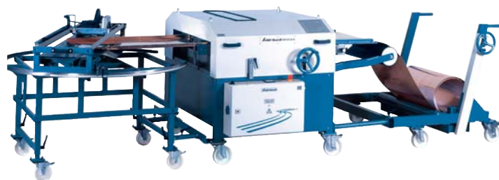
SPM 30/80-LM-QA 45°. Profileringsmaskine SPM tjener her som basismaskine sammen med længdemåler LM og tværspalteanlæg SPM.
