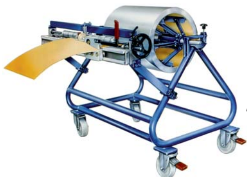
Coilvogne - mobile udgaver i alle versioner til byggeplads eller værksted.
