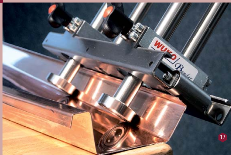
WUKO tagfalsmaskine 1006/1008 - fremstilling af højfals og lavfals samt lukning af dobbeltfals eller vinkelfals på opkantede baner.
