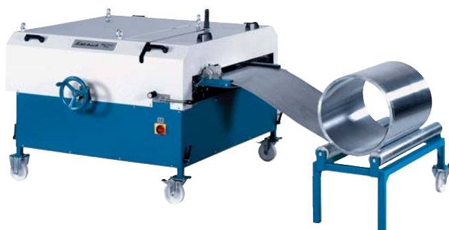
Mini-Prof Plus er en kompakt version baseret på profileringsmaskinen Mini-Prof.
