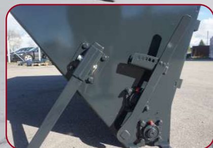
Stöbren och reglering av utmatning
