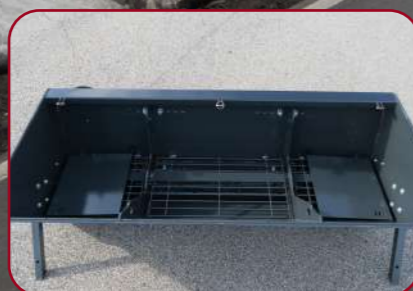
Öppningsbara skyddsgaller och spidarregleringsplåtar
