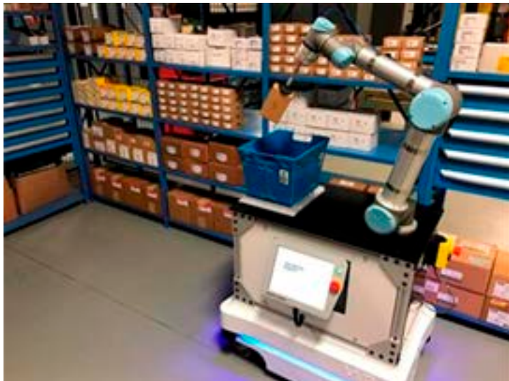
En MiR100 med en UR3-robotarm plockar artiklar på ett lager.
