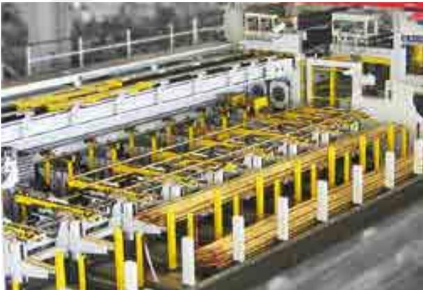
**2-fach-Rohrziehanlage für Kupferrohre und kupferlegierte Rohre, mit Zahnstangenantrieb, mit automatischer Rohrvereinzlung**
