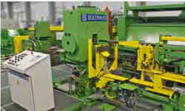
Faltangelmaschine HAM 150 für Stahlrohre, mit Zangen-
