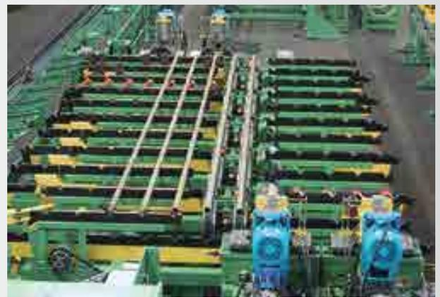
Doppelfasanlage für Stahlrohre, in Linie mit Zieh-, Richt-, Säge- und Prüfanlage
