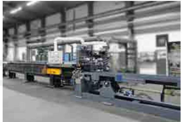
**2-fach-Rohrziehanlage für Edelstahlrohre, mit Kettenantrieb**
