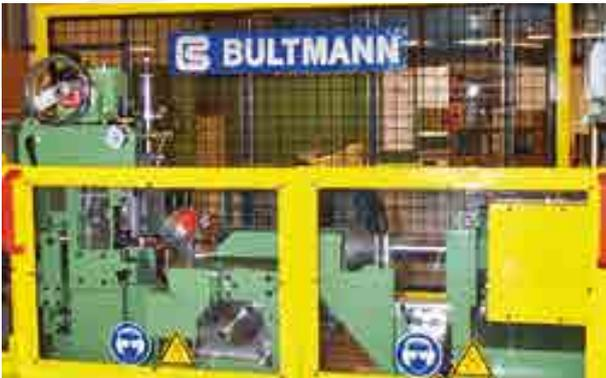
Schrotthacker für Kunststoffummantelung und Kupferrohre
