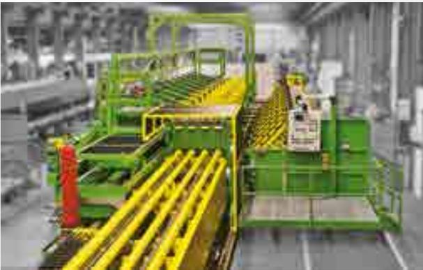
Produktionslinie für Präzisionsstahlrohre mit Anspitzanlage, 4-fach-Rohrziehmaschine und Spanlostrennanlage
