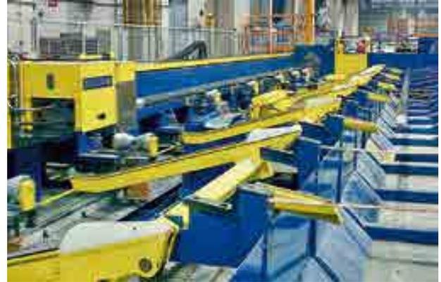
Rohrziehanlage für Präzisionsstahlrohre, mit Sägeanlage
