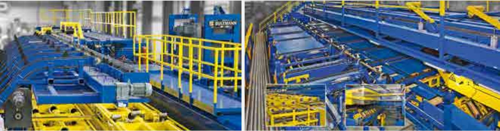
3-fach-Rohrziehanlagen für Stahlrohre, mit Zahnstangenantrieb, mit automatischer Rohrvereinzelnung und automatischem Vorbankkassettenwechselsystem
