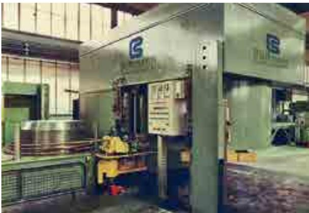
Trommelziehmaschine mit hängender Ziehtrommel für
