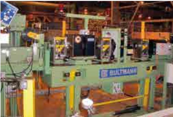
Prüftisch mit Wirbelstromprüfung für Stahlrohre
