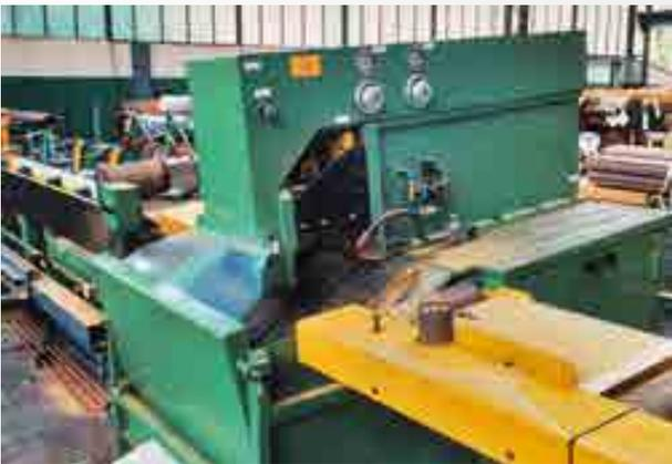
**Lagensäge in Linie mit Zieh- und Richtanlage für Messingrohre und -profile**
