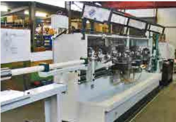
**Rollenziehmaschine für Kupferrohre**
