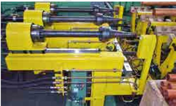
Rohraufweineinrichtung für spanlos getrennte Kupferrohre
