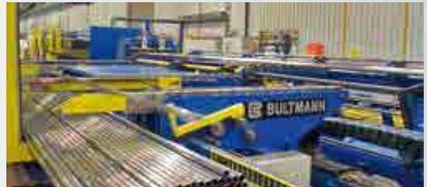
Späneausblasanlage für Stahlrohre, mit Fasanlage
