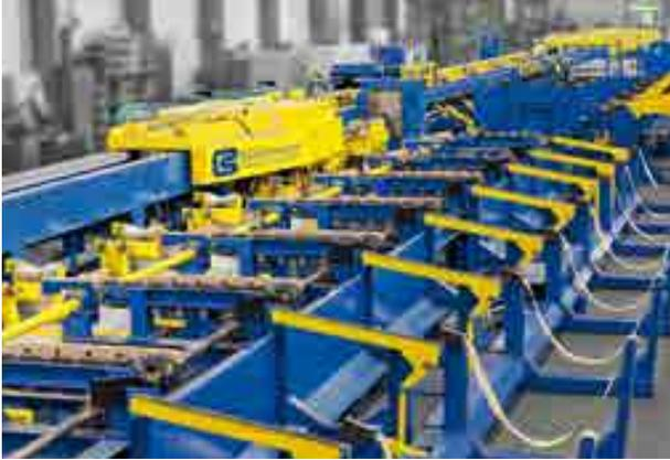
**1-fach-Rohrziehanlage für Präzisionsstahlrohre, mit Dornstangenwechsellvorrichtung**
