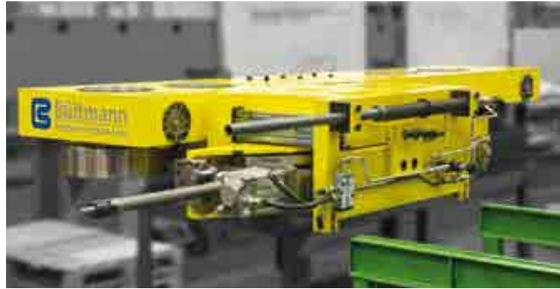
Ziehwagen mit 1-fach-Rohrinnenspannzange für Kupferrohre
