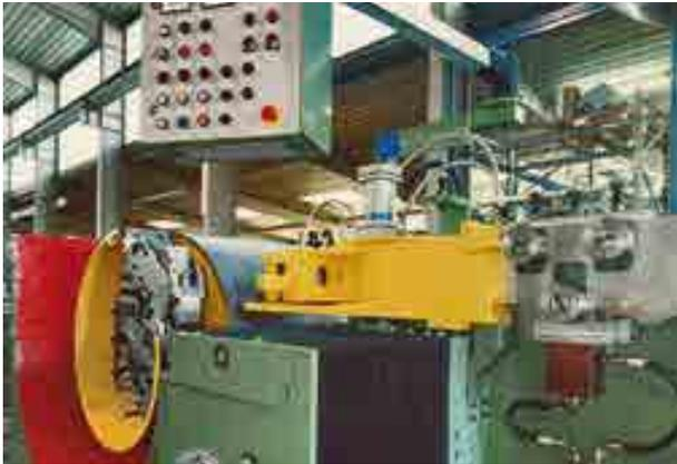
Trommelziehmaschine für Stahlrohre
