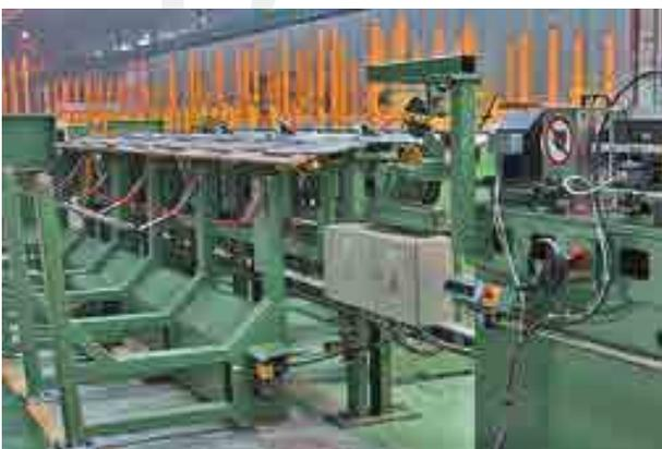
Prüfanlage mit Wirbelstromprüfung nach einer visuellen Prüfung für Stahlrohre
