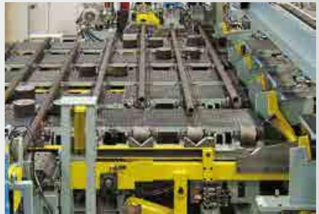
Fasanlage für Stahlrohre mit vorgelagerter Hochleistungskaltkreissäge
