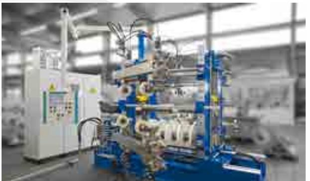
Mehrwalzen-Richtmaschine für Aluminiumprofile
