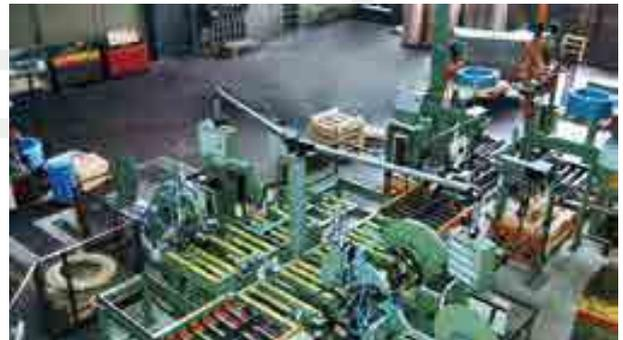
Abbinde- und Folienummantelung für Kupfercoils
