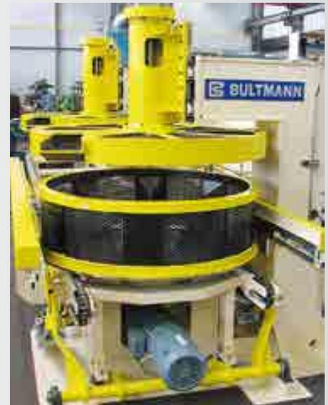
Aufcoiler im Pressenauslauf für kupferlegierte Rohre und Profile
