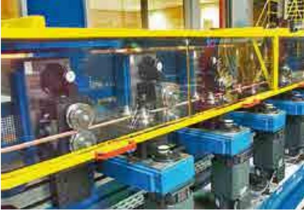
**Rollenziehmaschine für Kupferrohre**
