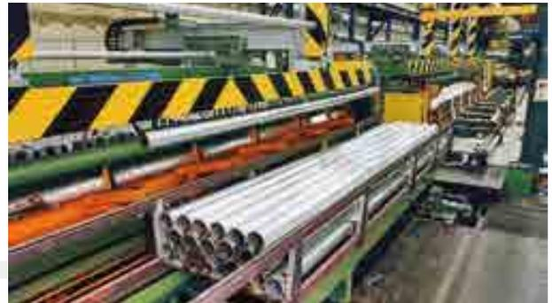
Vakuumtransportsystem für Aluminiumrohre
