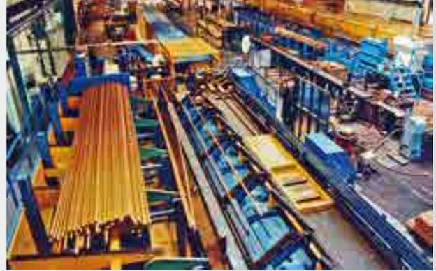
Rohrproduktionslinie für Kupferrohre mit automatischer Rohrvereinzlung, Anspitzanlage, 3-fach-Rohrziehmaschine sowie Sägelinie
