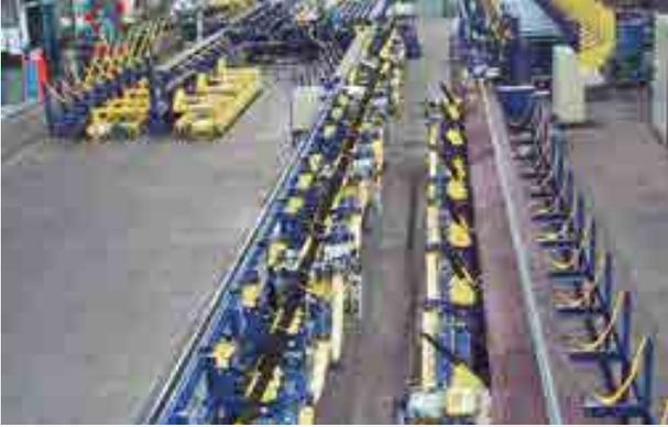
Rohrproduktionslinie für Edelstahlrohre mit automatischer Rohrvereinzlung, Prüflinie, Sägeanlage, Kunststoffstopfen-Verschlussanlage sowie Rohrblagesystem
