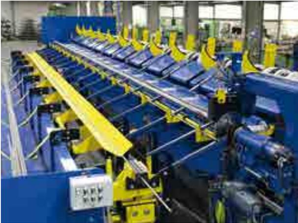
Automatische Rohrvereinzelung vor einer Anspitzmaschine für Stahlrohre
