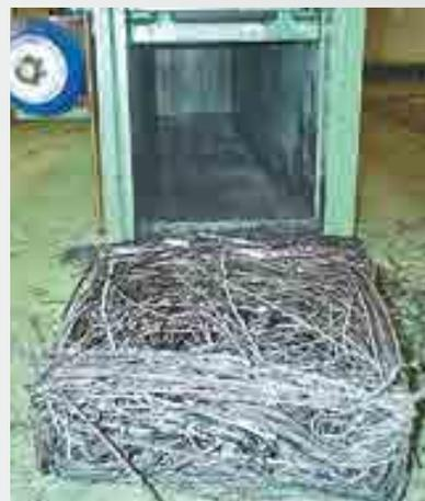
Ausgabeschacht einer Spänepresse mit Spanpaket
