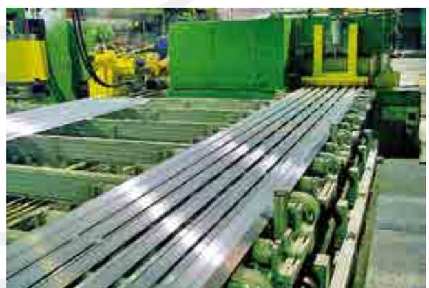
Lagensäge im Auslauf einer Strangpresse, für Aluminiumrohre und -profile
