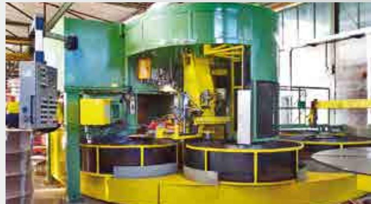
**Spinnerblock, ebenerdiger Aufbau für Kupferrohre**
