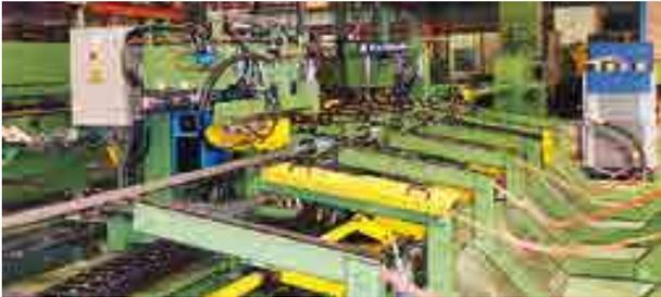
Späneausblasanlage inkl. Spänepresse und mit Fasanlage für Stahlrohre, im Auslauf einer Rohrschweißanlage
