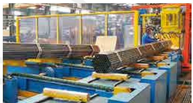
Bundtransport und Abtropfstation für Stahlrohre
