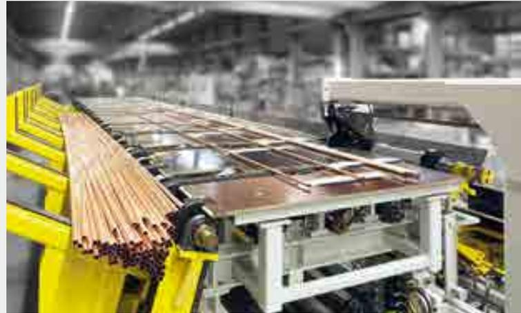
Rohrvereinzelung vor einer Richt- und Sägelinie für Kupferrohre
