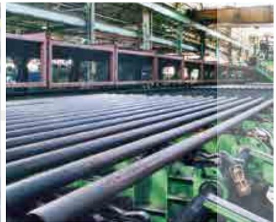
Puller im Auslauf einer Strangpresse für Aluminiumrohre und -profile
