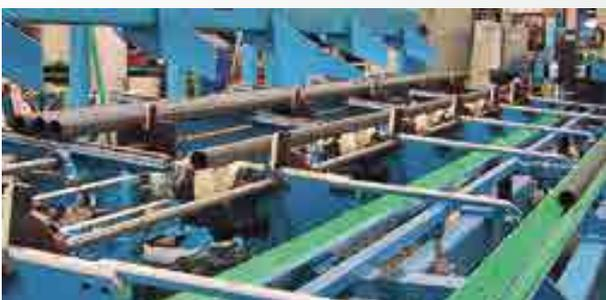
Gewindemuffenschneidmaschine für Stahlrohre mit Spanlostrennanlage
