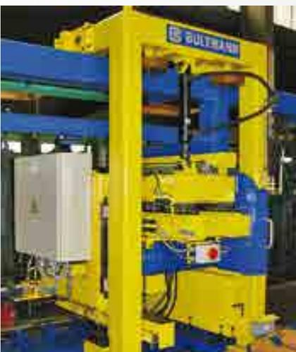
**Warmsäge im Auslauf einer Strangpresse für Aluminiumrohre und -profile**
