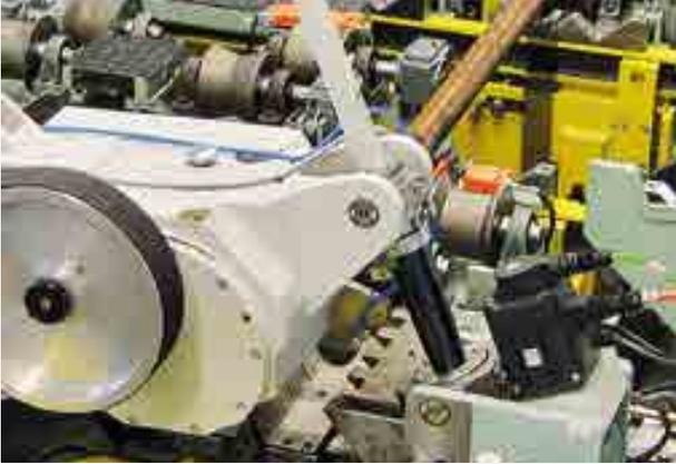
**Sägeanlage mit Fasanlage für hochlegierte Stahlrohre**
