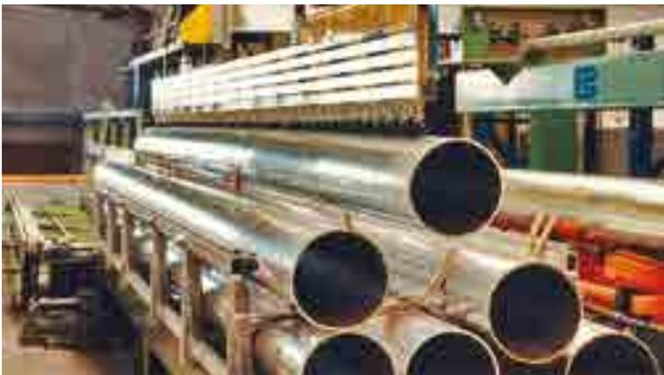
Vakuumtransportsystem für Aluminiumrohre
