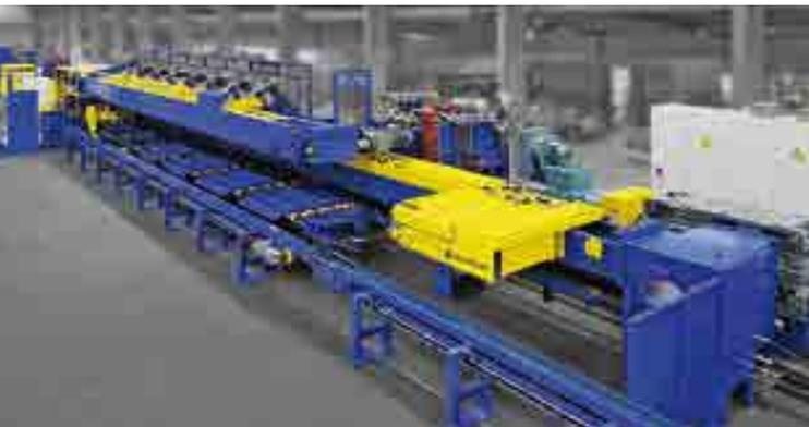
4-fach Rohrziehenanlage mit Kettenantrieb
