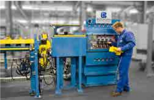
10-Rollen-Rohrrichtmaschine für Edelstahlrohre
