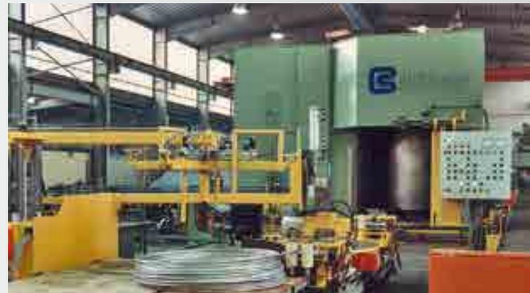
**Trommelziehmaschine mit vertikaler Ziehtrommel, Push-Pointer und Zuführsystem der Ziehangel zur Matrize, für Stahlrohre**
