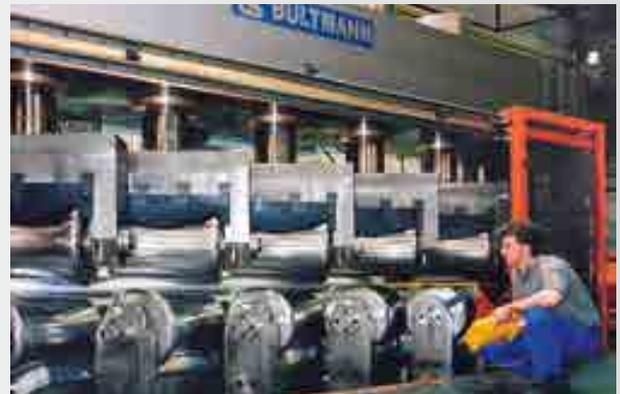
10-Rollen-Richtmaschine für Aluminiumgroßrohre
