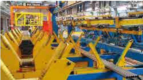
Bündel- und Abbindeanlage für Stahlrohre
