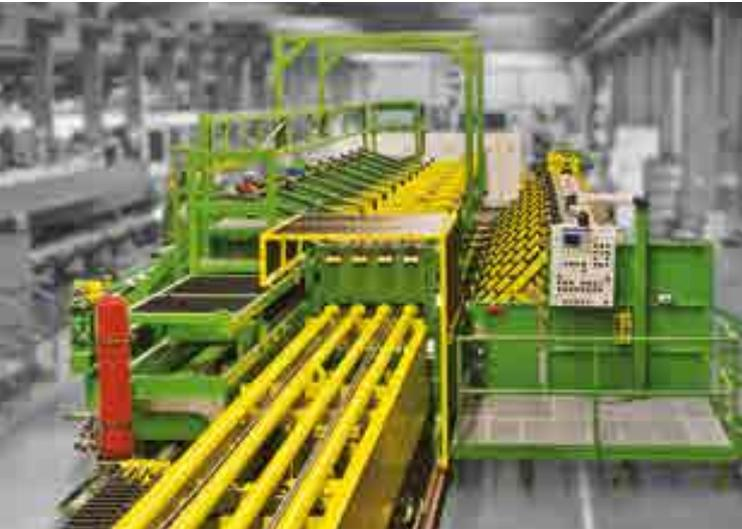
4-fach-Rohrziehanlage für Stahlrohre, mit Kettenantrieb, Anspitzanlage und Spanlostrennanlage
