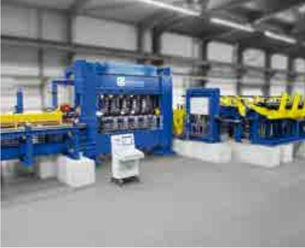
10-Rollen-Richtmaschine für Präzisionsstahlrohre
