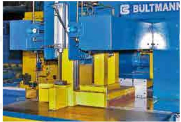
Lagensäge im Auslauf einer Presse für Aluminiumrohre
