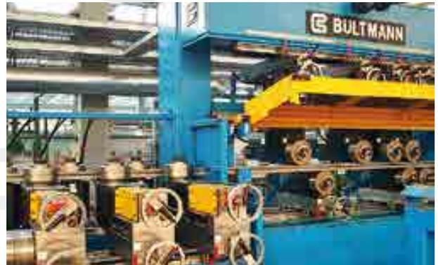
Richtmaschine für Quadrat- und Rechteckrohre mit
