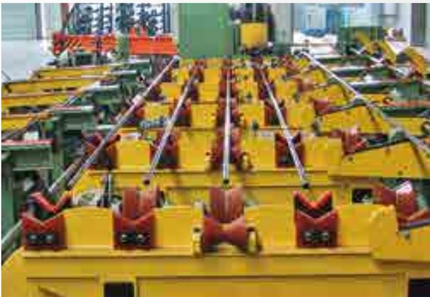
Fasanlage für Stahlrohre
