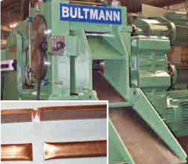
Schrotthacker für kupferlegierte Rohre und Stangen
