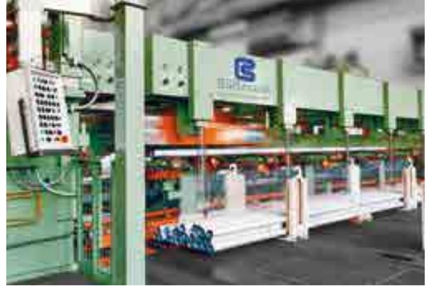
**2-fach-Rohrziehanlage für Aluminiumrohre, mit Vakuumhandling**
