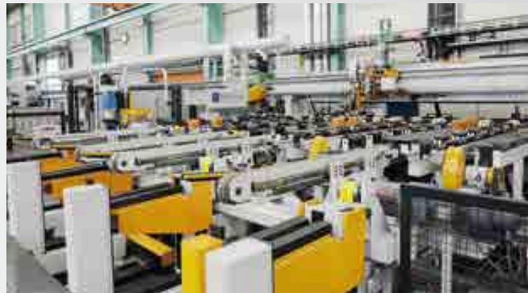
**Sägeanlage mit Spezial-Vorschubsystem für Kupferrohre und -stangen**
