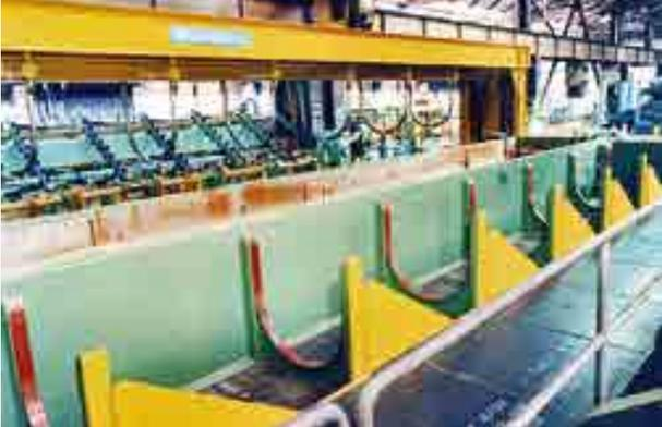
Rohrbundbefettungsanlage für Stahlrohre
