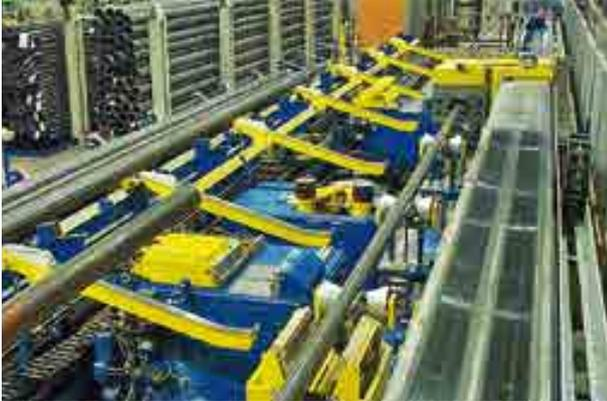
1-fach-Rohrziehanlage für Stahlrohre, mit Zahnstangenantrieb und Sägeanlage
