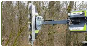
Grensåg LRS monterad, extrautrustad med motvikt.
