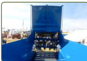
Dubbelverkande hydraulisk giljotindörr
