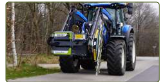
Trafiksäkerhet - Vid transport faller man ihop PUMA 2803, så bredden minskar.
