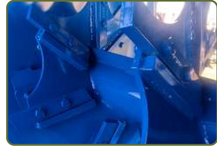
Valsarna skyddas av smatterkoppling
