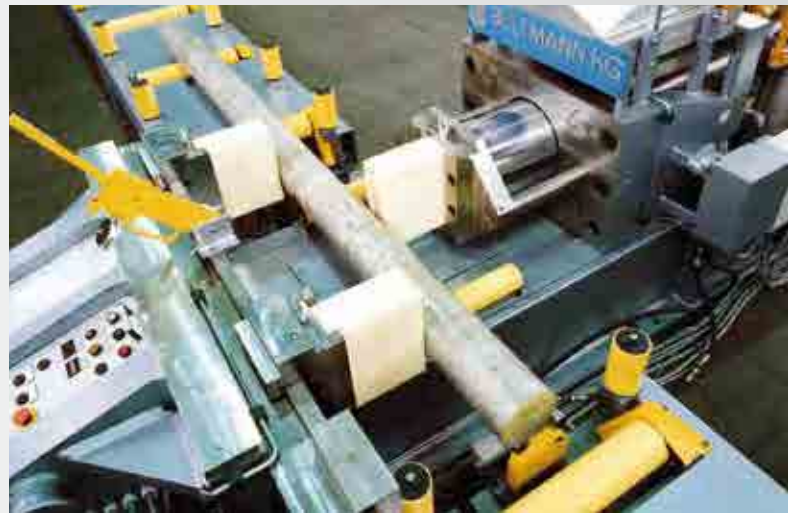
3000 kN Richtpresse für Aluminiumstangen und -profile 3000 kN straightening press for aluminium bars and profiles
