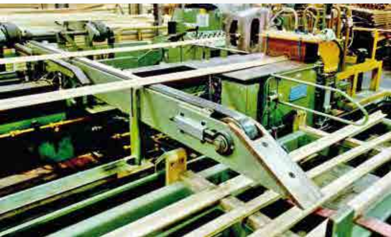
Reckanlage mit Entdrallkopf für Messingstangen und -profile Stretching line with detwisting device for brass bars and profiles
