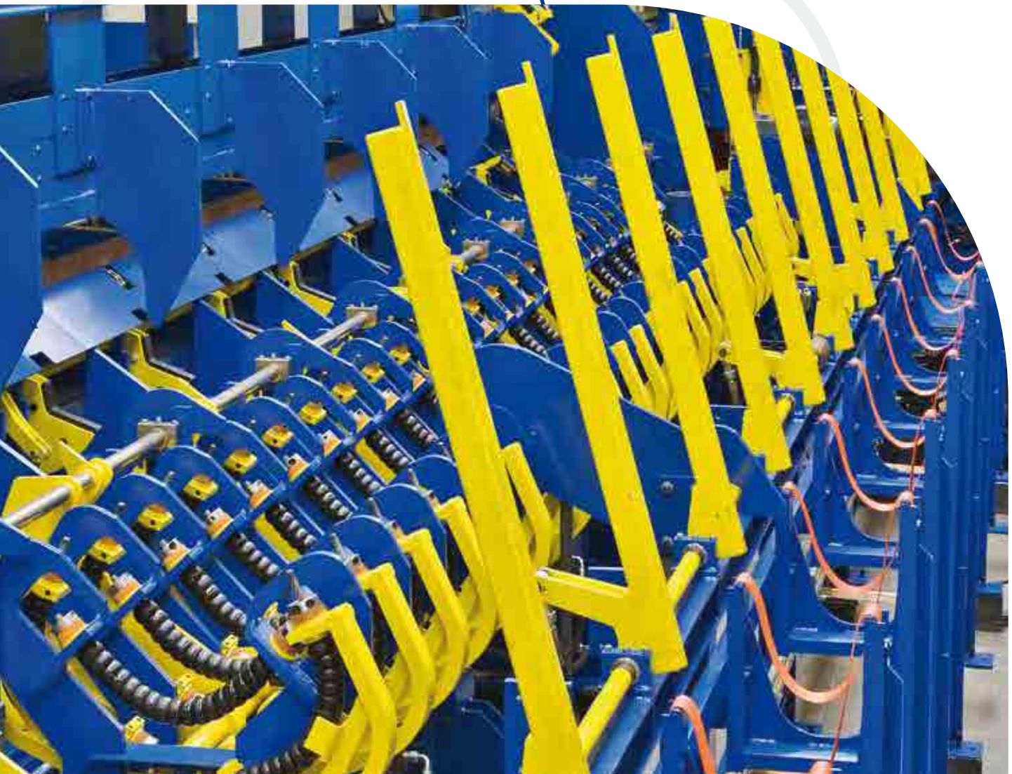
Vereinzelung / Einlaufbahn für Stahlstangen Separation system / entry roller path for steel bars
