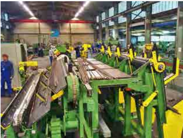
Stangenvereinzelung ab 4 mm Stangendurchmesser für geglühte Stahlstangen
