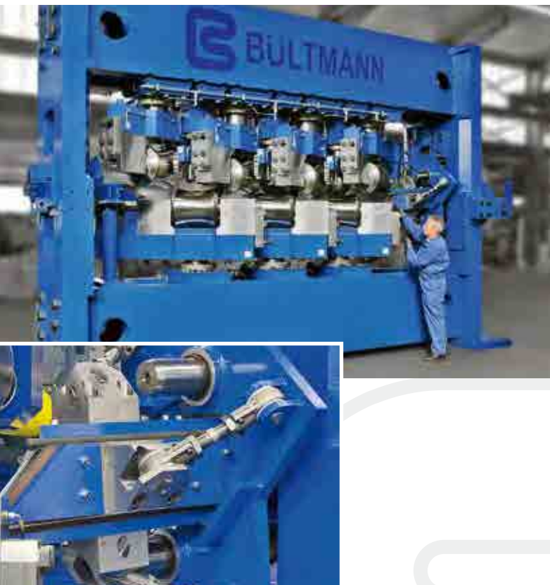
Einstellbare Einlaufführung Adjustable entry guiding
