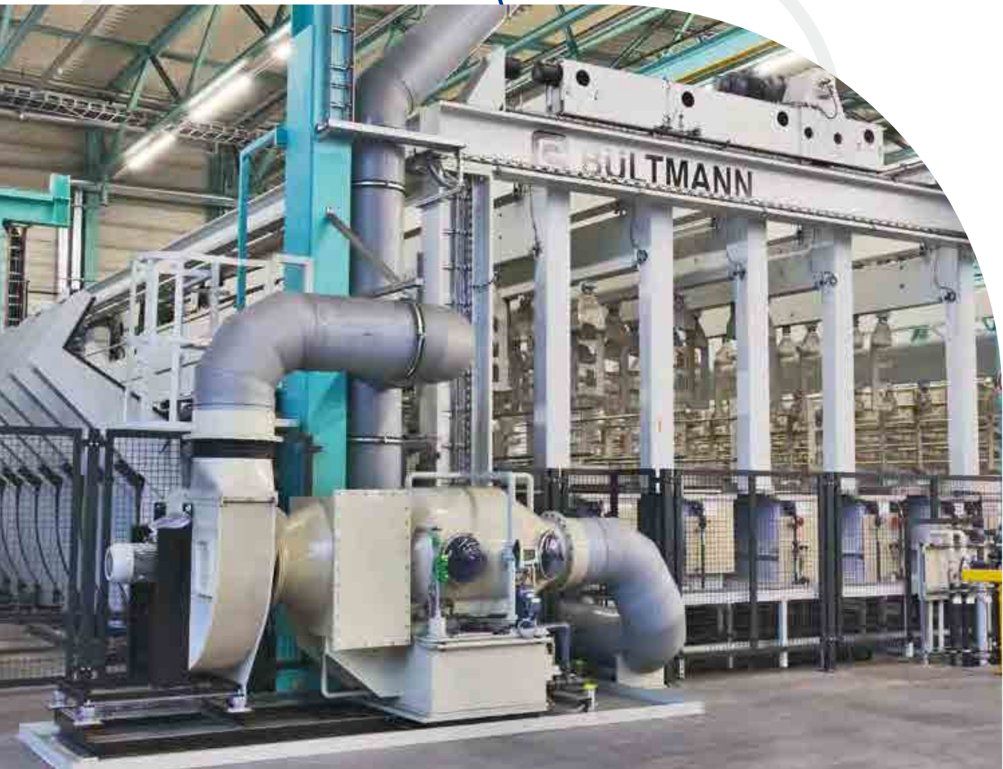
Beisanlage für Messingstangen Pickling equipment for brass bars
