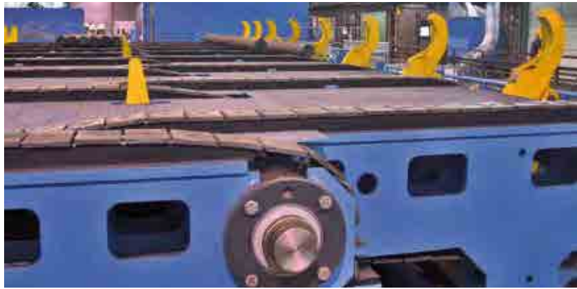
Stangenvereinzelung vor einer Schälmaschine bis Stangendurchmesser 320 mm Bar separation system in front of a peeling machine up to a bar diameter of 320 mm
