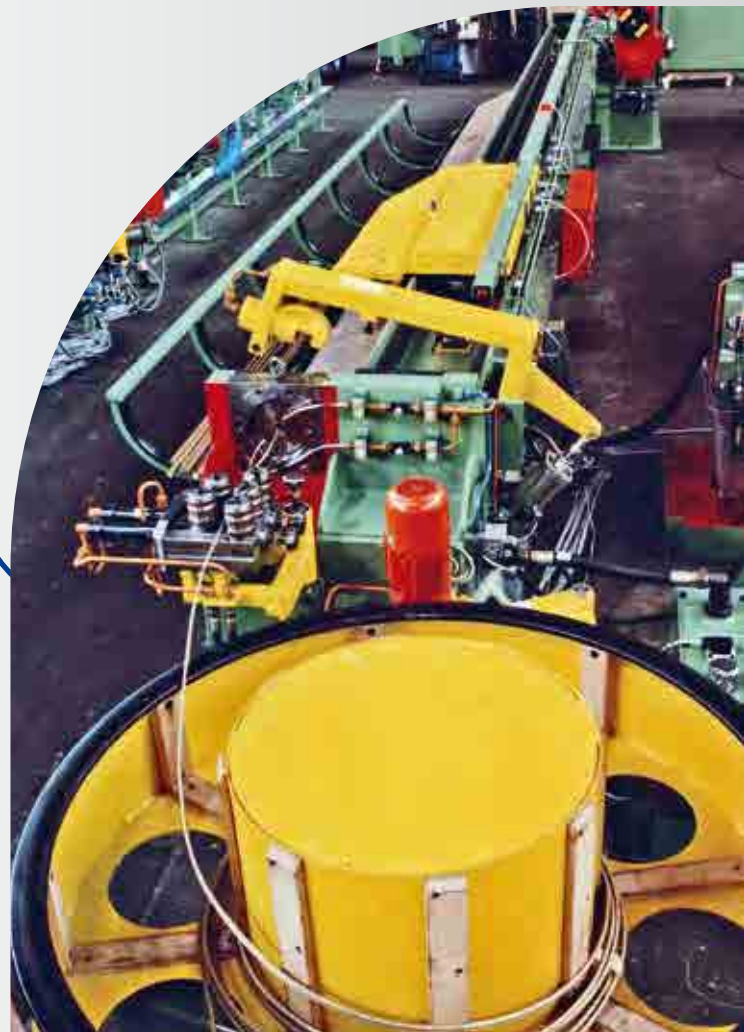
1-fach-Stangenziehanlage für Messingstangen mit Abcoiler, Vorrichtmaschine und Abschervorrichtung Single drawing line for brass bars with uncoiler, pre-straightener and shear-off device
