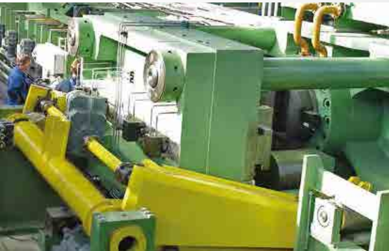
25000 kN Richtpresse für Stahlstangen 25000 kN straightening press for steel bars
