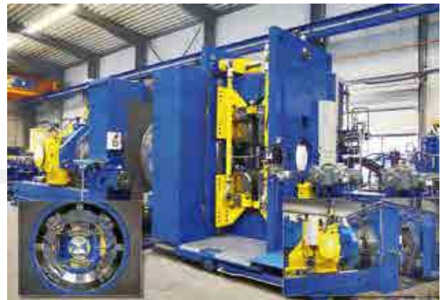
Schälmaschine für Edelstahlstangen bis zu 420 mm Stangendurchmesser
