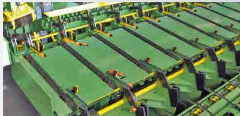
Einlauf für 2-Walzen-Richtmaschine Entry system for a 2-roll straightening machine
