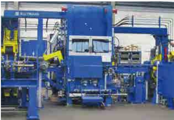
2-Walzen-Richtmaschine für geschälte Stangen 2-roll straightening machine for peeled bars
