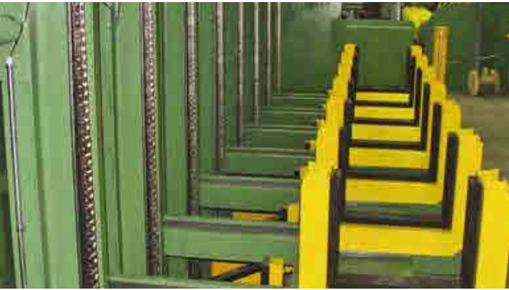
Bundbeladeseite einer Stangenvereinzelung Bundle loading within a bar separation system
