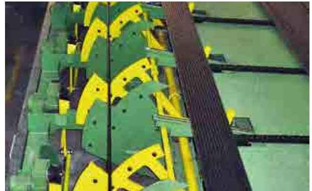
Quertransport zwischen einer Schälmaschine und einer 2-Walzen-Richtmaschine
