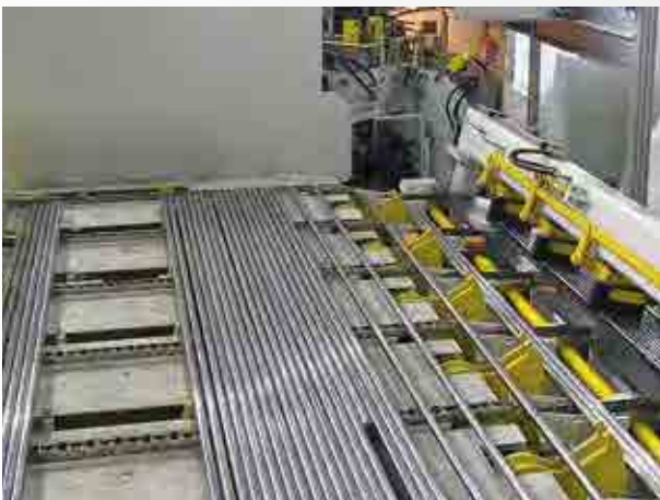
Stangenvereinzelung vor einer Richtmaschine
