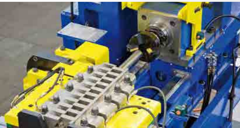
Fasanlage für Stahlstangen Chamfering machine for steel bars
