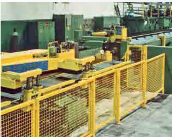
Fertigungsline für Messingstangen und -profile, u.a. bestehend aus 1-fach-Stangenziehmaschine mit Einschubvorrichtung und Rotationsschere, Profilfräsanlage, Richtmaschine und Lagensäge
