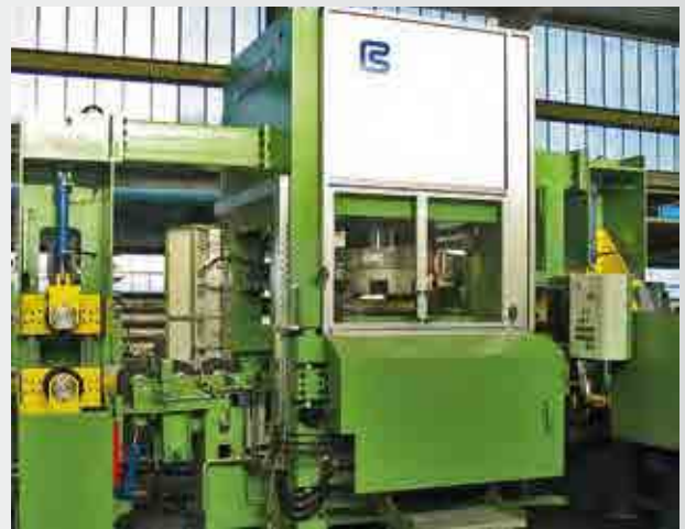
Fertigungsline für Rundstangen aus rostfreiem Stahl, u.a. bestehend aus automatischer Vereinzelung, Vorrichtmaschine, Schälmaschine und Richtpoliermaschine
