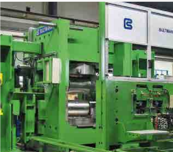
2-Walzen-Richtmaschine für geschälte Stangen 2-roll straightening machine for peeled bars
