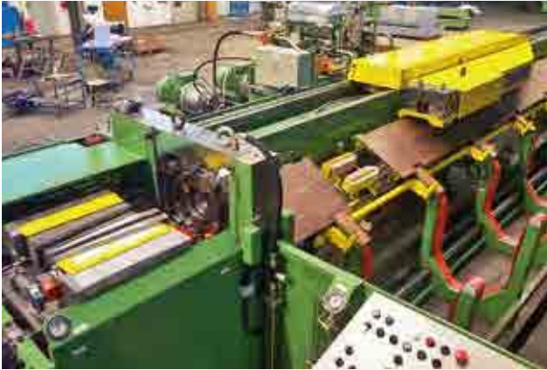
1-fach-Stangenziehanlage für Messingstangen mit Einschubvorrichtung Single drawing line for brass bars with push-in device
