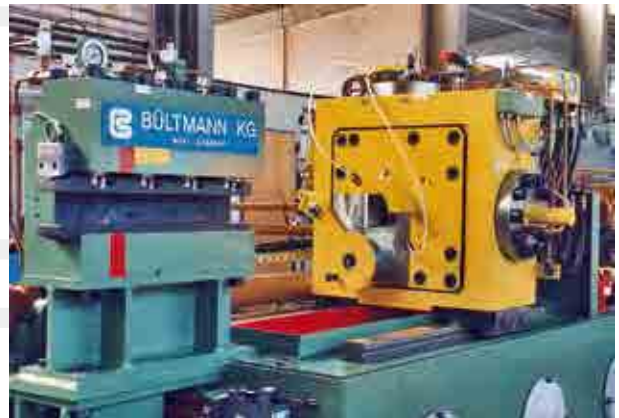
Pull-Pointer für kupferlegierte Stangen und Profile Pull-pointer for copper-alloyed bars and profiles
