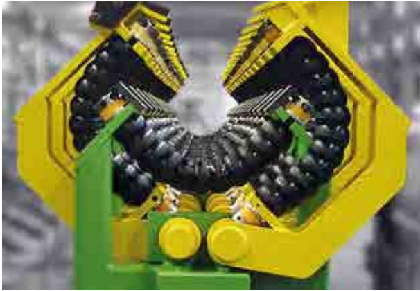
Einlaufbahn für rundes Schwarzmaterial Entry channel for round black bars
