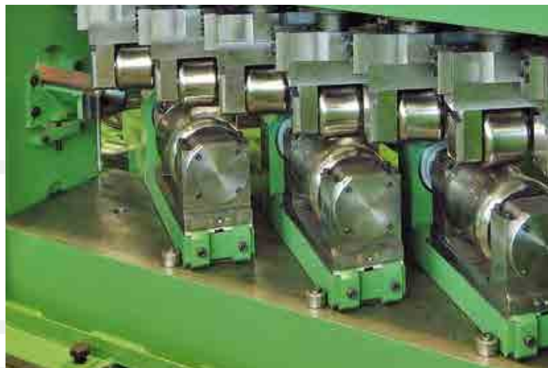
7/3-Rollen-Richtmaschine für Stahlstangen 7/3-roll straightening machine for steel bars
