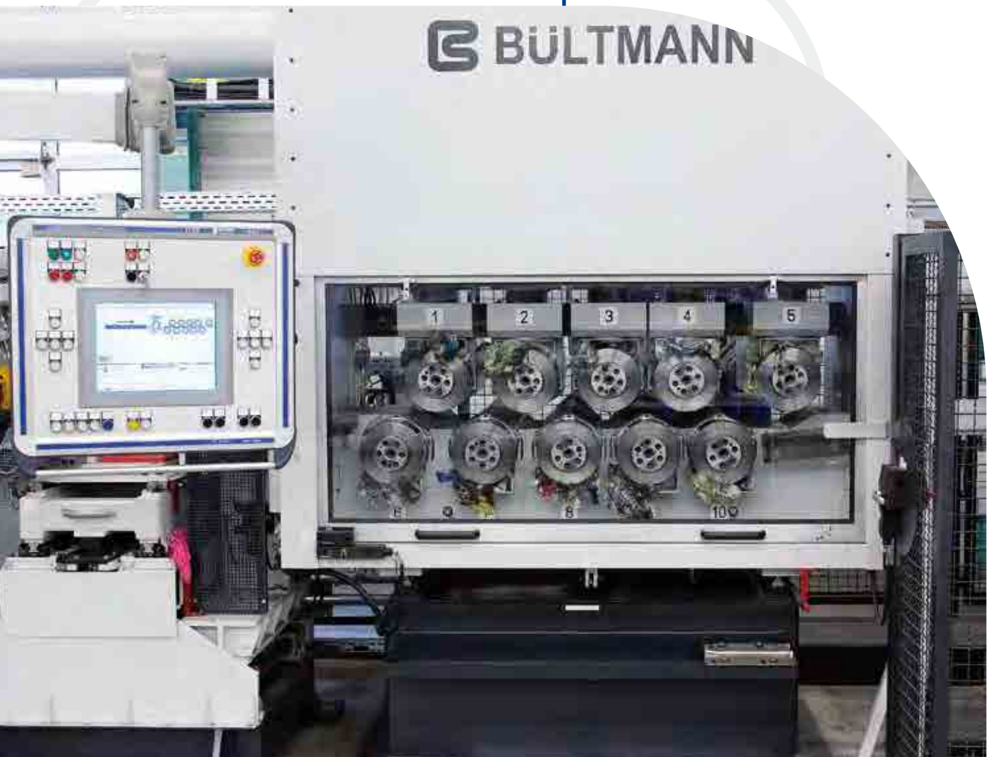
2 x 10-Rollen-Richtmaschine für Messingstangen, mit lagerichtiger Zufuhr der zu richtenden Stangen 2 x 10-roll straightening machine for brass bars, with feeding of bars in correct position
