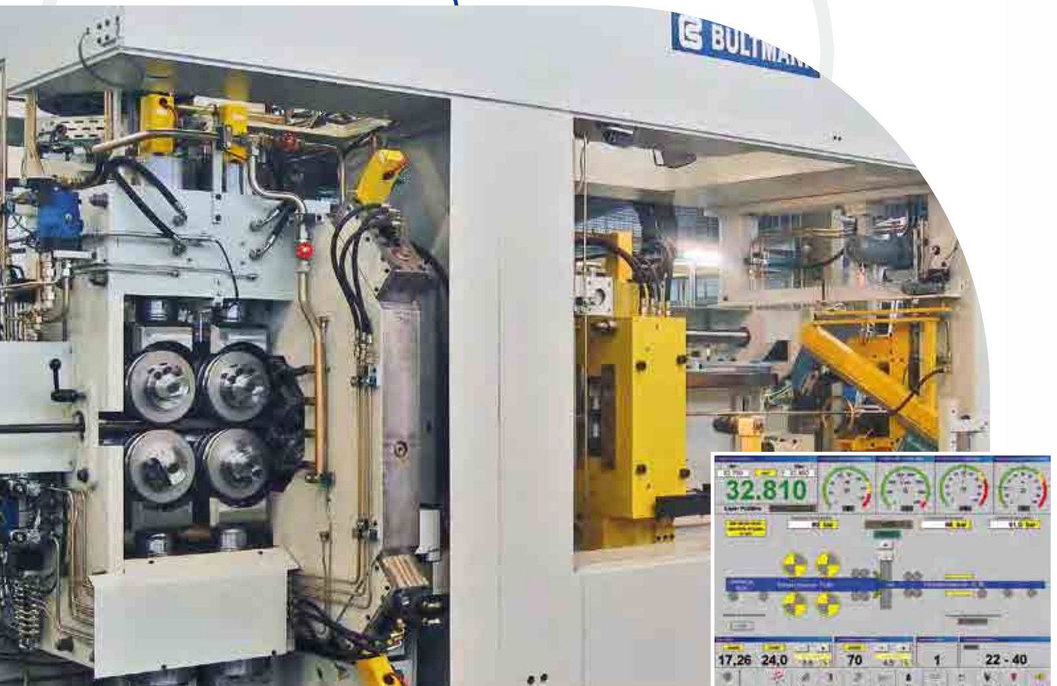
Schälmaschine für Edelstahlstangen Peeling machine for special steel bars
