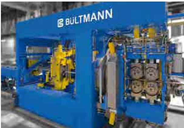
Schälmaschine für Edelstahlstangen bis zu 130 mm Stangendurchmesser
