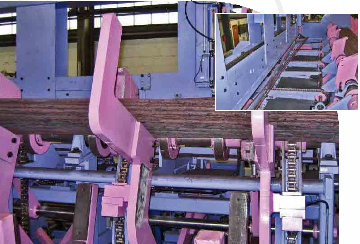
Stangenvereinzelung vor einer Richtmaschine für schwarze Rundstangen Separation system in front of a straightening machine for round black bars
