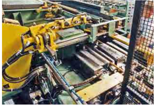
2-fach-Einschubvorrichtung in einer 2-fach-Stangen- und Profilziehmaschine für Messingstangen Double push-in device within a double drawing machine for brass bars and profiles
