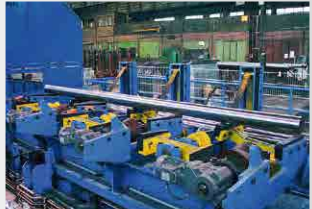
Geschälte Edelstahlstange im Auslauf einer Schälmaschine Peeled special steel bar at the exit side of a peeling machine
