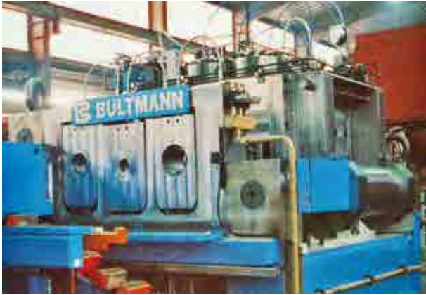
3-fach-Einschubvorrichtung für Rund-, Sechskant- und Vierkantstangen aus Edelstahl Triple push-in device for rounds, hexagons and squares made from special steel
