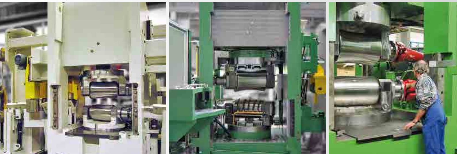
2-Walzen-Richtmaschinen für Stahlstangen 2-roll straightening machines for steel bars
