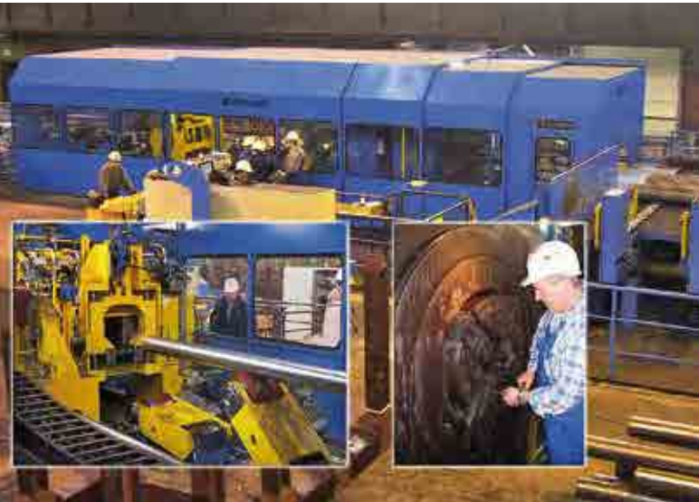
Schälmaschine für Edelstahlstangen Peeling machine for special steel bars
