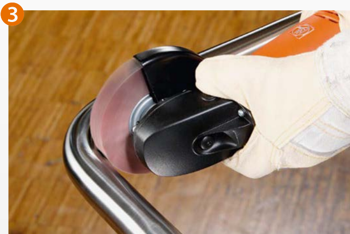
3 Et lamelslibehjul sørger for en satinagtig slibning.
