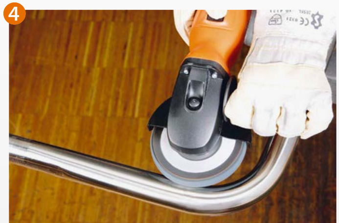
4 En efterbehandlingsslibeskeive sørger for et perfekt overfladeresultat.
