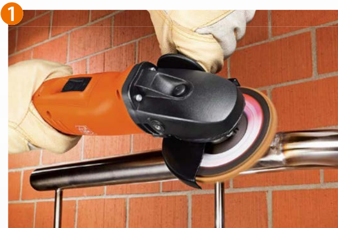
1 Svejseømme fjernes rationelt ved rotationsprocessen med en elastisk vifteskive.
