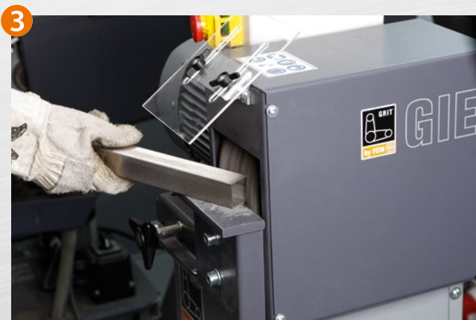
Effektiv afgratning med en afgratningsmaskine med børster i rustfrit stål.
