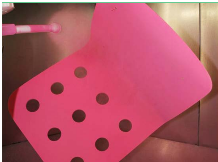
En stol fremstillet i varmfølsomt MDF bliver malet med Teknos' pulvermaling INFRALIT EP/PE 8241-00 med lav hærdningstemperatur til indendørs brug.
